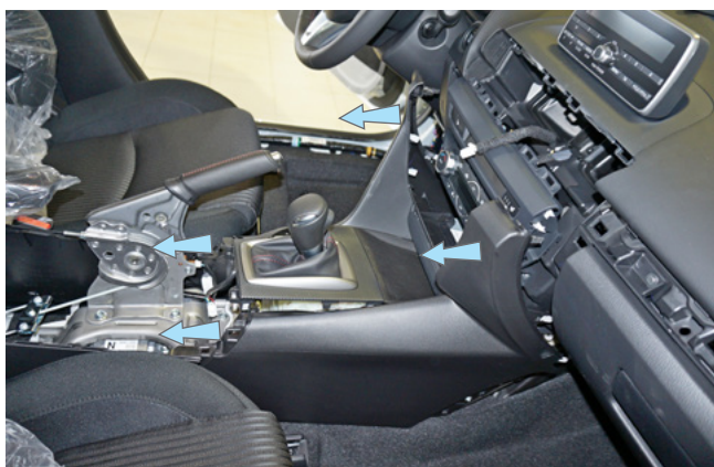
Фото 1.18. Снять центральный тоннель
