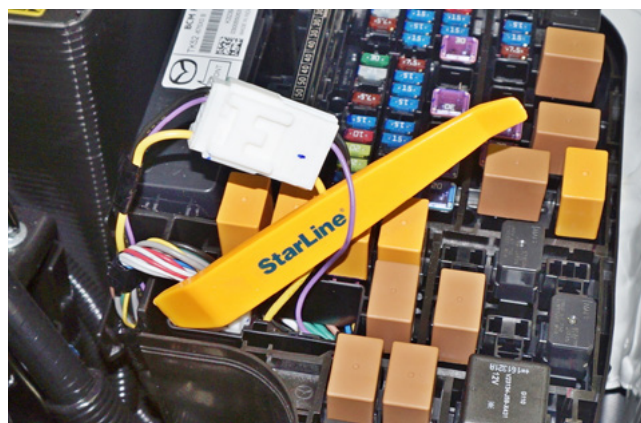
Фото 2.10. Подключение цепи зажигания (фиолетовый)
