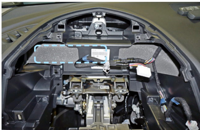
Фото 2.12. Пример расположения центрального блока охранно-телематического комплекса
