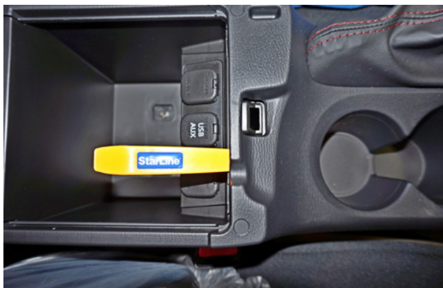
Фото 1.6. Снять накладку средней части тоннеля
