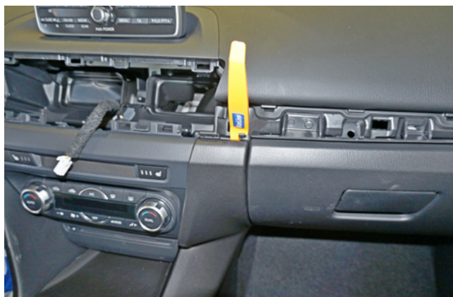
Фото 1.17. Снять центральный тоннель
