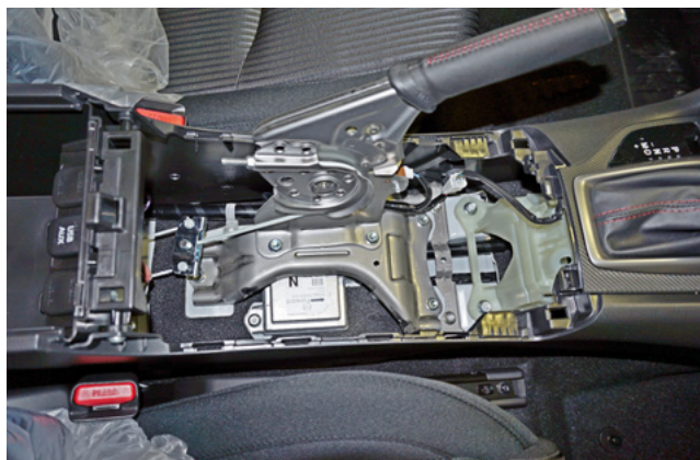
Фото 1.7. Накладка средней части тоннеля снята
