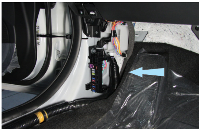
Фото 3.4. Местоположение жгута в левой кик-панели
