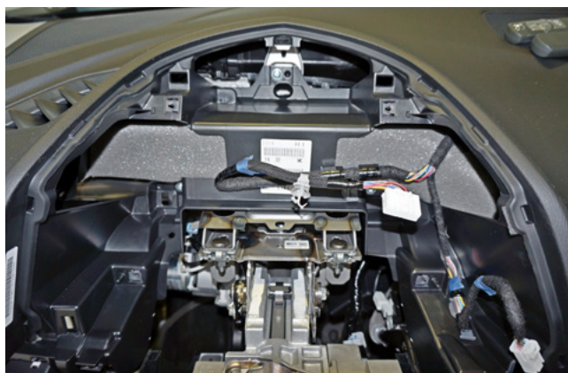
Фото 1.25. Панель приборов снята
