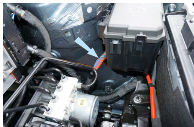
Фото 3.13. Местоположение жгута проводов
