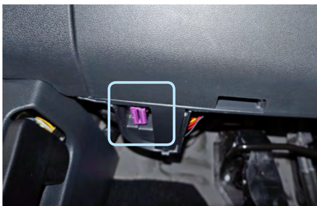
Фото 3.4. Местоположение разъёма OBD-II
