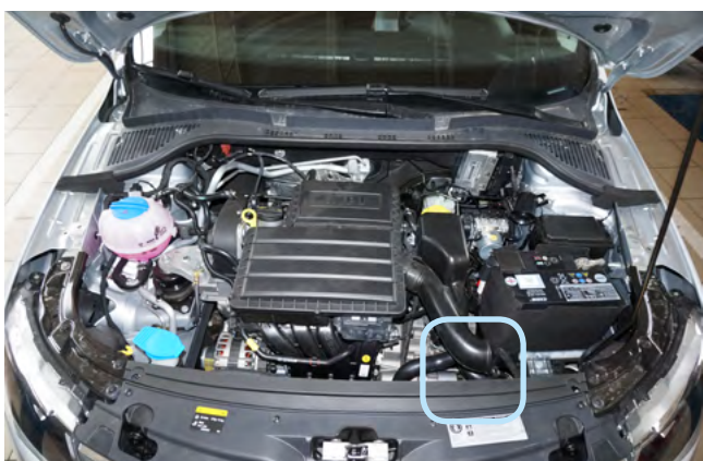
Фото 2.5. Место установки датчика температуры двигателя
