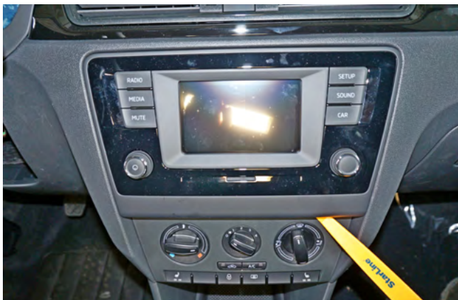
Фото 1.5. Снять декоративную накладку
