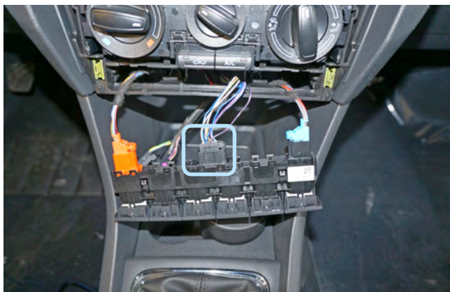
Фото 3.8. Расположение разъёма на блоке кнопок
