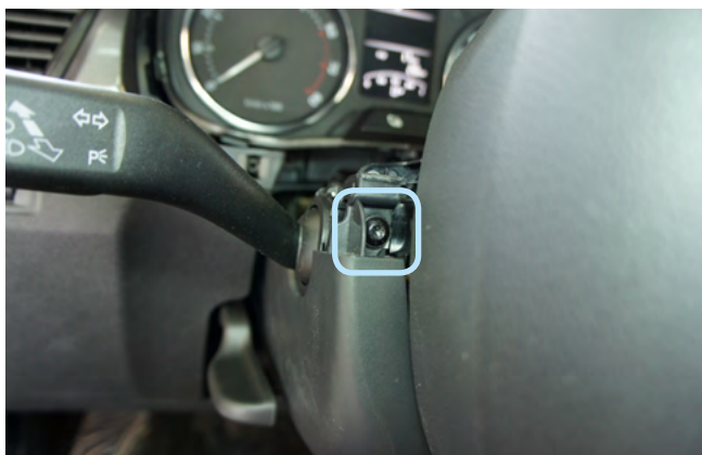
Фото 1.3. Винт крепления нижней части кожуха
