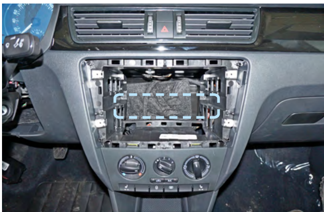
Фото 2.8. Пример расположения центрального блока охранно-телематического комплекса
