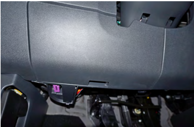
Фото 1.12. Крышка монтажного блока предохранителей
