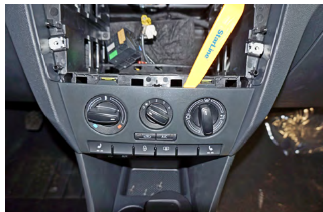
Фото 1.8. Снять декоративную накладку блока управления климат-контролем
