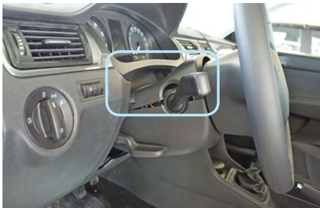
Фото 1.1. Верхняя часть кожуха рулевого вала
