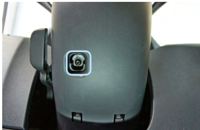
Фото 1.2. Винт крепления нижней части кожуха
