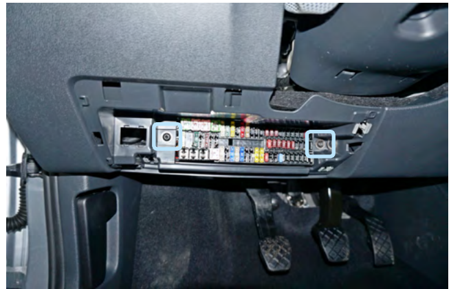
Фото 1.13. Винты крепления блока предохранителей
