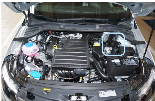
Фото 2.3. Возможное место установки сирены
