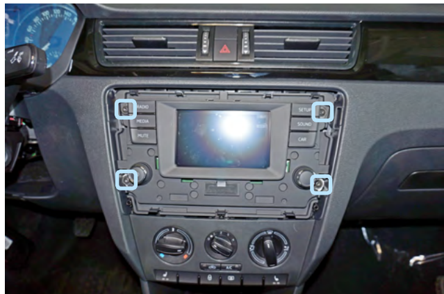
Фото 1.6. Декоративная накладка снята. Саморезы
