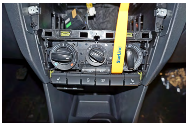
Фото 1.10. Снять блок кнопок
