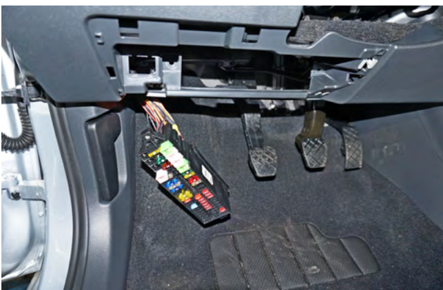
Фото 1.14. Монтажный блок предохранителей снят
