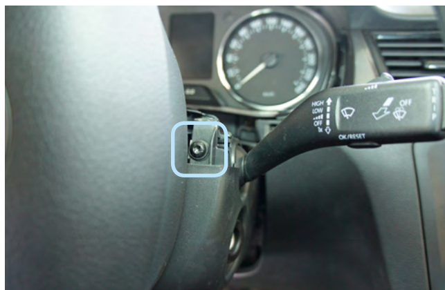
Фото 1.4. Винт крепления нижней части кожуха
