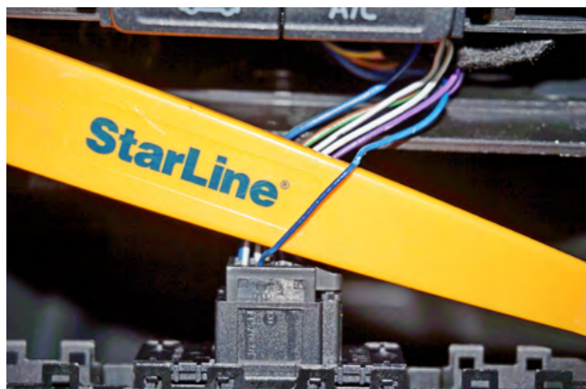
Фото 3.9. Альтернативное управление центральным замком (синий)
