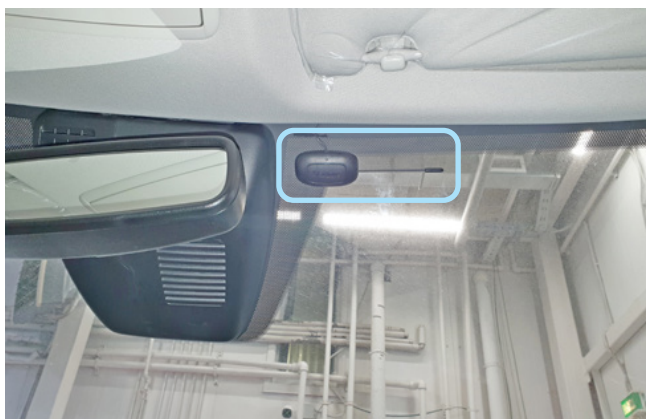
Фото 2.1. Возможное место установки антенного модуля
