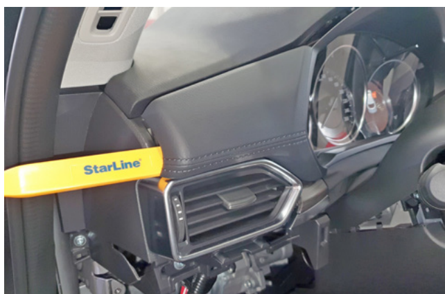
Фото 1.15. Снять декоративную накладку панели приборов
