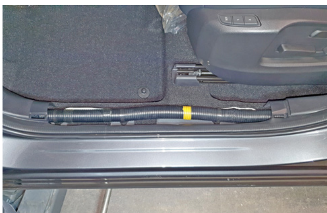
Фото 1.3. Накладка порога двери водителя снята
