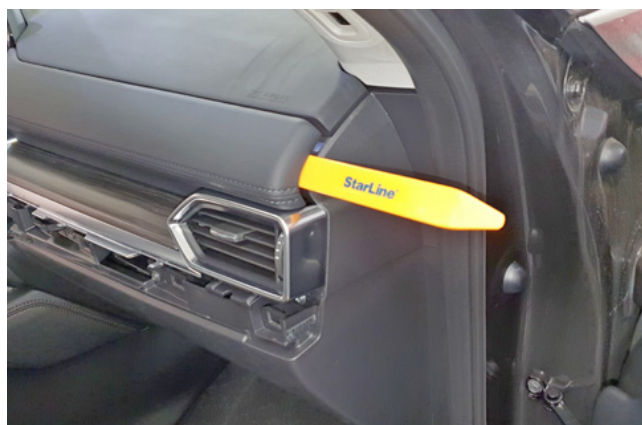
Фото 1.13. Снять продольную накладку передней панели
