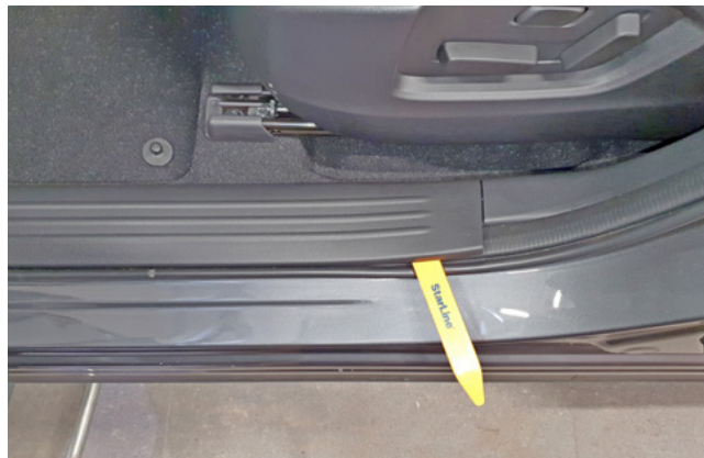
Фото 1.2. Снять накладку порога двери водителя
