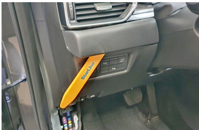
Фото 1.7. Снять накладку слева от рулевой колонки
