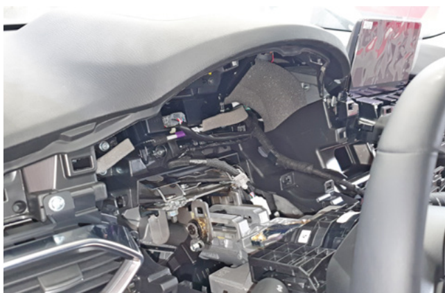
Фото 1.17. Панель приборов снята
