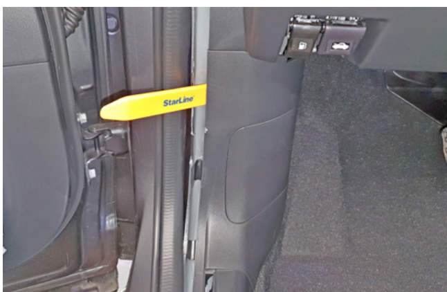
Фото 1.5. Снять накладку левой кик-панели
