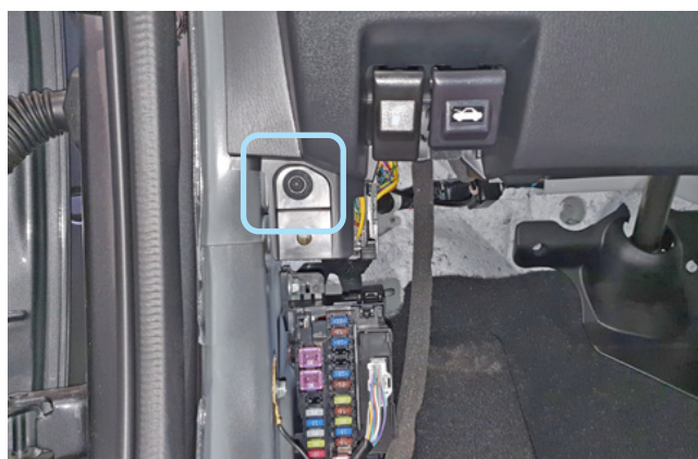
Фото 1.6. Болт крепления накладки под рулевой колонкой
