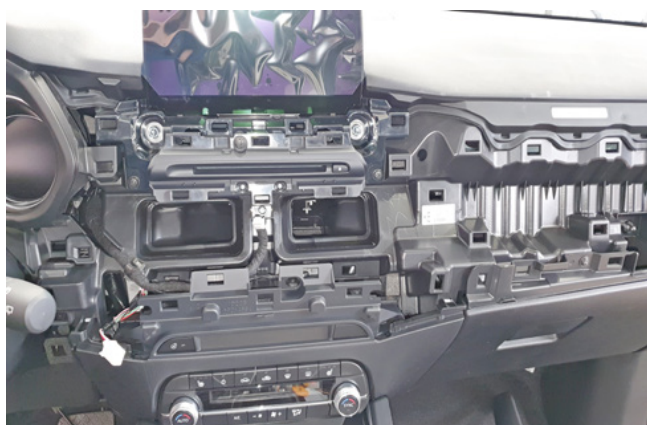
Фото 1.14. Продольная накладка передней панели снята
