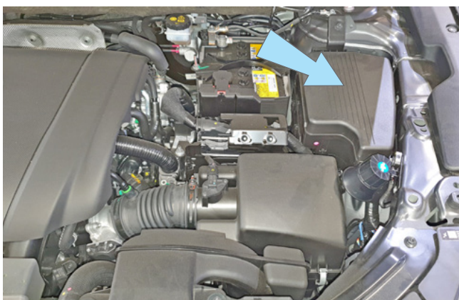
Фото 2.8. Возможное место установки подкапотного блока R6
