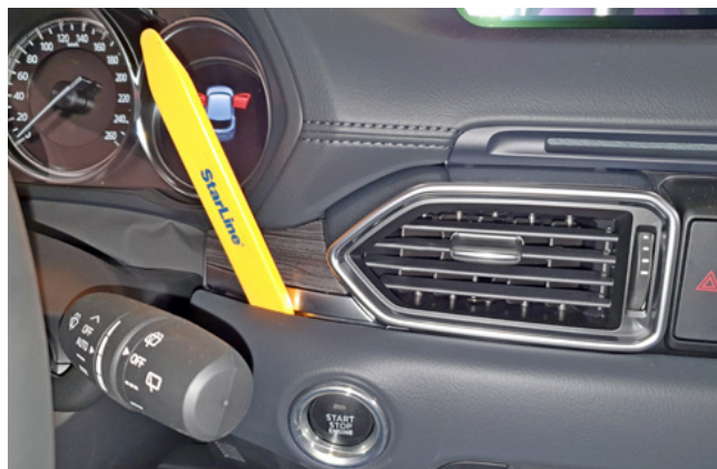
Фото 1.8. Снять накладку справа от рулевой колонки
