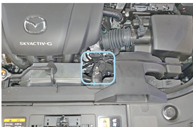
Фото 2.4. Место установки датчика температуры двигателя
