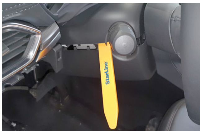
Фото 1.11. Снять верхнюю часть кожуха рулевого вала
