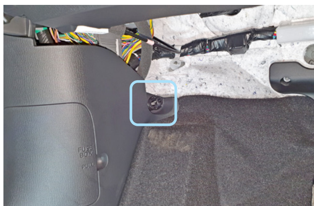
Фото 1.4. Клипса крепления накладки левой кик-панели
