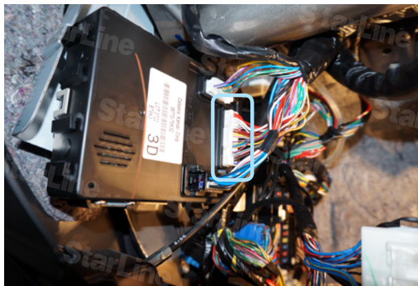
Фото 10.1. Местоположение разъёма на блоке BCM
