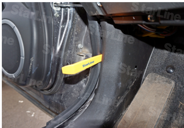
Фото 1.2. Снять пластиковую накладку кик-панели
