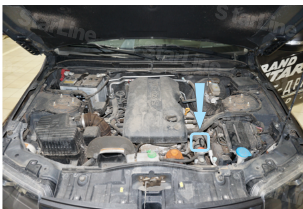
Фото 6.3. Место установки датчика температуры двигателя
