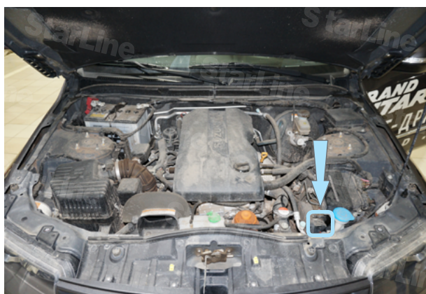
Фото 6.1. Возможное место установки сирены
