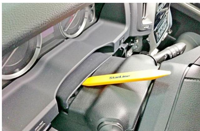
Фото 1.15. Снять пылезащитный чехол
