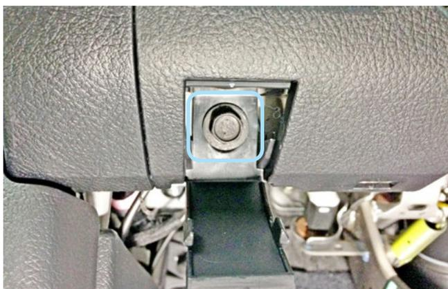
Фото 1.9. Болт крепления накладки под рулевой колонкой слева
