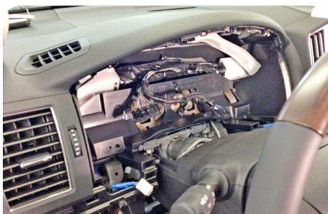
Фото 1.18. Панель приборов снята
