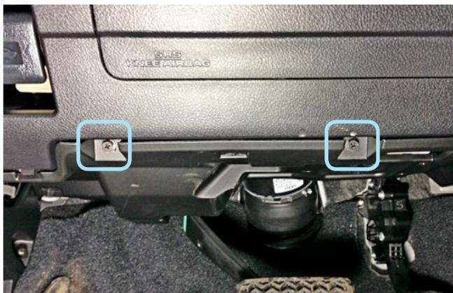
Фото 1.5. Саморезы крепления накладки педального узла.
