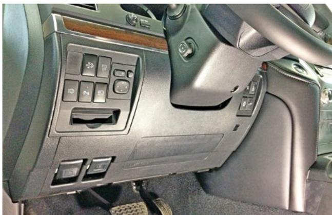
Фото 1.1. Накладка под рулевой колонкой. Общий вид
