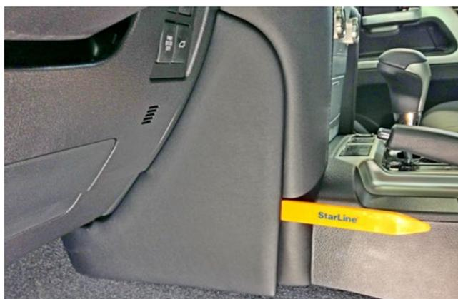
Фото 1.2. Снять левую боковую накладку центральной консоли
