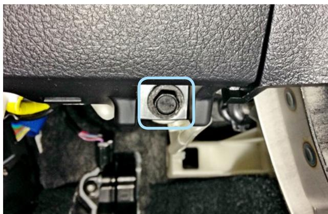
Фото 1.10. Болт крепления накладки под рулевой колонкой справа
