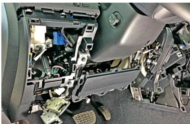
Фото 1.13. Накладка под рулевой колонкой и блок кнопок сняты
