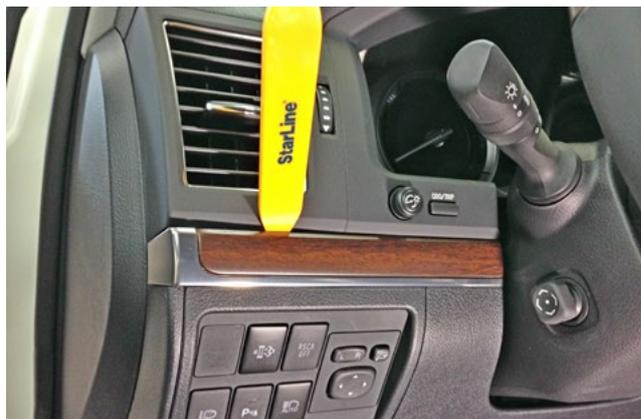
Фото 1.6. Снять декоративную накладку слева от рулевой колонки
