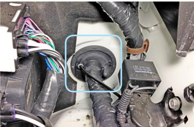
Фото 2.5. Штатный уплотнитель. Вид со стороны капота
