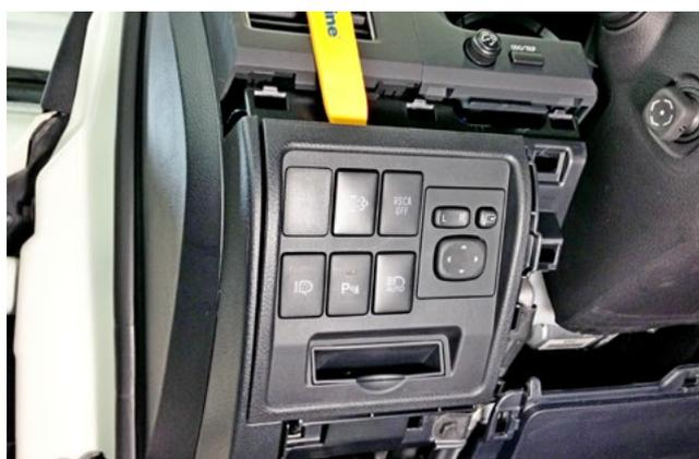
Фото 1.12. Снять блок кнопок
