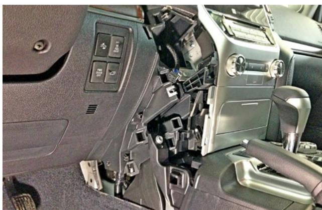
Фото 1.4. Декоративная накладка с кнопкой Старт-Стоп снята
