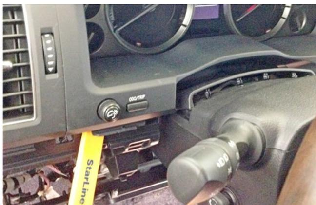
Фото 1.16. Снять декоративную накладку панели приборов
