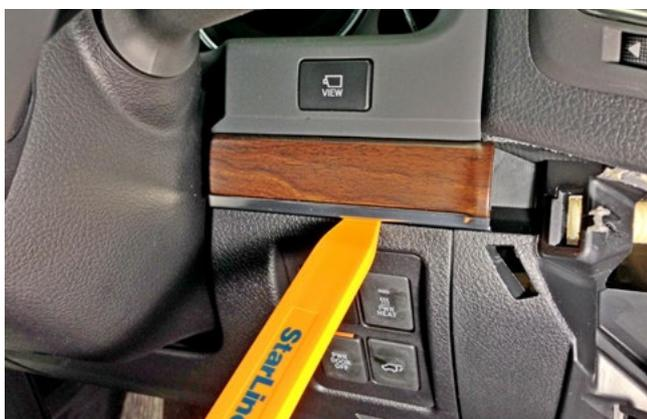
Фото 1.7. Снять декоративную накладку справа от рулевой колонки
