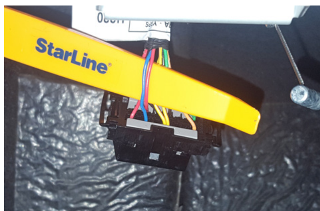
Фото 3.5. CAN-шина (красный и синий)
