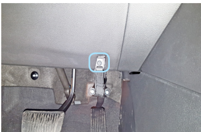
Фото 1.9. Саморез крепления пластиковой накладке под декоративной заглушкой
