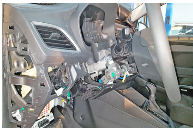
Фото 1.16. Кожух рулевого вала снят
