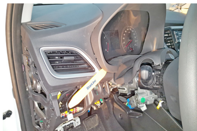
Фото 1.18. Снять накладку панели приборов
