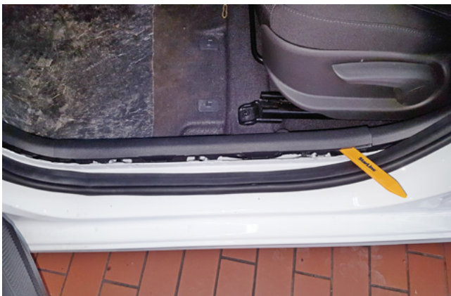
Фото 1.3. Снять накладку порога двери водителя
