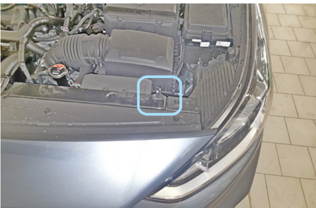
Фото 2.7. Возможное место установки концевика капота
