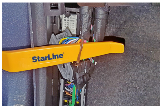
Фото 3.7. Концевик двери водителя (коричневый)
