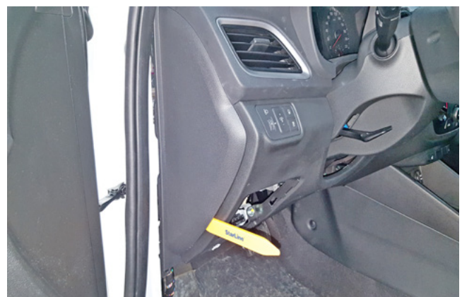
Фото 1.6. Снять левую боковую накладку передней панели
