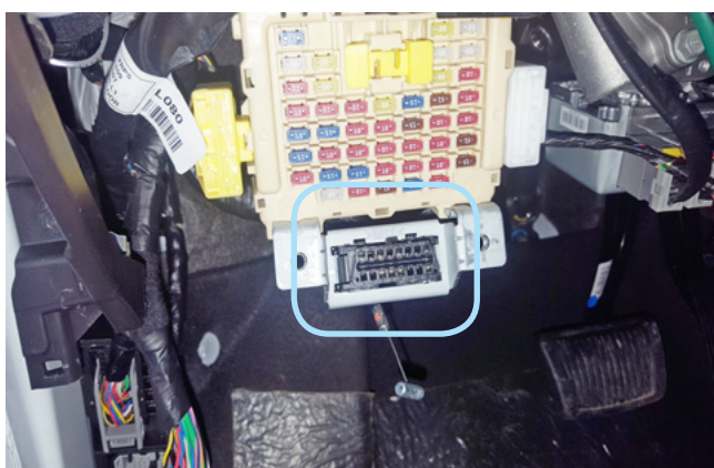
Фото 3.4. Местоположение диагностического разъёма
