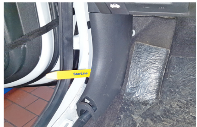
Фото 1.4. Снять накладку левой кик-панели
