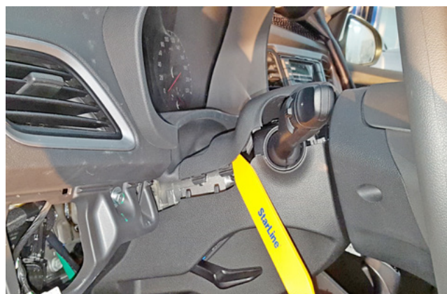
Фото 1.12. Снять верхнюю часть кожуха рулевого вала
