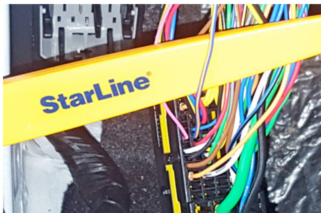
Фото 3.9. Шина данных штатного иммобилайзера (сине-оранжевый)
