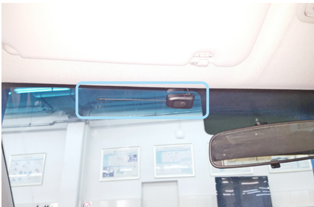
Фото 2.1. Возможное место установки антенного модуля
