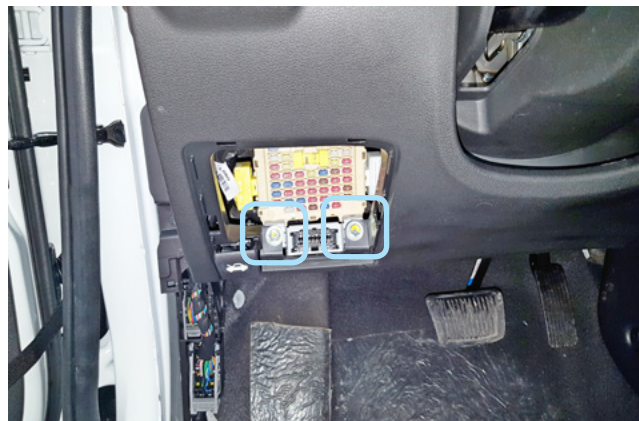
Фото 1.8. Болты крепления пластиковой накладке под рулевой колонкой
