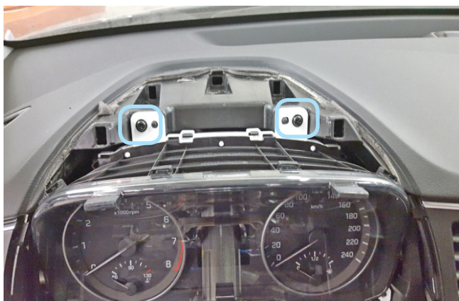
Фото 1.25. Саморезы крепления панели приборов
