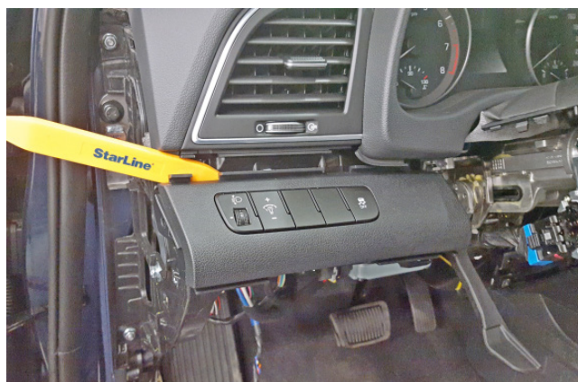
Фото 1.20. Накладка снята. Снять блок кнопок управления
