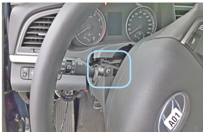
Фото 1.13. Саморез крепления нижней части кожану рулевого вала слева
