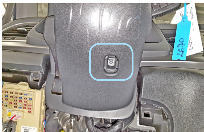
Фото 1.15. Саморез крепления нижней части кожану рулевого вала снизу
