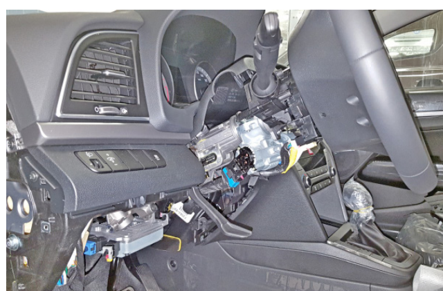
Фото 1.16. Кожух рулевого вала снят
