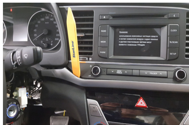
Фото 1.22. Снять продольную декоративную накладку передней панели
