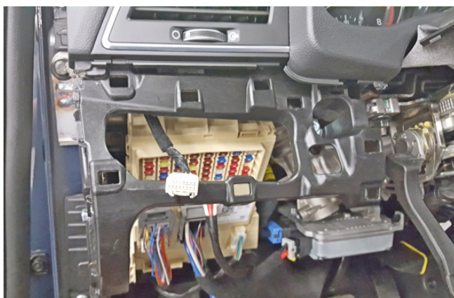
Фото 1.21. Блок кнопок управления снят
