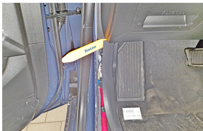
Фото 1.5. Снять накладку левой кик-панели
