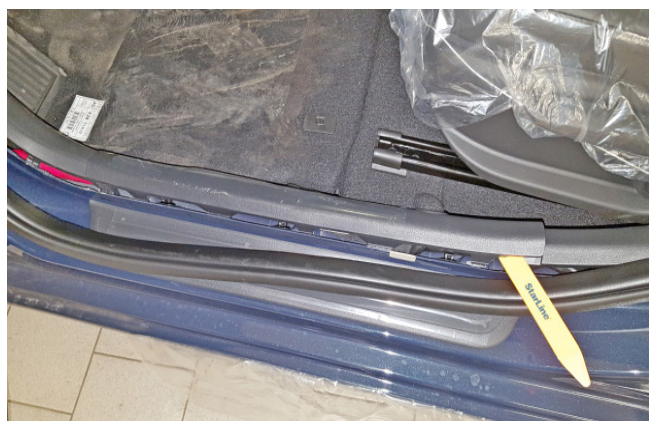
Фото 1.3. Снять накладку порога двери водителя
