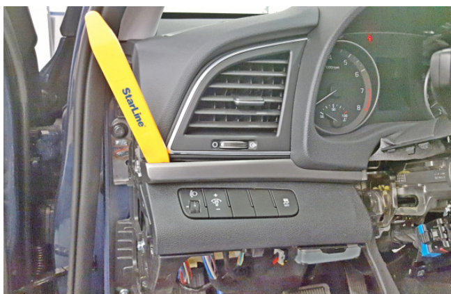
Фото 1.19. Снять декоративную накладку
