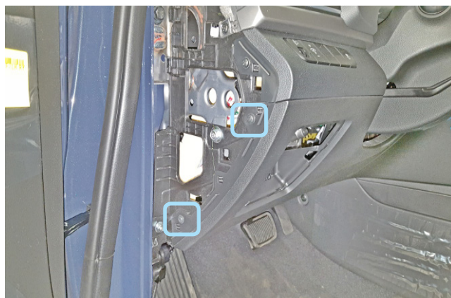
Фото 1.8. Накладка снята. Саморезы
