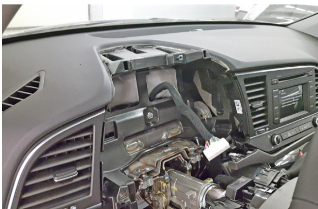
Фото 1.27. Панель приборов снята
