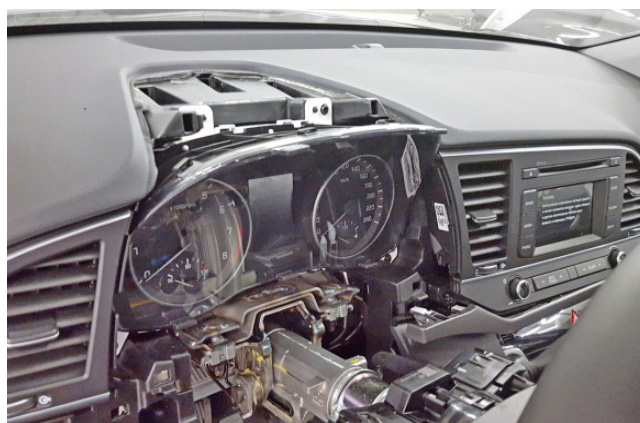
Фото 1.24. Накладка панели приборов снята
