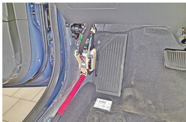
Фото 1.6. Накладка левой кик-панели снята
