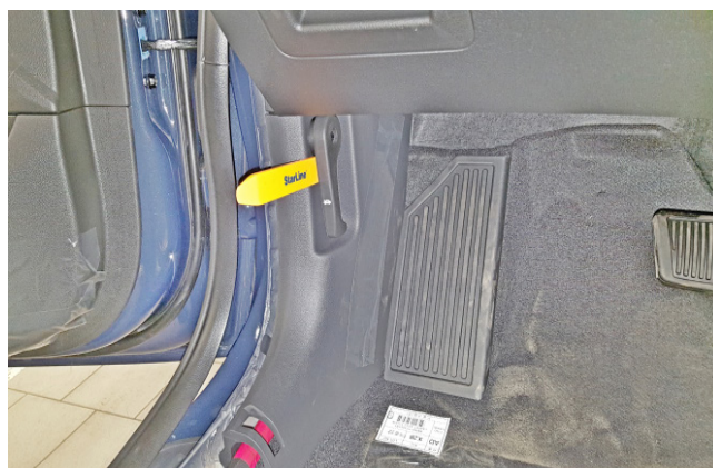
Фото 1.4. Снять ручку отпирания капота
