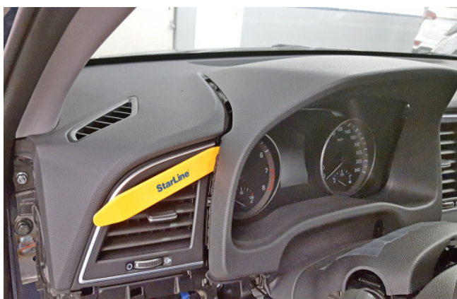
Фото 1.23. Снять накладку панели приборов
