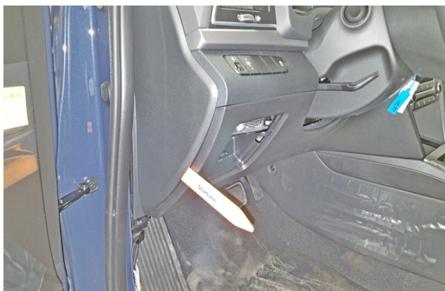
Фото 1.7. Снять боковую накладку передней панели
