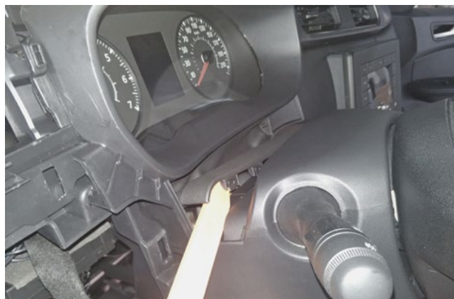
Фото 1.8. Снять пылезащитный кожух рулевой колонки
