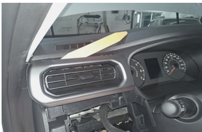
Фото 1.5. Снять воздуховод слева от рулевой колонки
