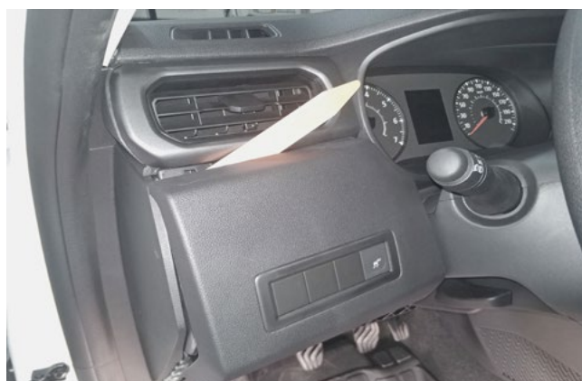
Фото 1.4. Снять панель слева от рулевой колонки
