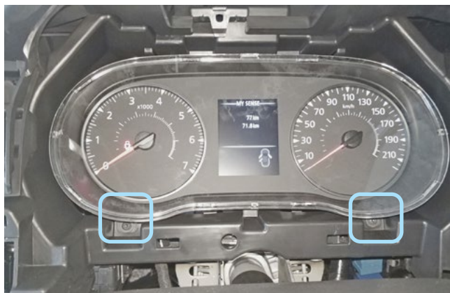
Фото 1.11. Накладка панели приборов снята. Саморезы
