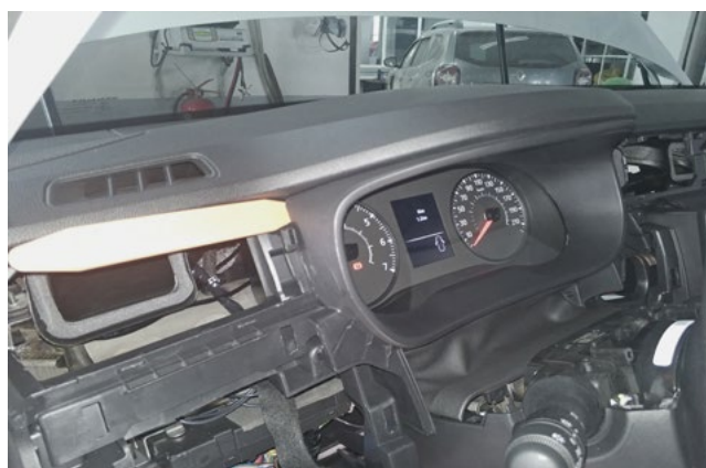
Фото 1.10. Снять накладку панели приборов
