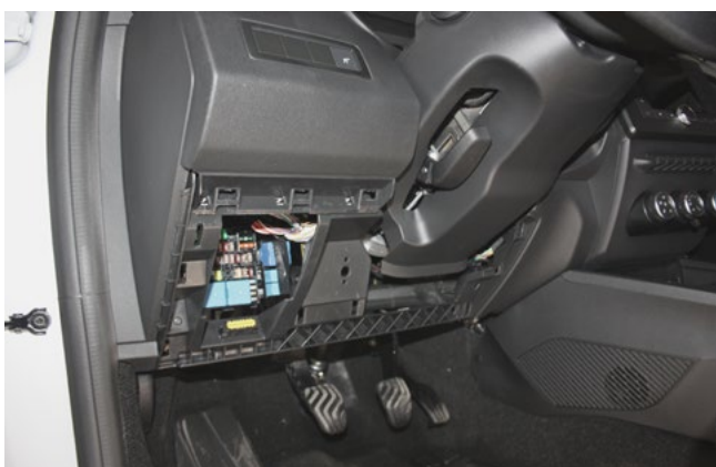
Фото 1.3. Пластиковая накладка снята
