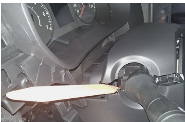
Фото 1.9. Снять верхний кожух рулевой колонки
