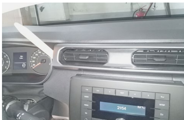
Фото 1.6. Снять воздуховод справа от рулевой колонки
