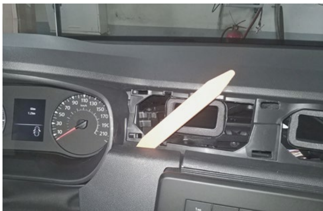
Фото 1.7. Снять панель справа от рулевой колонки
