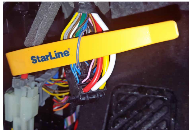
Фото 12.2. Шина данных штатного иммобилайзера (сине-оранжевый)
