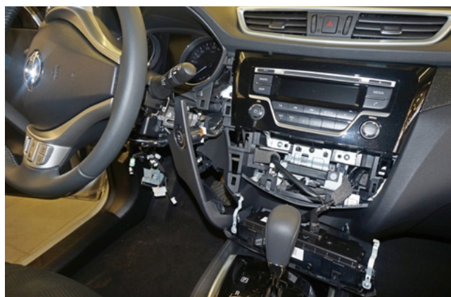
Фото 1.13. Пластиковая накладка снята
