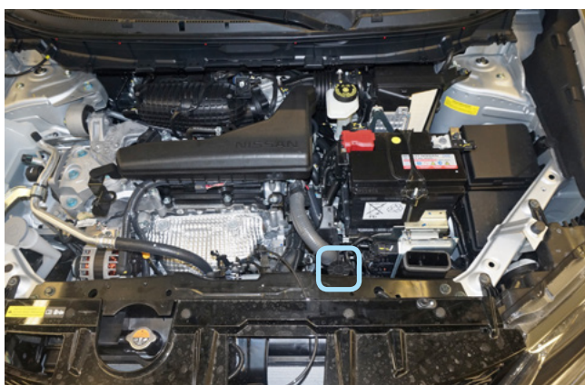
Фото 2.3. Возможное место установки сирены
