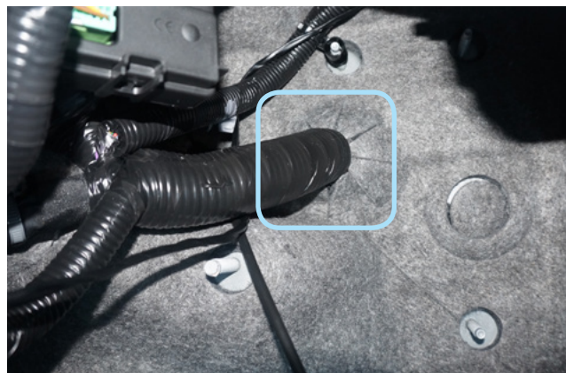
Фото 2.8. Штатный уплотнитель. Вид со стороны салона
