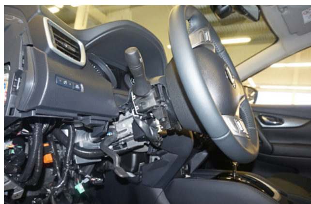
Фото 1.9. Нижняя часть кожуха рулевого вала снята
