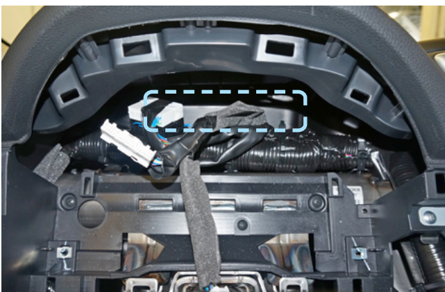
Фото 2.13. Пример расположения центрального блока охранно-телематического комплекса
