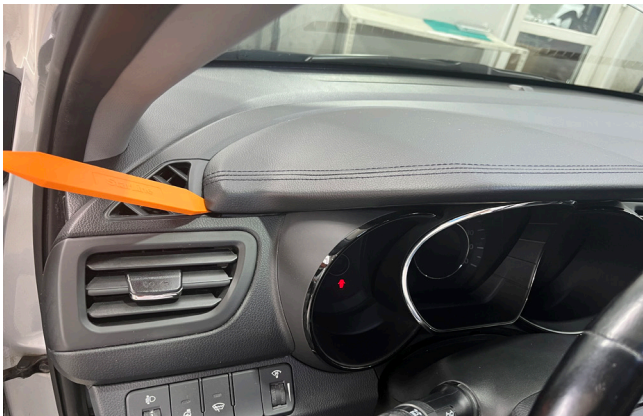
Фото 1.12. Снять декоративную накладку панели приборов
