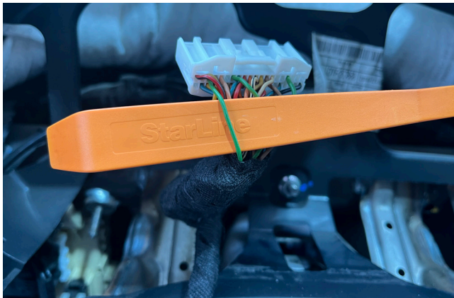
Фото 3.9. Концевик дверей (зелёный)
