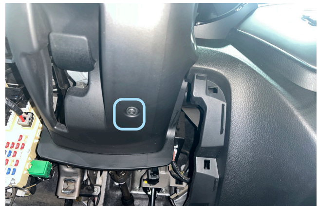
Фото 1.10. Саморез крепления кожуха рулевого вала. Снизу
