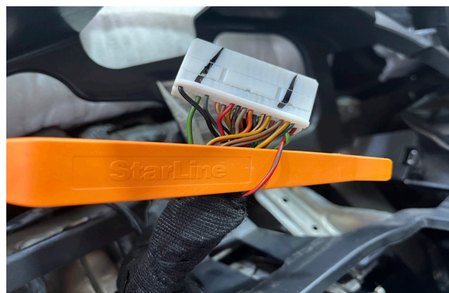
Фото 3.6. Концевик стояночного тормоза (красно-чёрный)
