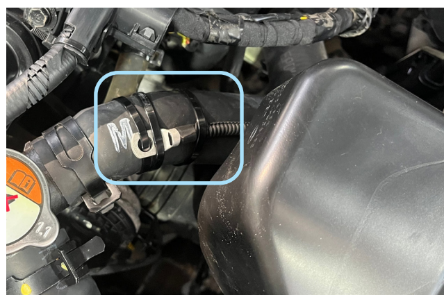
Фото 2.5. Установка датчика температуры двигателя
