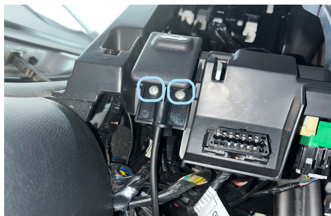
Фото 1.6. Винты крепления ручки открывание капота
