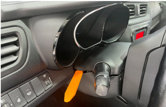
Фото 1.7. Снять верхнюю часть кожуха рулевого вала
