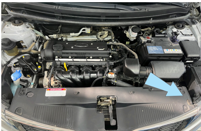
Фото 2.6. Возможное место установки концевика капота
