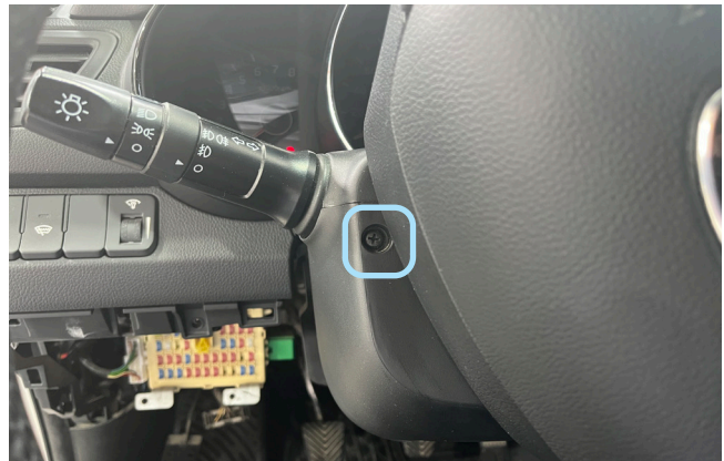
Фото 1.8. Саморез крепления кожуха рулевого вала. Слева
