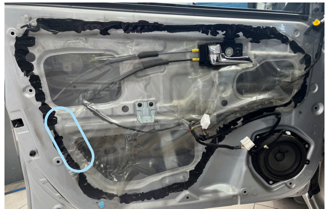
Фото 3.11. Обшивка снята, место установки привода центрального замка
