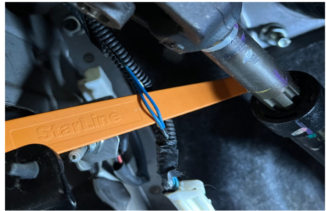
Фото 3.19. Стартер для МКПП (синий)
