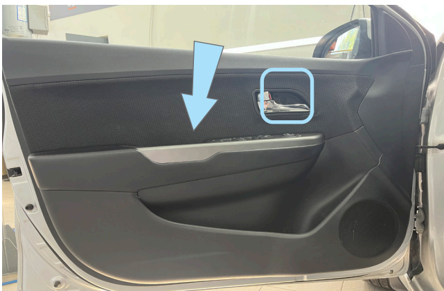
Фото 3.10. Саморезы обшивки водительской двери
