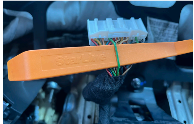
Фото 3.8. Концевик багажника (зелёный)
