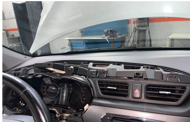
Фото 1.13. Декоративная накладка снята
