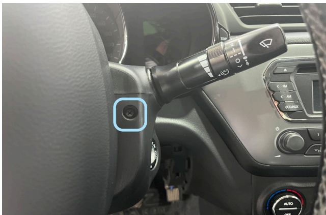
Фото 1.9. Саморез крепления кожуха рулевого вала. Справа
