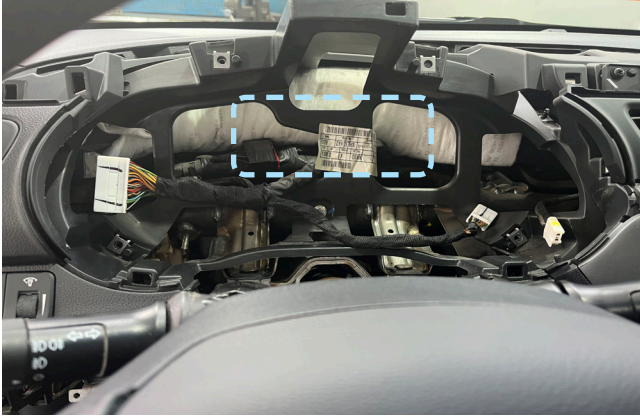
Фото 2.8. Пример расположения центрального блока охранно-телематического комплекса
