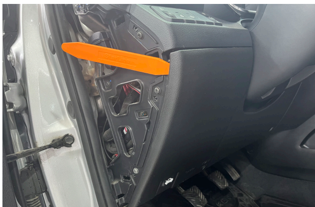
Фото 1.3. Боковая накладка снята. Снять крышку блока предохранителей
