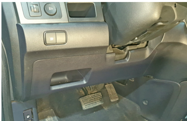
Фото 1.1. Пластиковая накладка под рулевой колонкой. Общий вид
