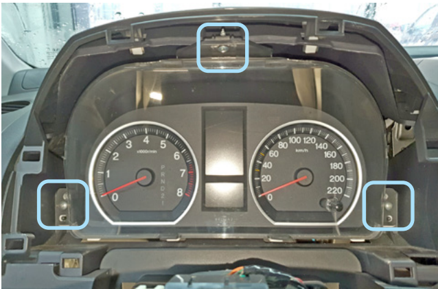
Фото 1.13. Декоративная накладка снята. Саморезы крепления панели приборов
