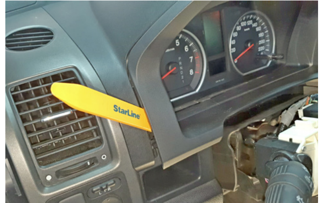
Фото 1.12. Снять декоративную накладку панели приборов
