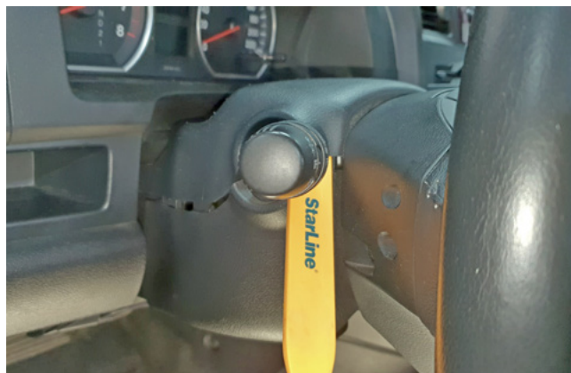
Фото 1.7. Снять верхнюю часть кожуа
