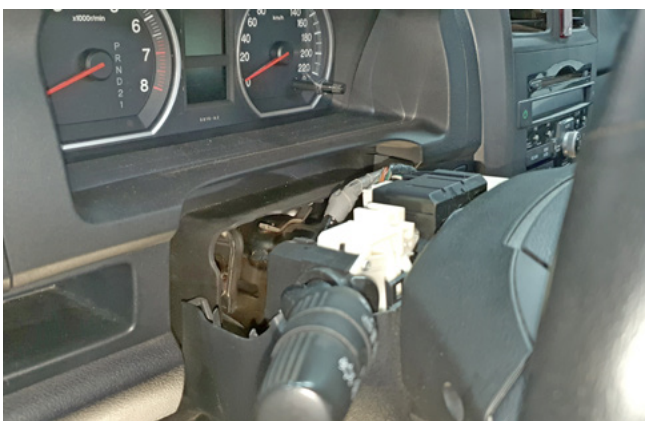
Фото 1.8. Верхняя часть кожуа рулевого вала снята
