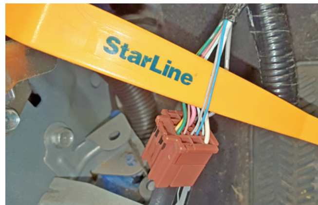
Фото 3.7. Управление центральным замком (синий и серый)
