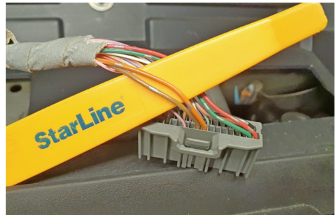
Фото 3.5. Управление световыми сигналами (коричневый и оранжевый)
