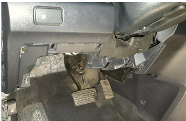
Фото 1.5. Пластиковая накладка под рулевой колонкой снята
