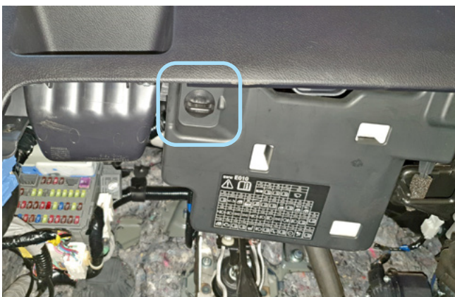
Фото 1.3. Клипса крепления накладки под рулевой колонкой
