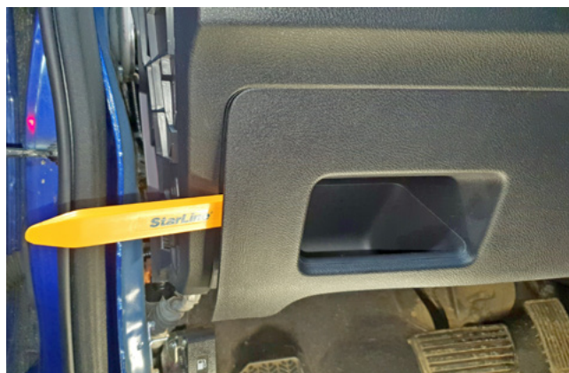
Фото 1.4. Снять пластиковую накладку под рулевой колонкой
