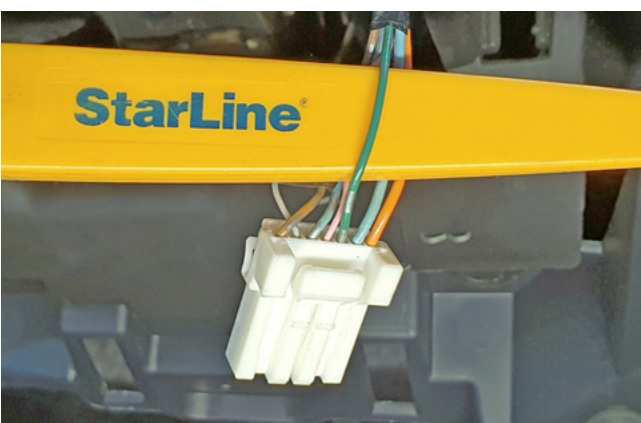
Фото 3.8. Шина данных штатного иммобилайзера (зелёный)
