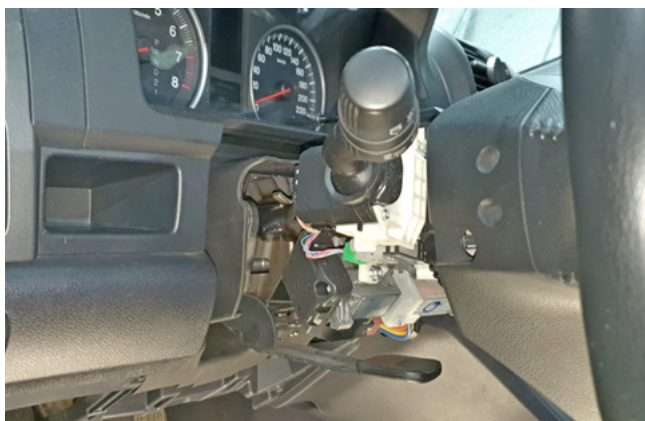
Фото 1.10. Кожа рулевого вала снят
