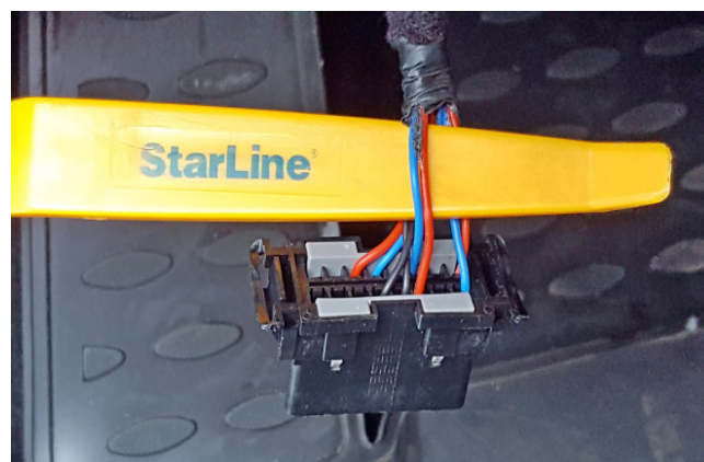
Фото 3.5. Шина CAN-B (красный и синий)
