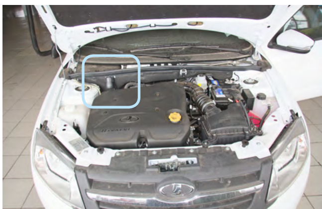
Фото 2.3. Возможное место установки сирены
