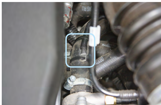
Фото 2.6. Крепление датчика температуры двигателя
