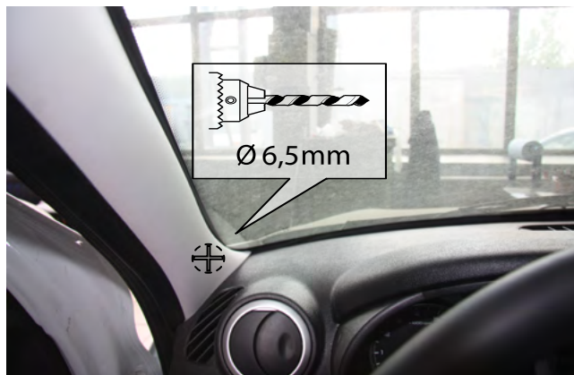
Фото 2.2. Место установки светодиода
