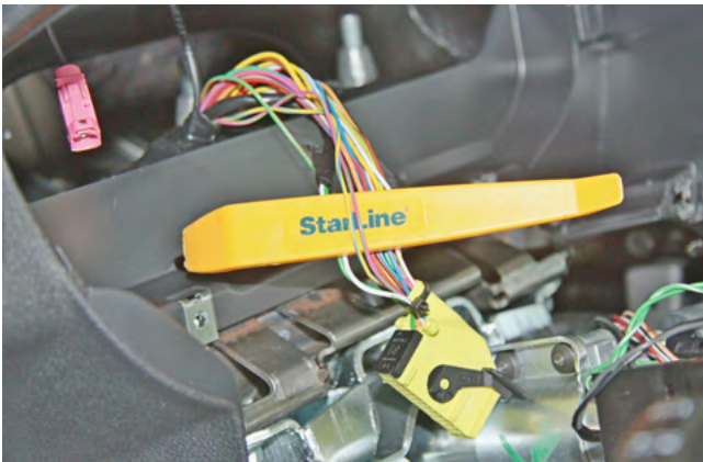
Фото 3.2. CAN-шина (розово-зелёный и жёлто-синий)
