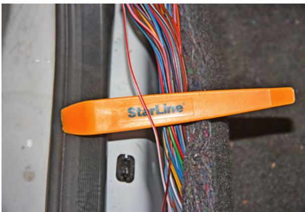
Фото 3.4. Концевик багажника (бело-красный)
