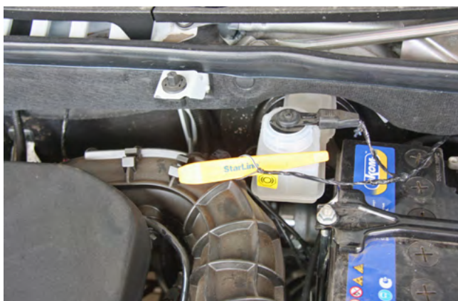
Фото 2.7. Концевик капота (бело-чёрный)
