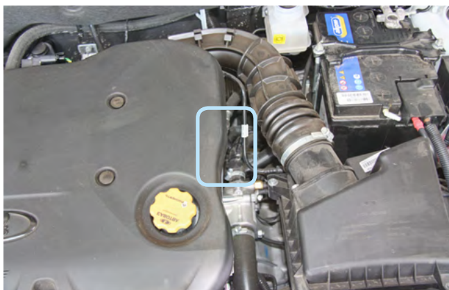
Фото 2.5. Место установки датчика температуры двигателя
