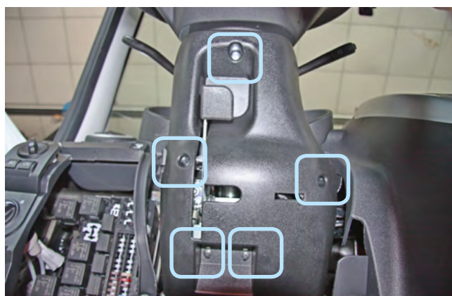
Фото 1.4. Саморезы и болты крепления кожуха рулевого вала снизу
