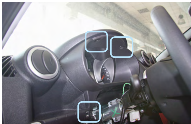
Фото 1.9. Саморезы крепления декоративной накладки панели приборов
