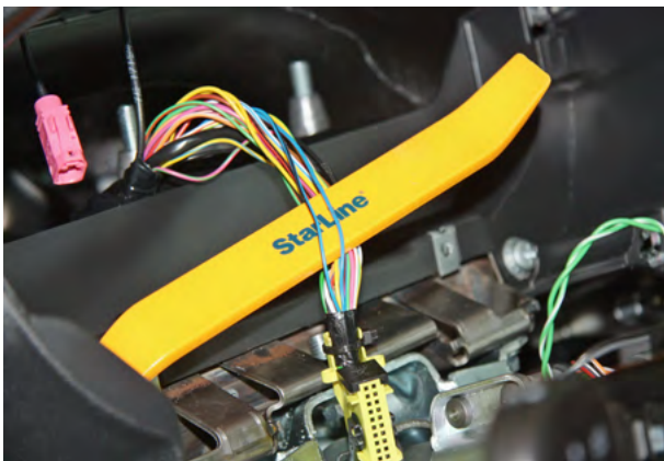
Фото 3.5. Управление световыми сигналами (синий и сине-чёрный)
