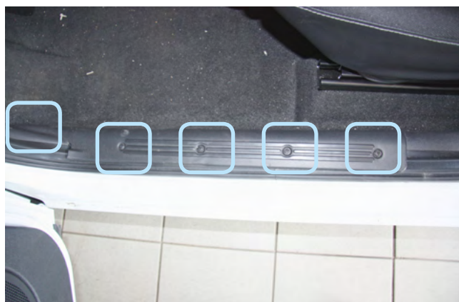
Фото 1.8. Саморезы крепления порога двери водителя
