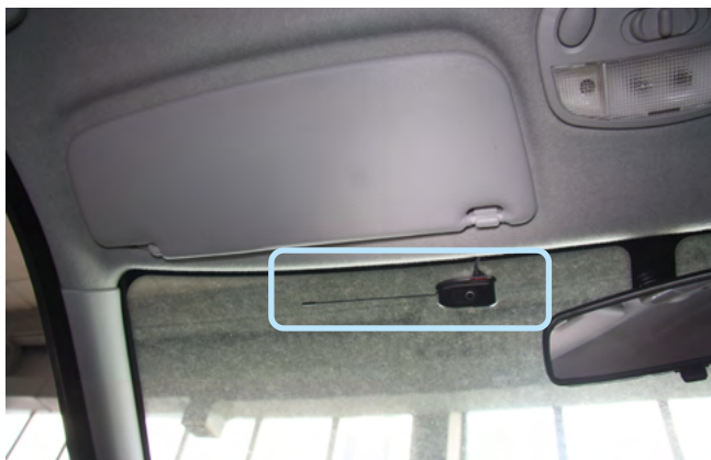
Фото 2.1. Возможное место установки антенного модуля
