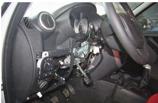
Фото 1.7. Кожух рулевого вала снят
