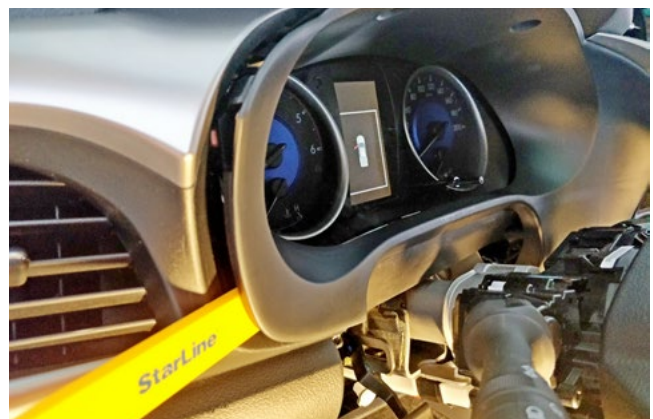
Фото 1.10. Снять накладку панели приборов
