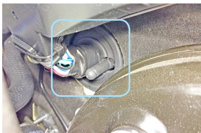
Фото 2.7. Штатный уплотнитель. Вид со стороны моторного отсека
