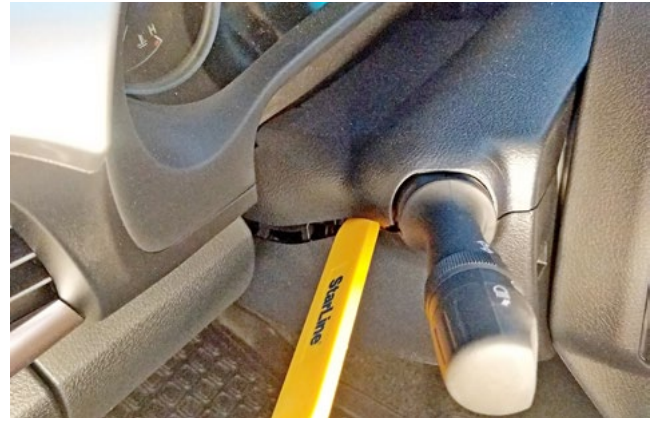
Фото 1.7. Разъединить верхнюю и нижнюю части кожуха
