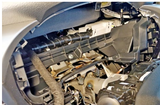
Фото 1.12. Панель приборов снята
