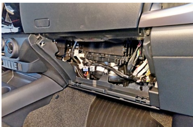
Фото 1.17. Перчаточный ящик снят
