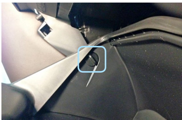
Фото 1.14. Ограничитель открытия перчаточного ящика слева
