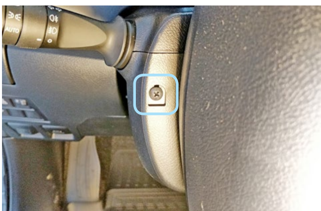
Фото 1.4. Саморез крепления кожуха рулевого вала слева
