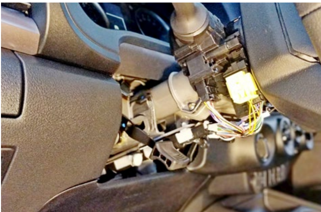
Фото 1.8. Кожух рулевого вала снят
