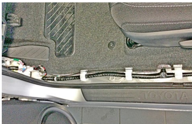
Фото 1.3. Накладки порога и кик-панели сняты
