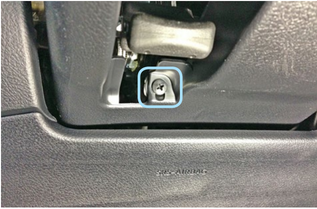
Фото 1.6. Саморез крепления кожуха рулевого вала снизу
