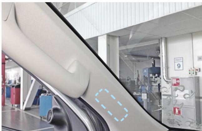
Фото 2.1. Возможное место установки антенны 868 МГц
