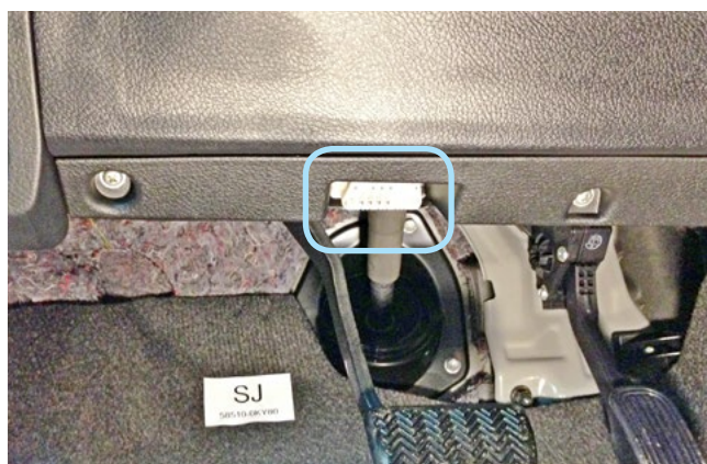
Фото 3.2. Местоположение диагностического разъёма
