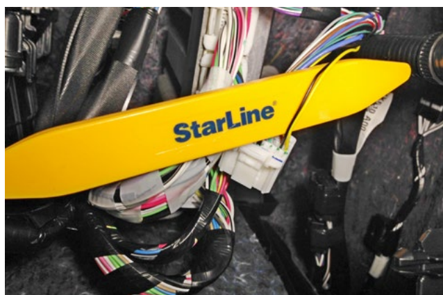
Фото 3.5. Шина данных штатного иммобилайзера (чёрный и жёлтый)
