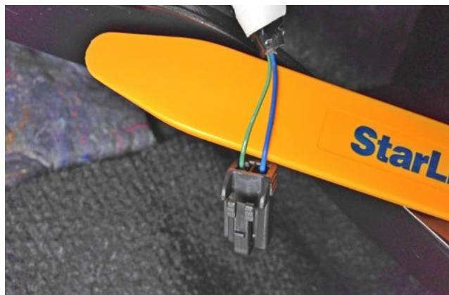
Фото 3.9. Имитация нажатия педали сцепления (зелёный и синий)
