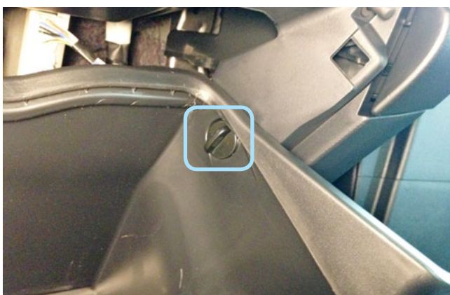
Фото 1.15. Ограничитель открытия перчаточного ящика справа
