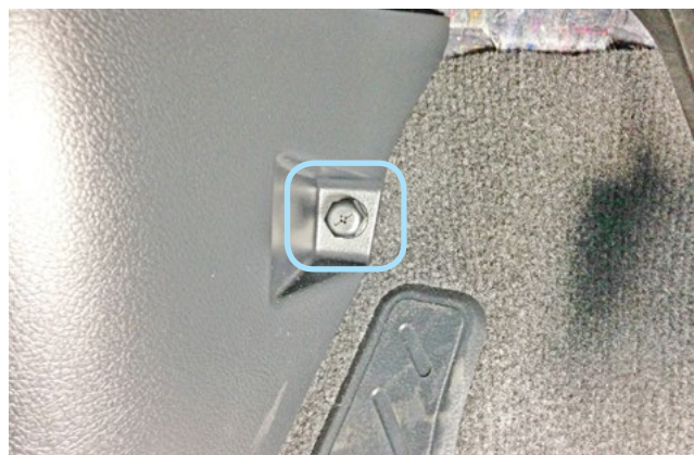
Фото 1.2. Клипса крепления накладки левой кик-панели
