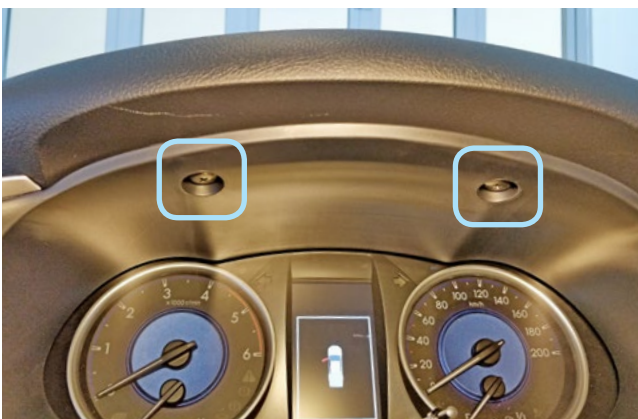
Фото 1.9. Клипсы крепления накладки панели приборов
