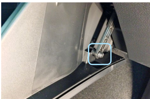
Фото 1.16. Микролифт открытия перчаточного ящика
