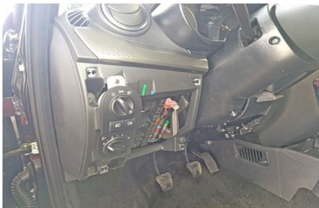
Фото 1.3. Пластиковая накладка под рулевой колонкой снята
