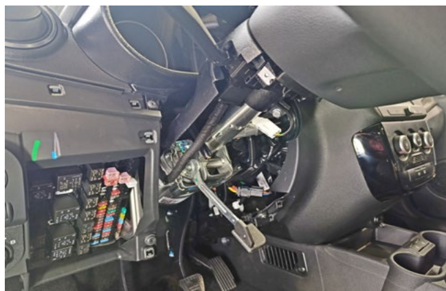
Фото 1.9. Кожух рулевого вала снят
