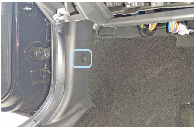
Фото 1.18. Саморез крепления накладки
