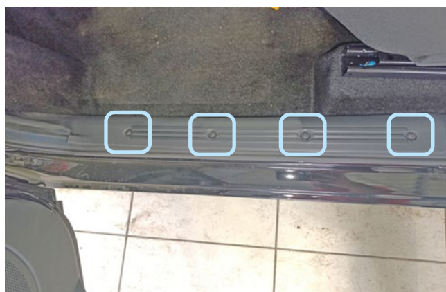
Фото 1.17. Саморезы крепления накладки порога двери водителя
