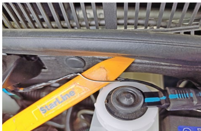
Фото 3.8. Концевик капота (бело-чёрный)
