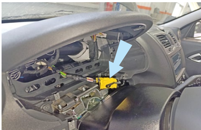
Фото 3.2. Местоположение разъёма панели приборов
