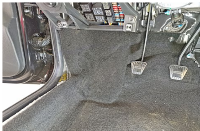
Фото 1.19. Накладка порога двери водителя снята
