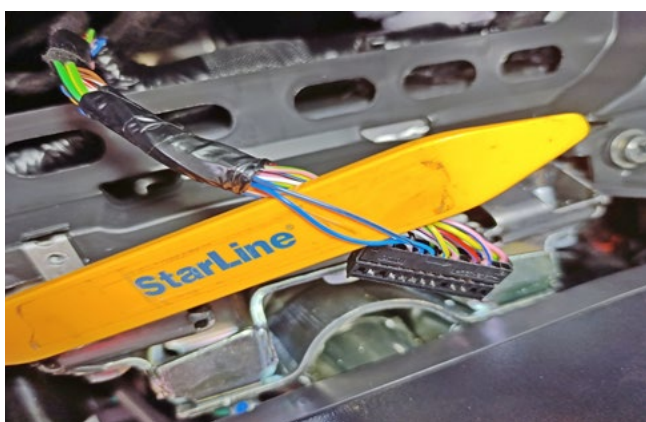
Фото 3.4. Управление световыми сигналами (синий и сине-чёрный)
