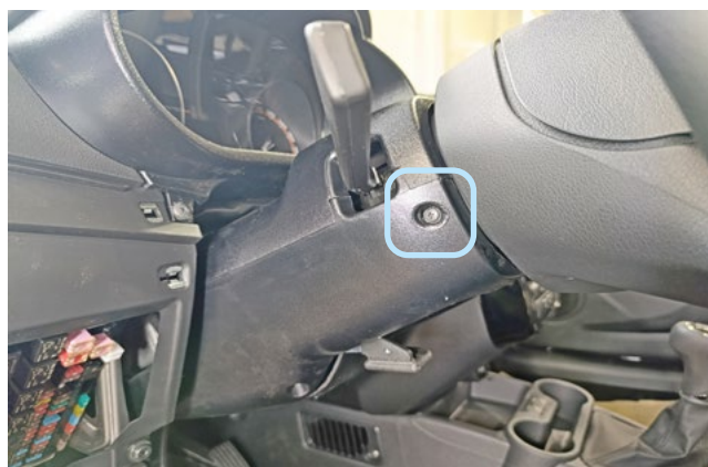
Фото 1.6. Саморез крепления кожуха рулевого вала слева
