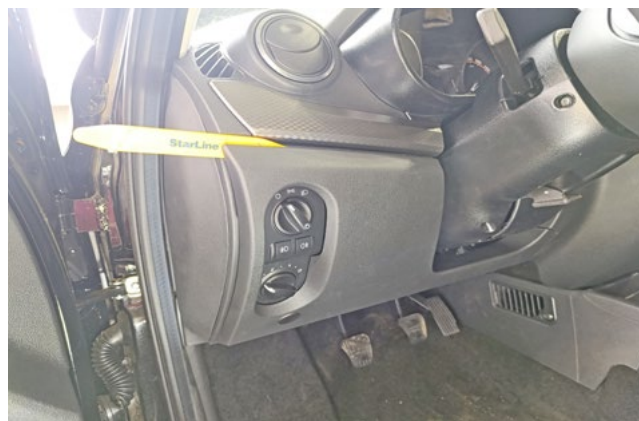
Фото 1.2. Снять пластиковую накладку под рулевой колонкой
