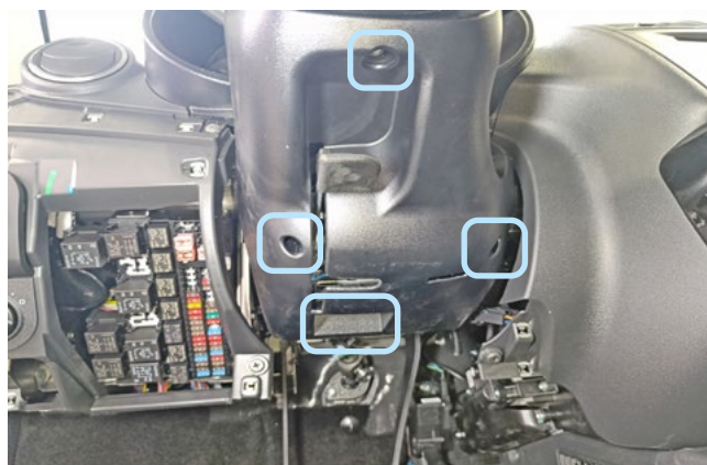
Фото 1.8. Саморезы крепления кожуха рулевого вала снизу
