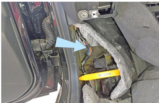
Фото 3.5. Местоположение жгута в пороге двери водителя
