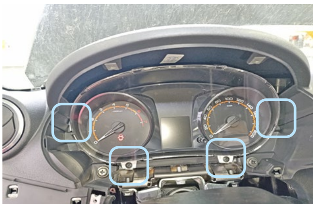
Фото 1.14. Декоративная накладка панели приборов снята. Саморезы крепления панели приборов
