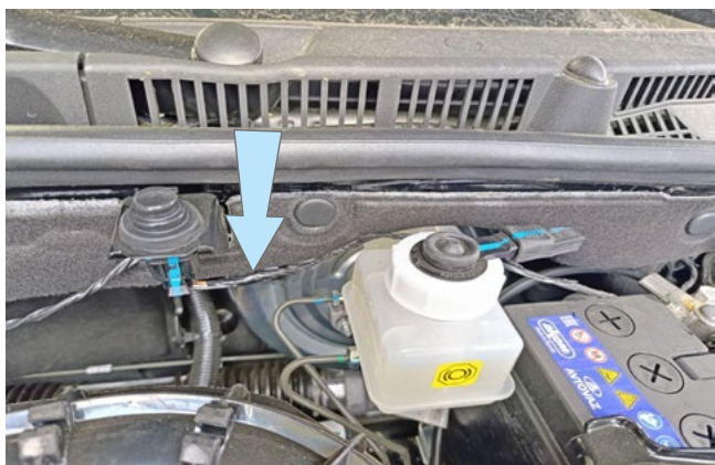
Фото 3.7. Местоположение жгута штатного концевика капота
