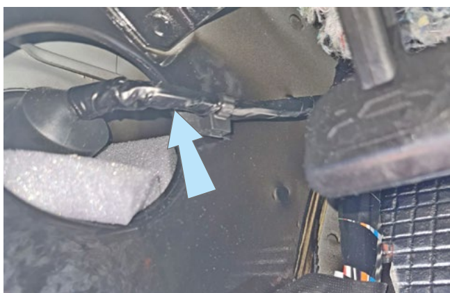
Фото 3.9. Местоположение жгута двери водителя
