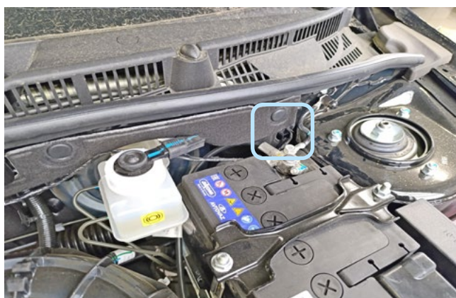
Фото 2.7. Штатный уплотнитель. Вид со стороны капота
