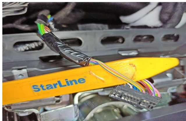
Фото 3.3. Шина CAN-A (розово-зелёный и жёлто-синий)
