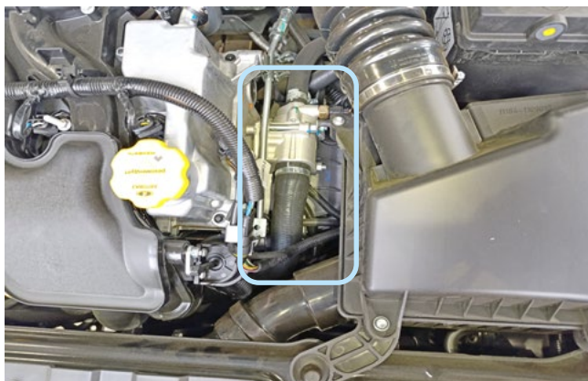
Фото 2.5. Место установки датчика температуры двигателя
