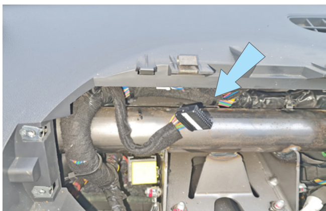
Фото 3.4. Местоположение чёрного разъёма
