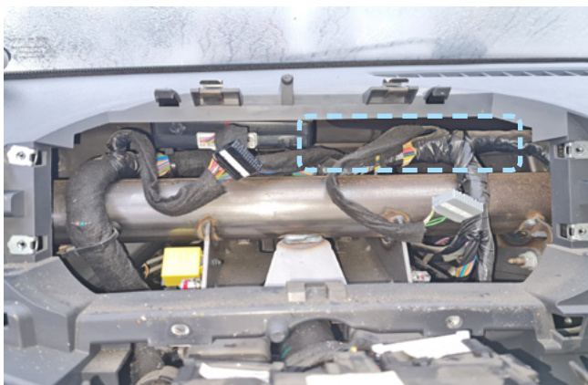
Фото 2.8. Пример расположения центрального блока охранно-телематического комплекса
