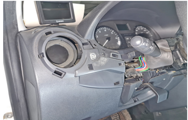
Фото 1.10. Накладка воздуховода снята
