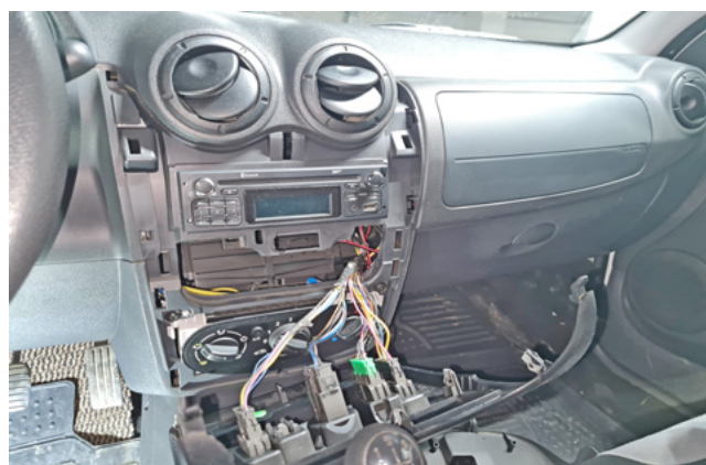
Фото 1.6. Накладка мультимедийной системы снята
