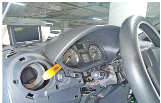
Фото 1.12. Снять декоративную накладку панели приборов
