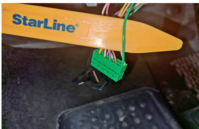
Фото 3.8. Контроль концевика багажника (зелёный)
