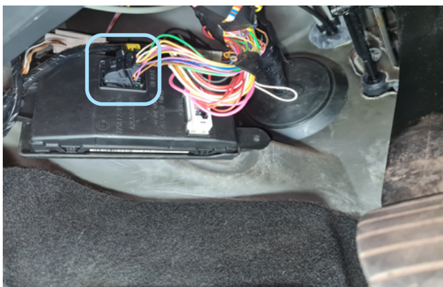
Фото 3.11. Местоположение чёрного разъёма блока BCM
