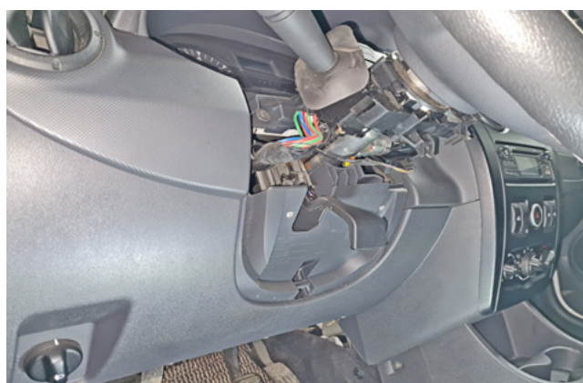
Фото 1.4. Кожух рулевого вала снят
