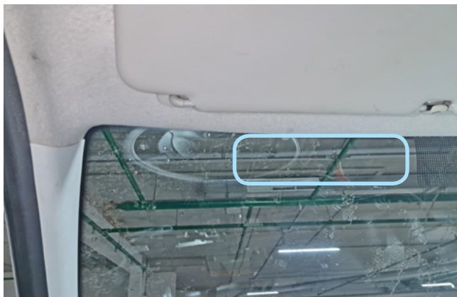
Фото 2.1. Возможное место установки антенного модуля
