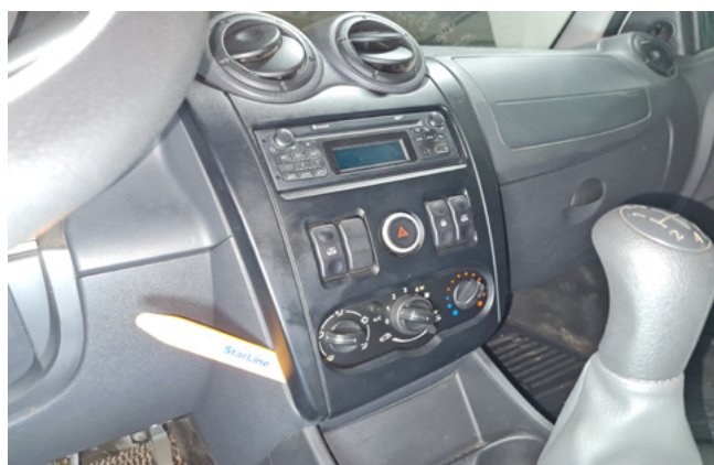
Фото 1.5. Снять декоративную накладку мультимедийной системы
