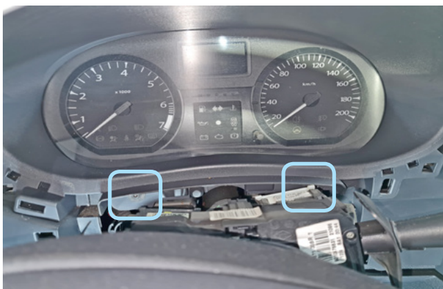
Фото 1.11. Саморезы крепления декоративной накладки панели приборов
