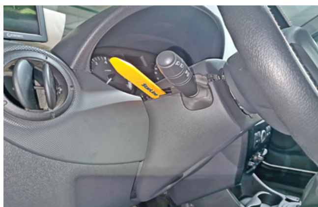
Фото 1.3. Снять кожух рулевого вала
