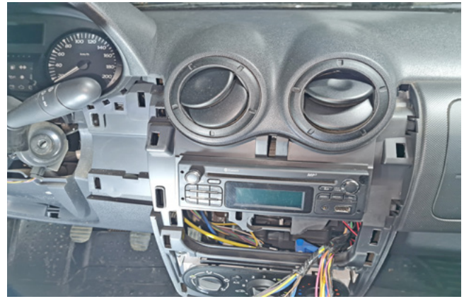
Фото 1.8. Накладка справа от рулевой колонки снята
