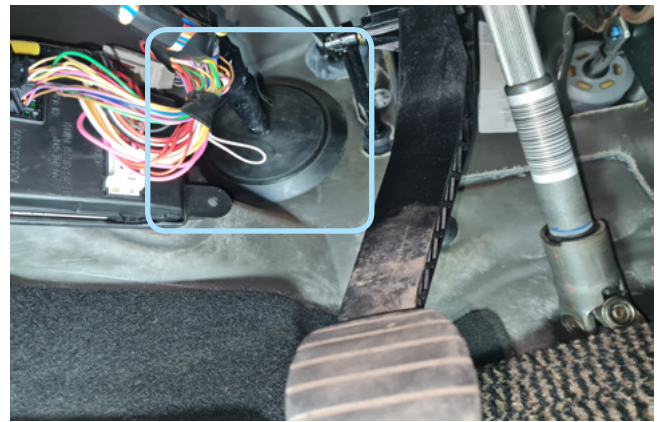
Фото 2.7. Штатный уплотнитель. Вид со стороны салона
