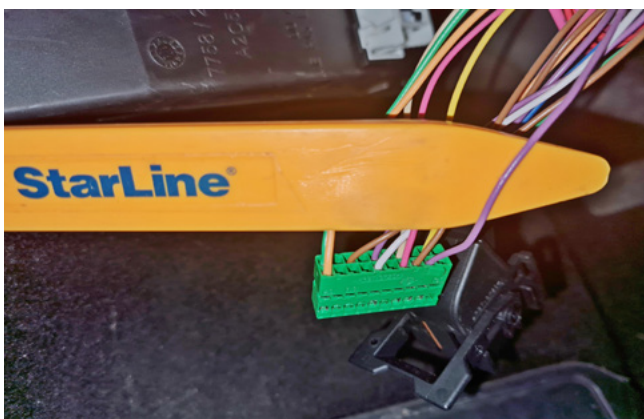
Фото 3.13. Управление индикатором штатного иммобилайзера (фиолетовый)
