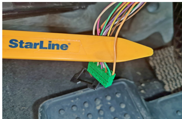
Фото 3.7. Контроль концевиков дверей (оранжевый)
