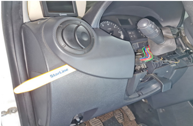
Фото 1.9. Снять накладку воздуховода слева от рулевой колонки
