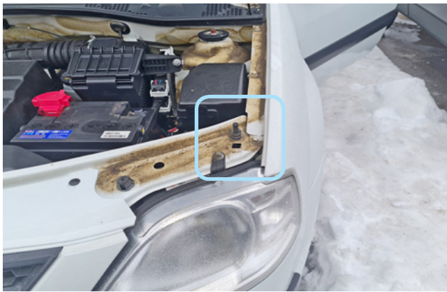
Фото 2.6. Возможное место установки концевика капота
