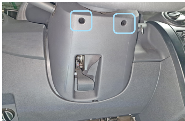
Фото 1.2. Саморезы крепления кожуха рулевого вала
