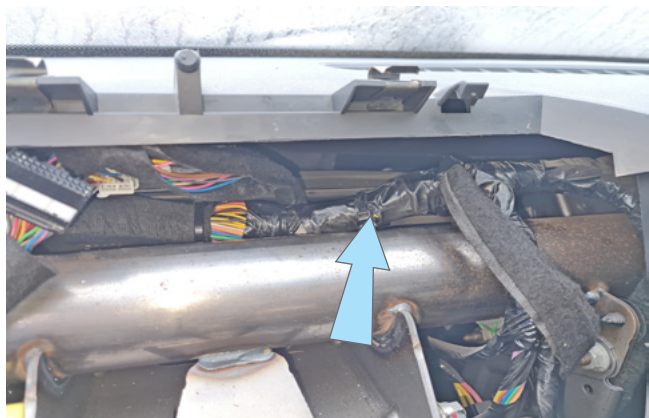
Фото 3.2. Местоположение жгута за панелью приборов
