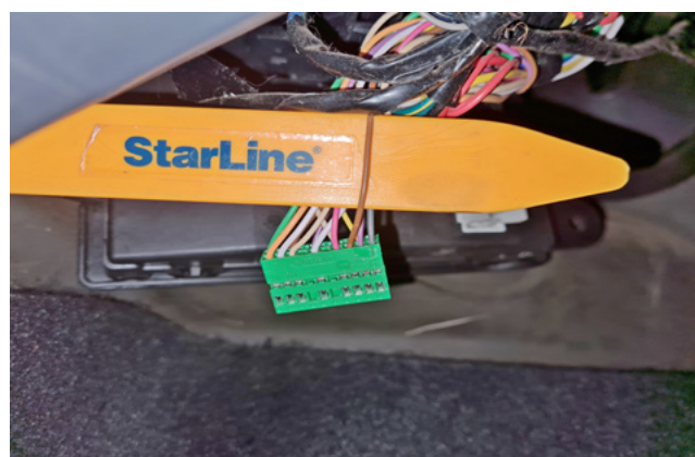
Фото 3.10. Управление световыми сигналами (коричневый)
