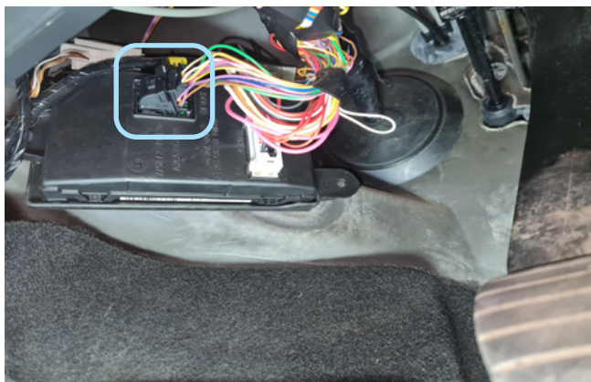
Фото 3.6. Местоположение чёрного разъёма блока BCM
