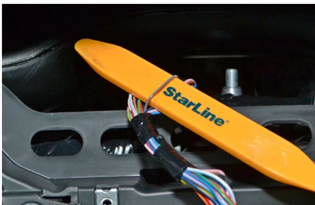
Фото 3.5. Стояночный тормоз (коричнево-синий)
