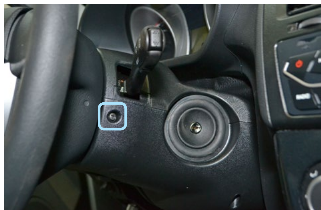
Фото 1.8. Саморез крепления нижней части рулевого кожуха
