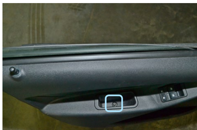
Фото 1.18. Саморез крепления внутренней обшивки двери водителя
