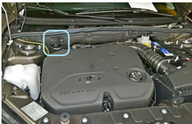
Фото 2.3. Возможное место установки сирены
