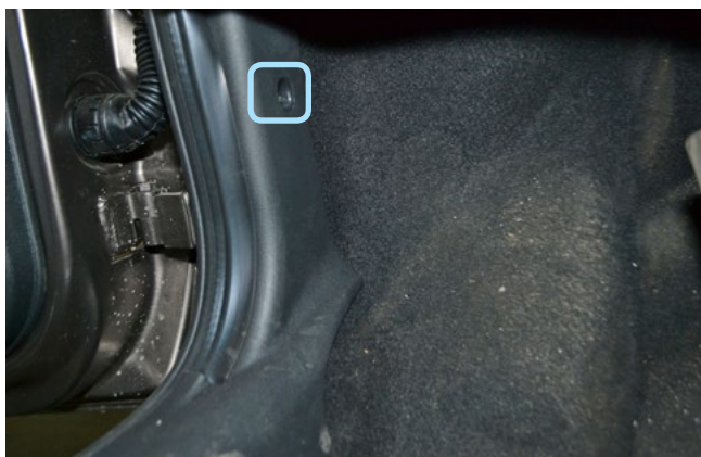
Фото 1.3. Саморез крепления накладки порога двери водителя
