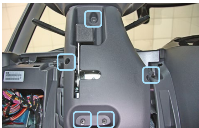
Фото 1.9. Крепление нижней части рулевого кожуха
