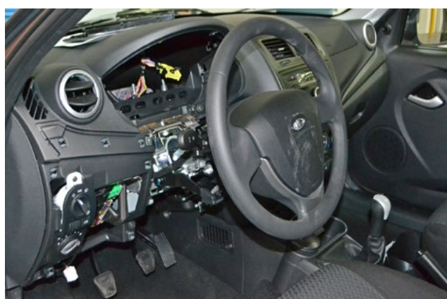
Фото 1.16. Панель приборов снята
