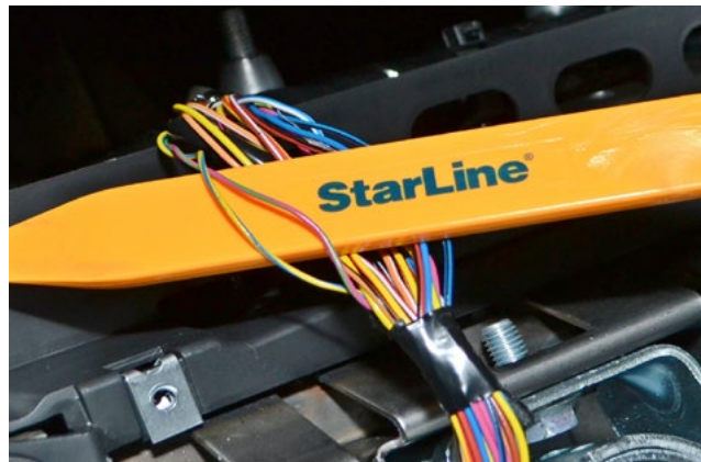
Фото 3.3. Шина CAN-A (розово-зелёный и жёлто-синий)
