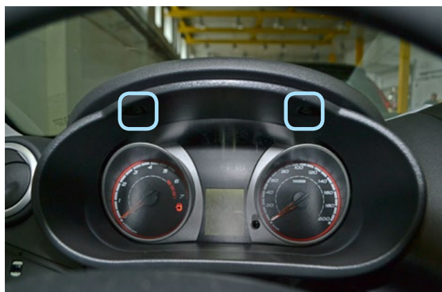
Фото 1.14. Верхние саморезы крепления декоративной накладки панели приборов
