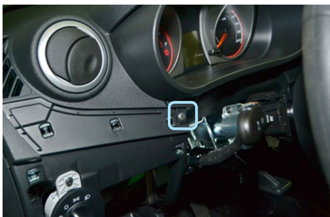
Фото 1.13. Нижний саморез крепления декоративной накладки панели приборов
