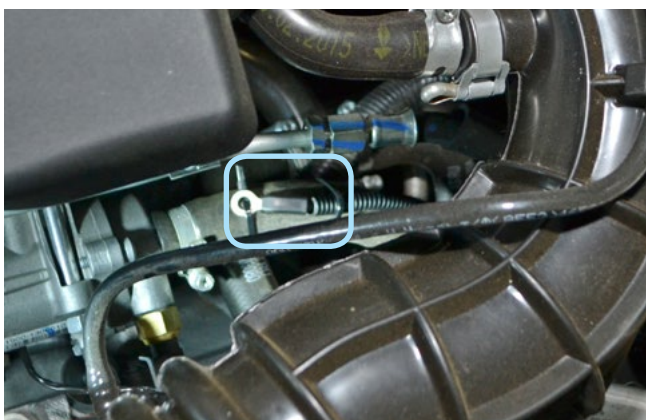
Фото 2.6. Крепление датчика температуры двигателя
