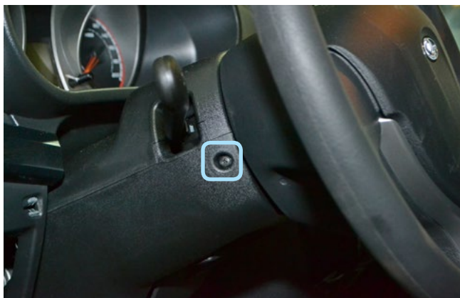
Фото 1.7. Саморез крепления нижней части рулевого кожуха
