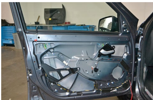
Фото 1.19. Внутренняя обшивка двери водителя снята
