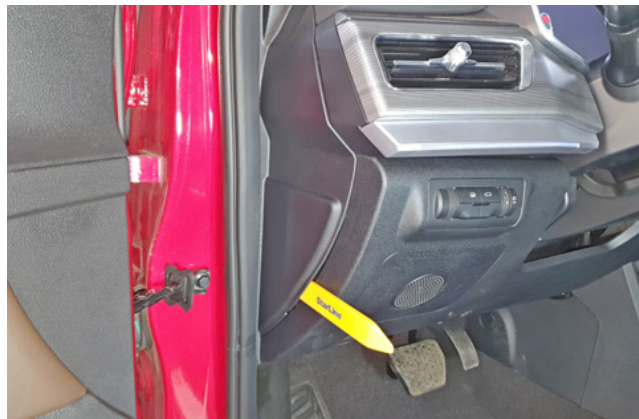
Фото 1.2. Снять боковую накладку передней панели
