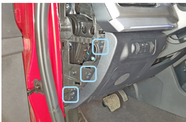
Фото 1.3. Саморезы крепления пластиковой накладки под рулевой колонкой
