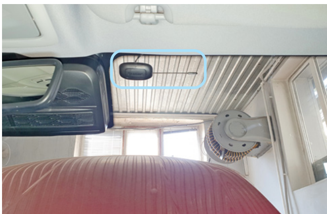
Фото 2.1. Возможное место установки антенного модуля
