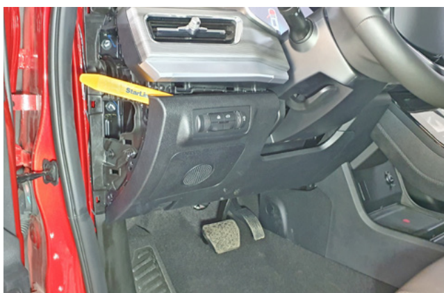
Фото 1.4. Снять пластиковую накладку под рулевой колонкой
