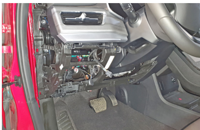
Фото 1.5. Пластиковая накладка под рулевой колонкой снята
