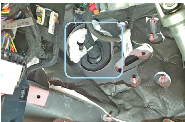
Фото 2.7. Штатный уплотнитель. Вид со стороны салона
