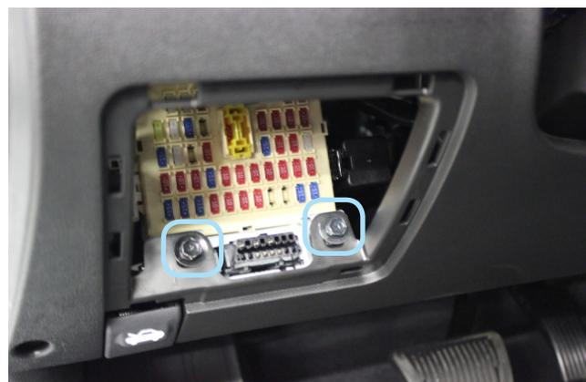
Фото 1.4. Болты крепления пластиковой накладки под рулевой колонкой
