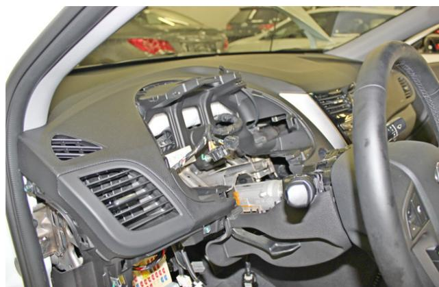
Фото 1.16. Панель приборов снята
