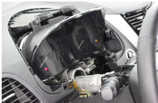
Фото 1.14. Накладка панели приборов снята
