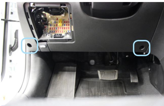
Фото 1.5. Саморезы крепления пластиковой накладки под рулевой колонкой
