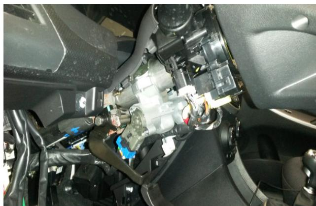
Фото 1.12. Кожух рулевого вала снят
