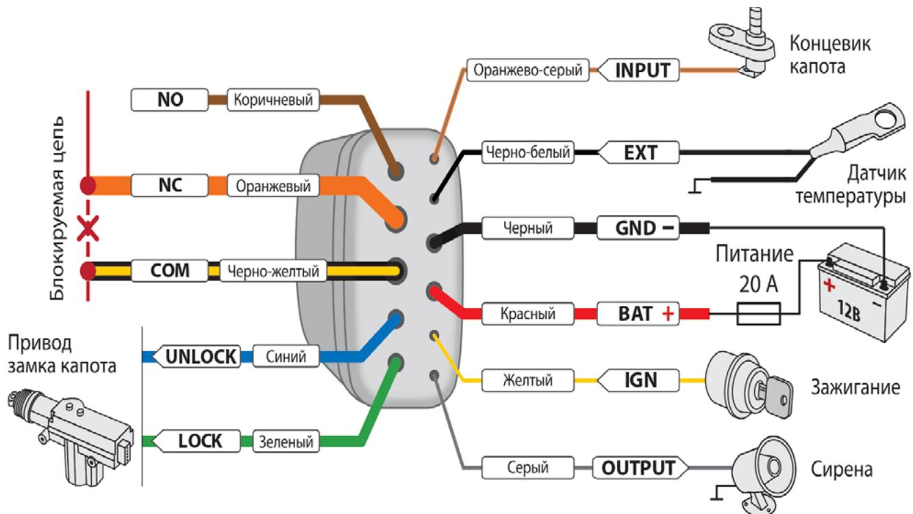
Центральный блок охранно-телематического комплекса StarLine закрепить на пластиковые стяжки за панелью приборов. **Внимание!!! Не размещайте центральный блок на расстоянии менее 10 см от металлических частей кузова автомобиля во избежание плохого качества приёма сигнала Bluetooth!**
