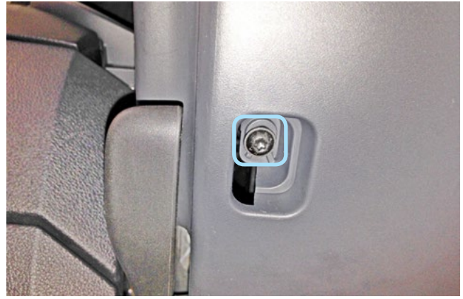
Фото 1.12. Винт крепления кожуха рулевого вала снизу
