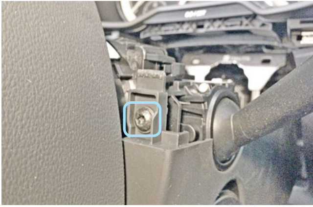
Фото 1.11. Винт крепления кожуха рулевого вала справа
