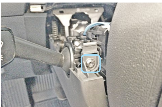
Фото 1.10. Винт крепления кожуха рулевого вала слева
