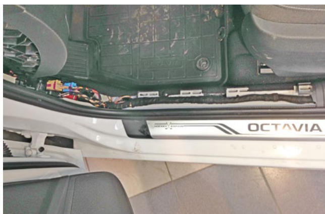
Фото 1.7. Накладка порога двери водителя снята
