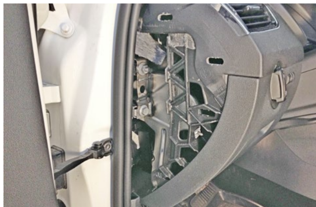
Фото 1.2. Левая боковая накладка передней панели снята
