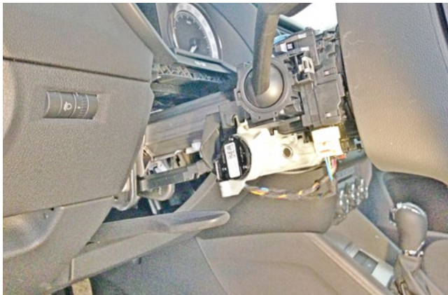
Фото 1.13. Кожух рулевого вала снят
