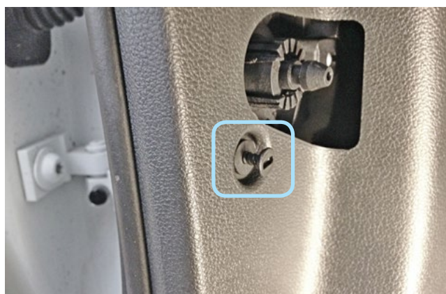
Фото 1.6. Снять заглушку и отвернуть фиксирующий винт
