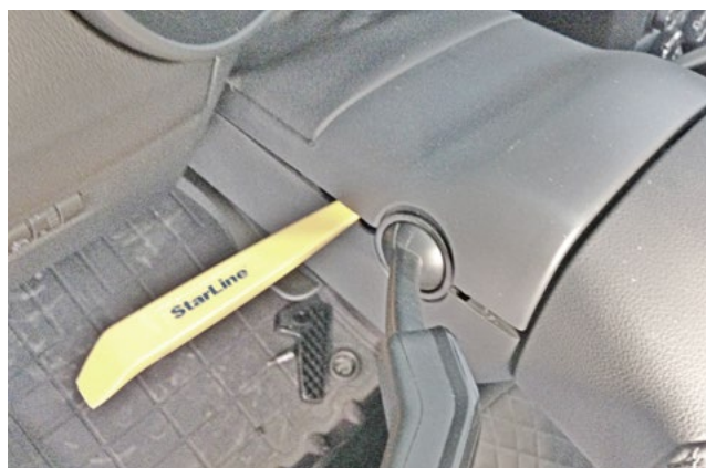
Фото 1.8. Отсоединить верхнюю часть кожуха рулевого вала
