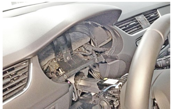
Фото 1.15. Панель приборов снята
