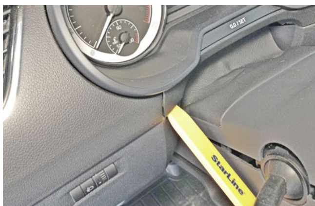
Фото 1.9. Снять накладку под панелью приборов
