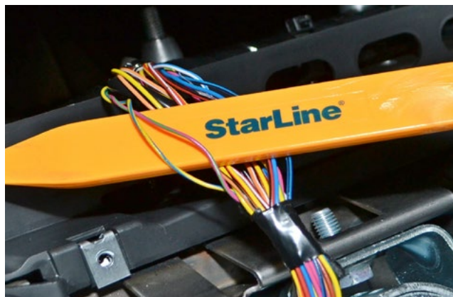
Фото 3.3. Шина CAN-A (розово-зелёный и жёлто-синий)
