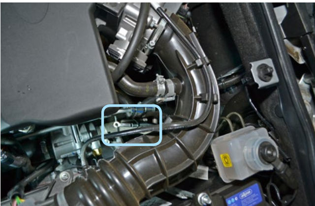
Фото 2.5. Место установки датчика температуры двигателя
