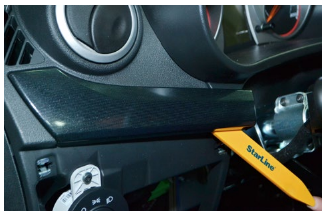
Фото 1.12. Снять декоративную накладку
