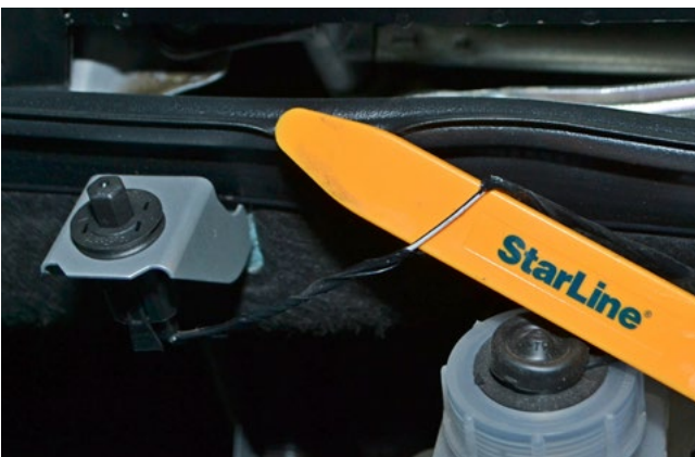
Фото 2.7. Концевик капота (бело-чёрный)
