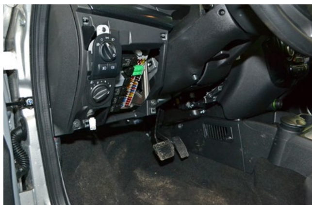
Фото 1.6. Накладка под рулевой колонкой снята
