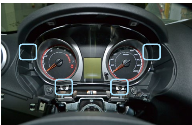
Фото 1.15. Декоративная накладка панели приборов снята. Саморезы крепления панели приборов
