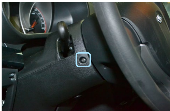
Фото 1.7. Саморез крепления нижней части кожану рулевого вала
