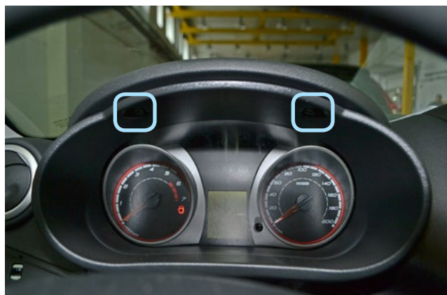
Фото 1.14. Верхние саморезы крепления накладки панели приборов
