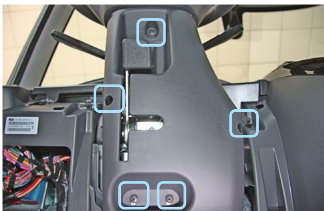
Фото 1.9. Крепление нижней части кожану рулевого вала
