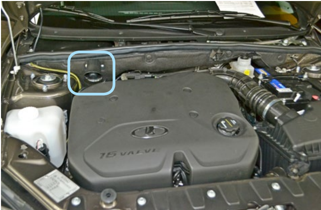
Фото 2.3. Возможное место установки сирены
