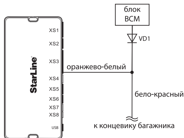
Схема 3. Подключение концевика багажника
