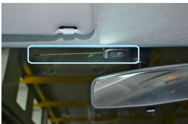
Фото 2.1. Возможное место установки антенного модуля
