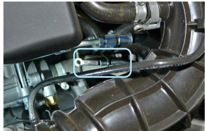
Фото 2.6. Крепление датчика температуры двигателя
