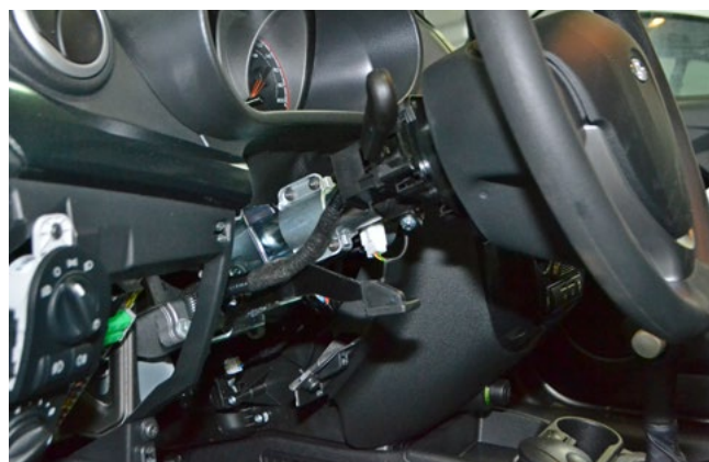
Фото 1.10. Кожух рулевого вала снят
