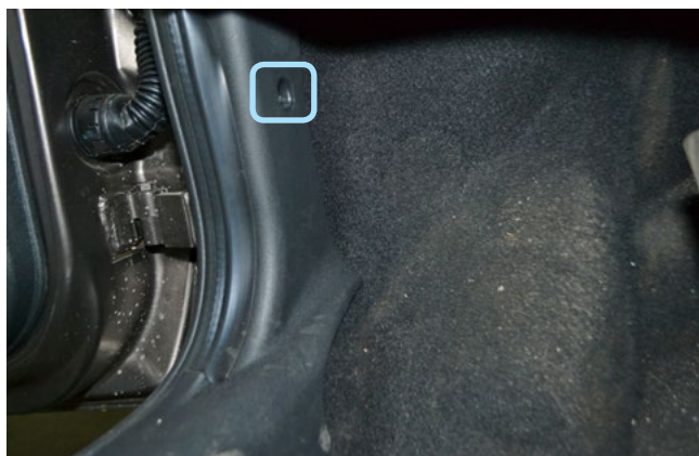
Фото 1.3. Саморез крепления накладки порога двери водителя
