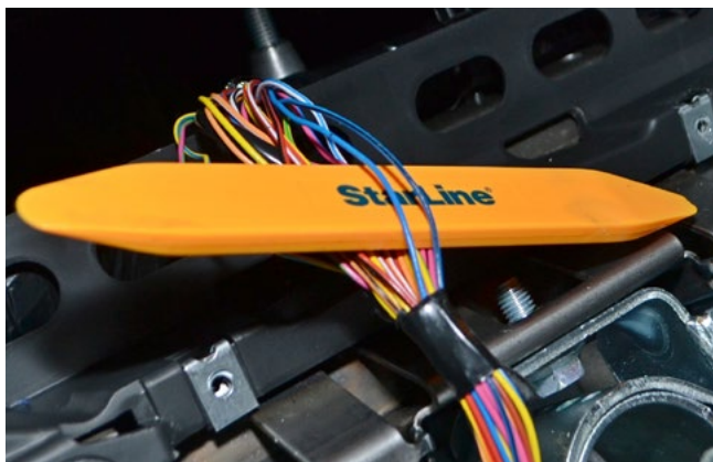
Фото 3.5. Управление световыми сигналами (синий и сине-чёрный)
