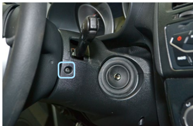
Фото 1.8. Саморез крепления нижней части кожану рулевого вала
