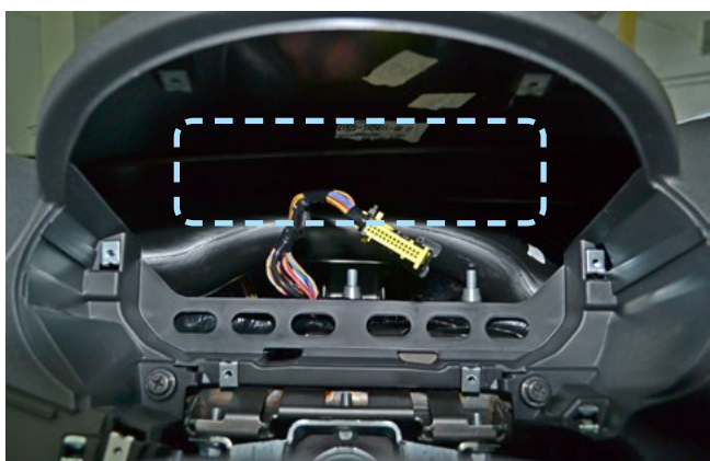
Фото 2.9. Пример расположения центрального блока охранно-телематического комплекса
