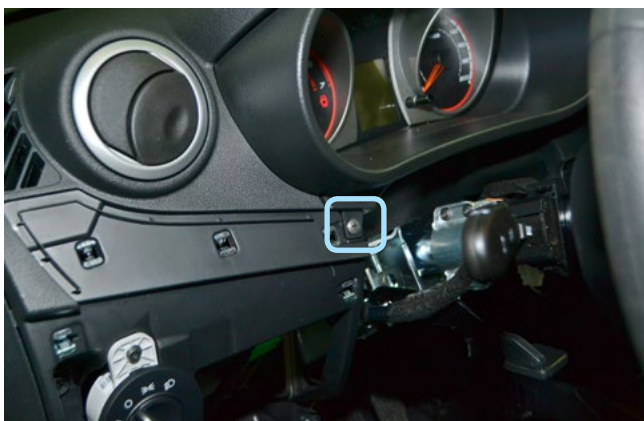
Фото 1.13. Нижний саморез крепления накладки панели приборов
