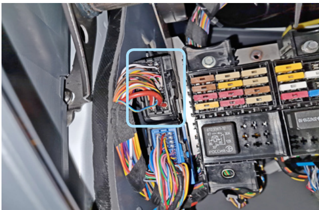
Фото 3.15. Местоположение чёрного разъёма
