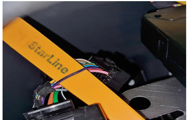
Фото 3.7. Контроль стояночного тормоза (фиолетово-чёрный)
