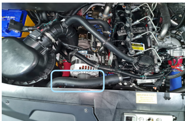
Фото 2.4. Место установки датчика температуры двигателя
