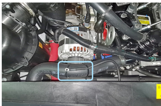
Фото 2.5. Крепление датчика температуры двигателя
