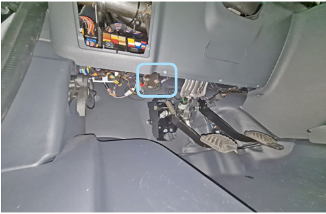
Фото 3.4. Местоположение диагностического разъёма
