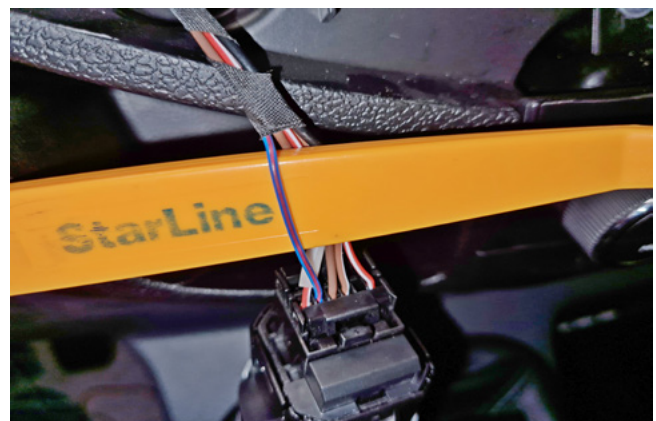
Фото 3.9. Управление кнопкой Старт-Стоп (сине-красный)
