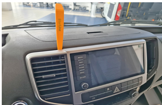
Фото 1.4. Снять левый центральный воздухопровод
