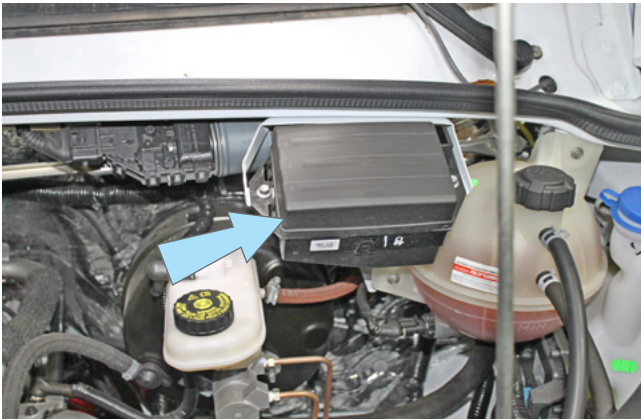
Фото 2.8. Возможное место установки подкапотного блока R6
