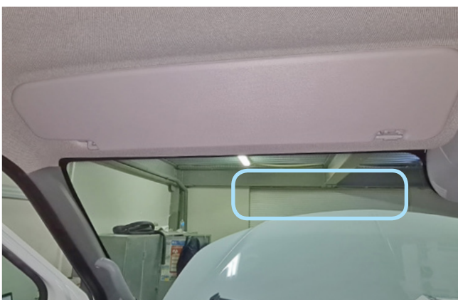
Фото 2.1. Возможное место установки антенны 868 МГц
