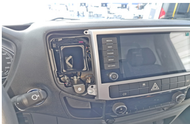
Фото 1.5. Левый центральный воздухопровод снят
