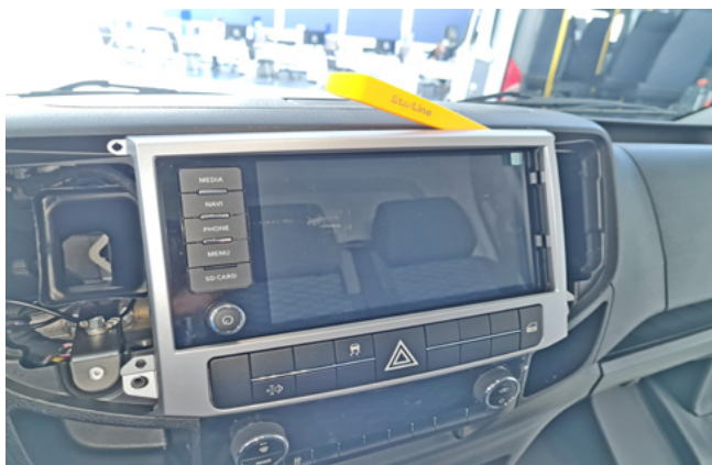
Фото 1.7. Снять декоративную накладку
