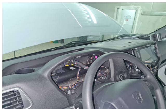
Фото 1.12. Панель приборов снята
