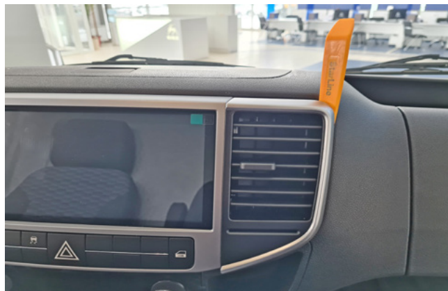
Фото 1.2. Снять правый центральный воздухопровод
