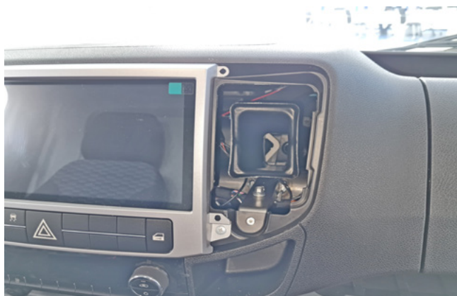
Фото 1.3. Правый центральный воздухопровод снят
