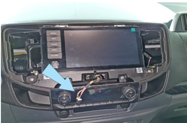
Фото 3.2. Местоположение жгута разъёма декоративной наклейки мультимедиа
