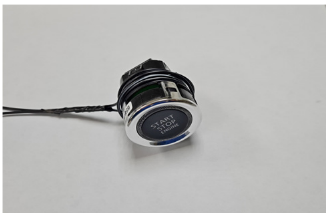
Фото 3.12. Расположение антенны модуля ВР-03/04 на кнопке Старт-Стоп
