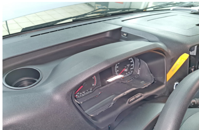
Фото 1.10. Снять декоративную накладку
