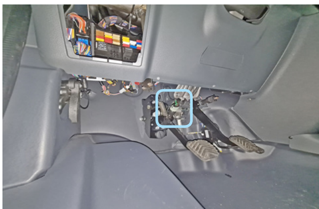
Фото 3.10. Местоположение разъёма концевика сцепления
