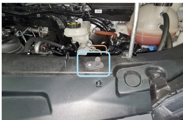
Фото 2.6. Возможное место установки концевика капота
