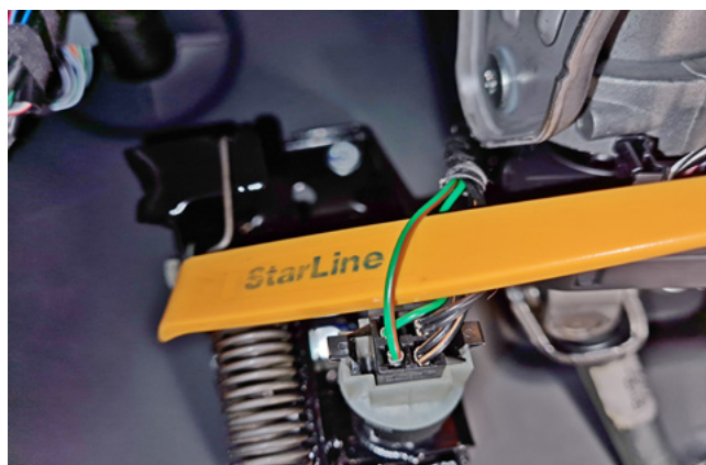
Фото 3.11. Имитация нажатия педали сцепления (зелёно-красный)
