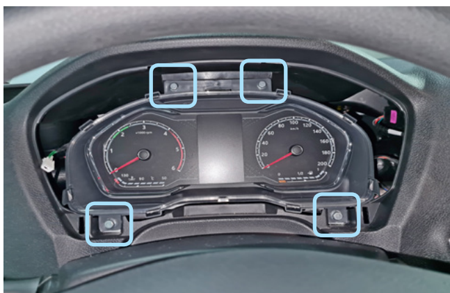
Фото 1.11. Декоративная накладка снята. Саморезы
