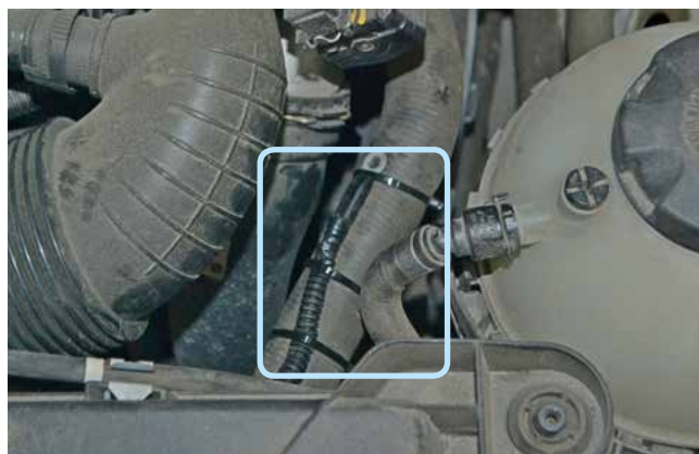
Фото 2.5. Крепление датчика температуры двигателя
