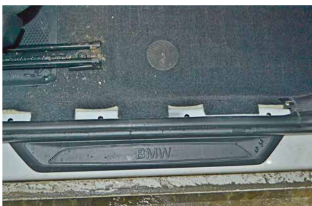
Фото 1.12. Накладка порога передней правой двери снята
