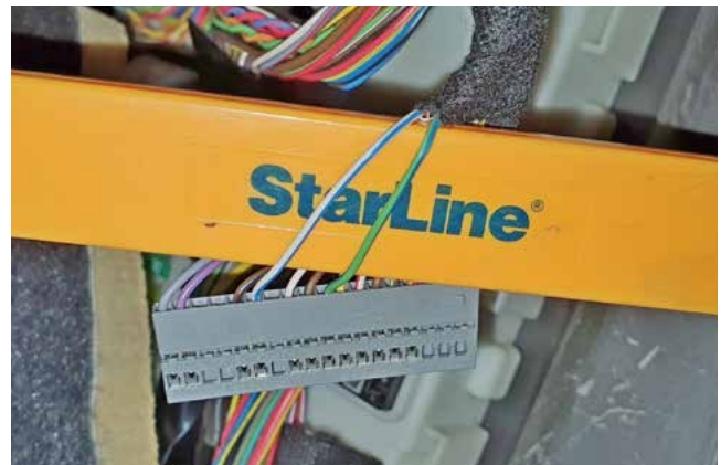
Фото 3.7. Управление кнопкой Старт-Стоп (бело-синий и зелёно-синий)
