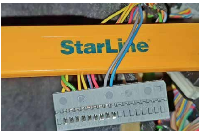
Фото 3.5. Шина CAN-B (серый и синий)
