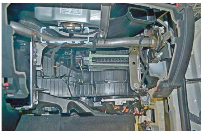
Фото 2.8. Пример расположения центрального блока охранно-телематического комплекса
