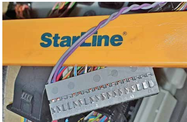
Фото 3.13. Провод штатной антенны иммобилайзера (серый и фиолетовый)
