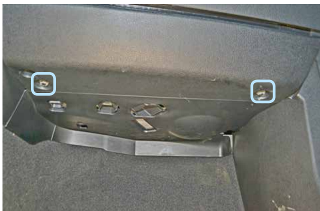
Фото 1.6. Болты крепления накладки под перчаточным ящиком
