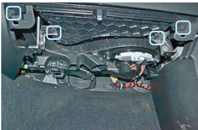
Фото 1.7. Накладка под перчаточным ящиком снята. Саморезы крепления перчаточного ящика
