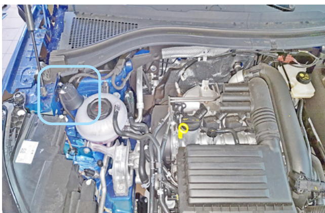
Фото 2.2. Возможное место установки сирены
