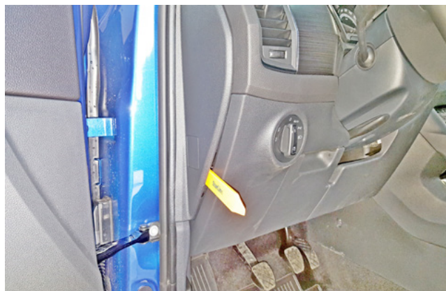
Фото 1.2. Снять левую боковую накладку передней панели
