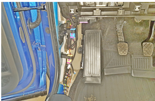
Фото 1.17. Пластиковая накладка левой кик-панели снята
