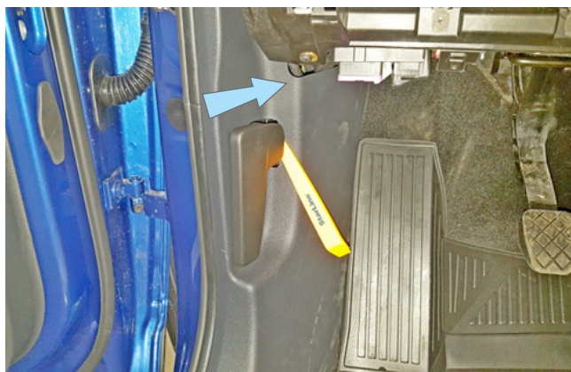
Фото 1.13. Сдвинуть фиксатор ручки отпирания капота в направлении стрелки
