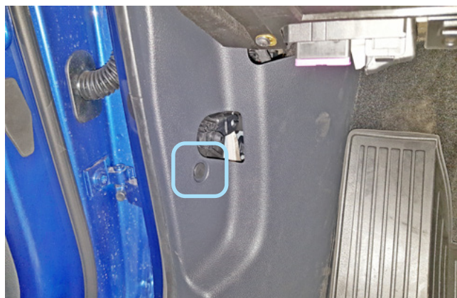
Фото 1.14. Ручка отпирания капота снята. Клипса крепления накладки левой кик-панели
