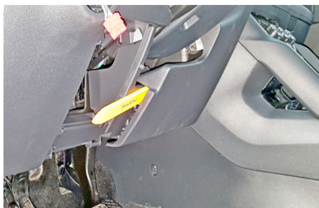
Фото 1.10. Снять правую часть накладки под рулевой колонкой
