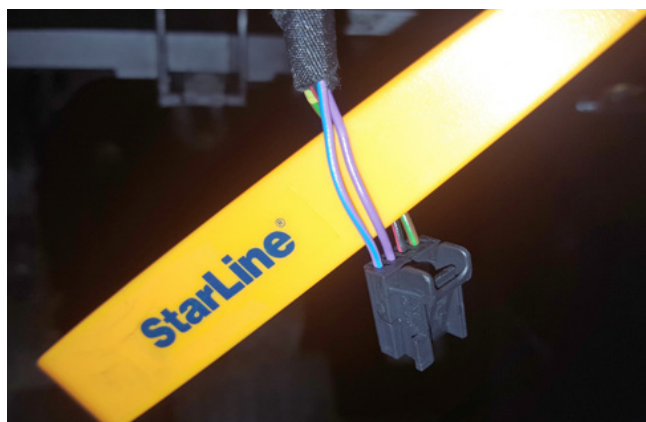
Фото 3.9. Управление кнопкой Старт-Стоп (фиолетовый и фиолетово-синий)
