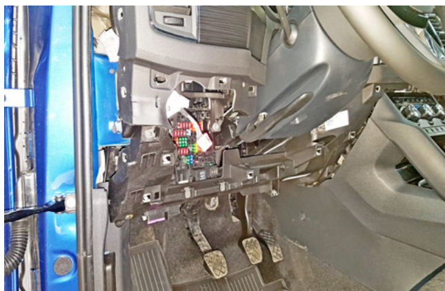
Фото 1.12. Пластиковая накладка под рулевой колонкой снята
