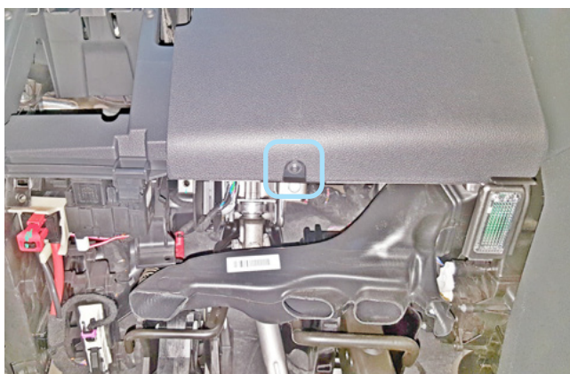
Фото 1.9. Саморез крепления в нижней части накладки
