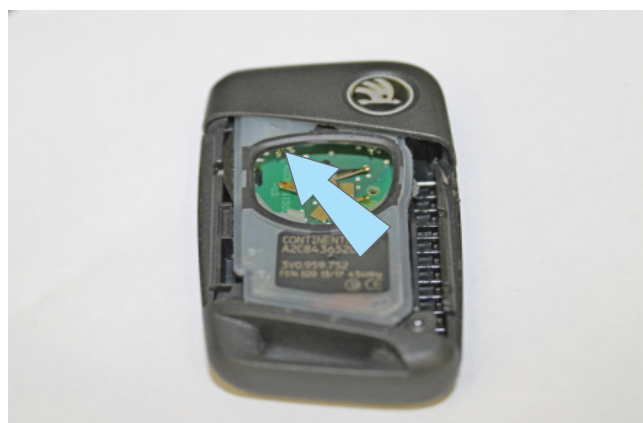
Фото 3.15. Контактная площадка (+) на плате ключа
