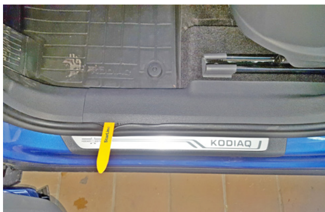
Фото 1.15. Частично снять пластиковую наладку порога двери водителя
