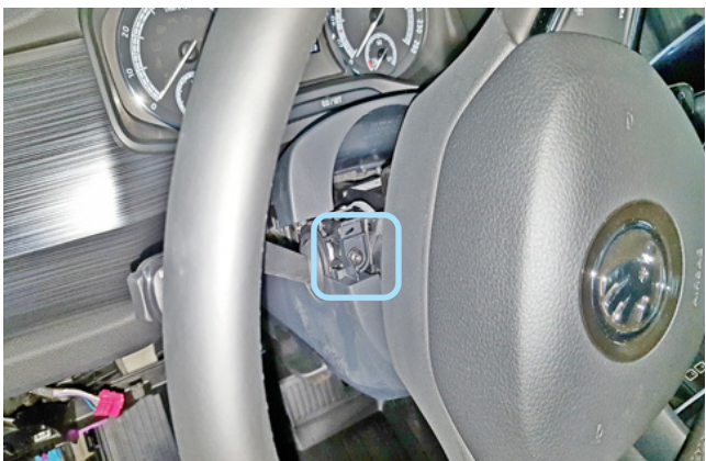
Фото 1.20. Винт крепления кожуха рулевого вала слева
