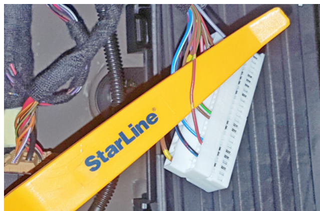
Фото 3.8. Альтернативное управление световыми сигналами (коричнево-красный)
