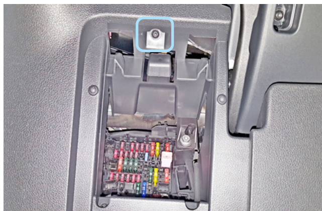
Фото 1.7. Карман для мелочей снят. Саморез
