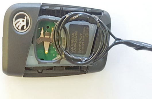
Фото 3.12. Расположение антенны на ключе
