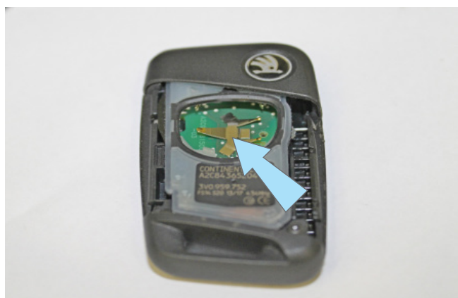
Фото 3.14. Контактная площадка (-) на плате ключа
