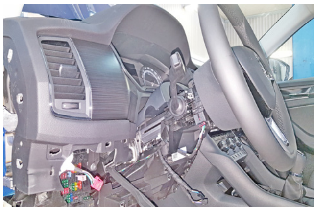
Фото 1.23. Кожух рулевого вала снят
