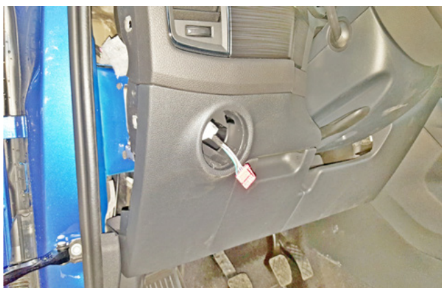
Фото 1.5. Переключатель света снят
