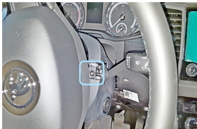
Фото 1.21. Винт крепления кожуха рулевого вала справа
