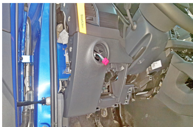
Фото 1.11. Снять левую часть накладки под рулевой колонкой
