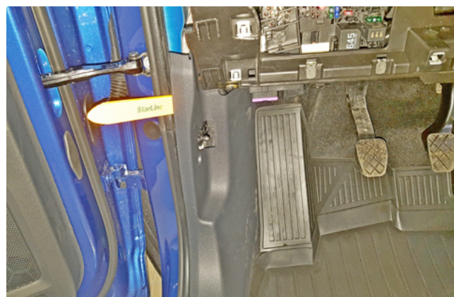
Фото 1.16. Снять пластиковую наладку левой кик-панели
