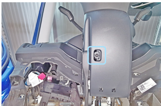
Фото 1.22. Винт крепления кожуха рулевого вала снизу
