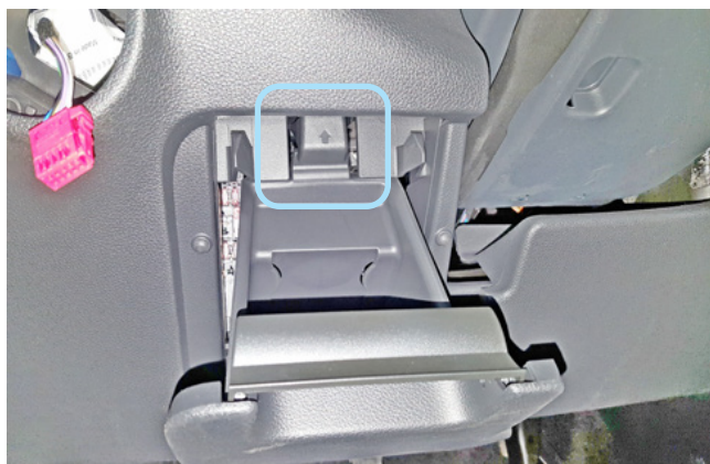
Фото 1.6. Фиксатор кармана для мелочей
