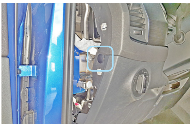
Фото 1.3. Левая боковая накладка передней панели снята. Клипса крепления
