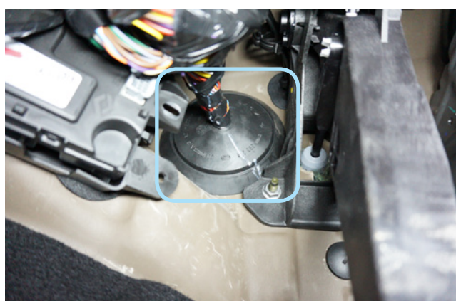
Фото 2.8. Штатный уплотнитель. Вид со стороны салона
