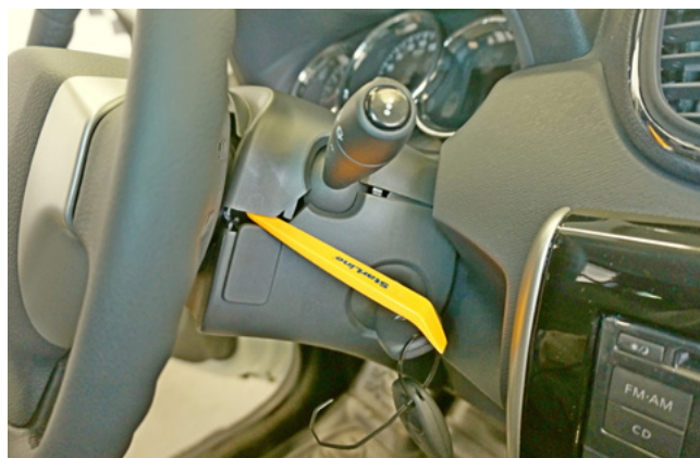
Фото 1.2. Снять верхнюю часть кожуха рулевого вала
