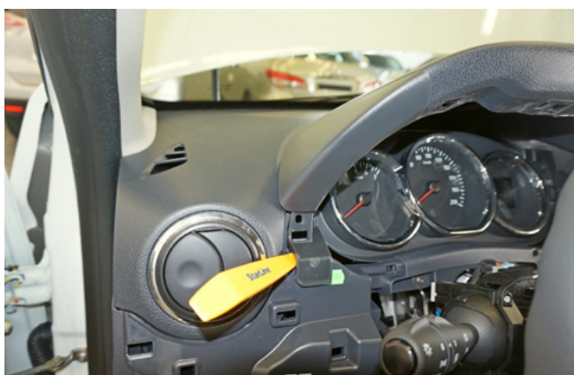
Фото 1.15. Снять накладку слева от панели приборов
