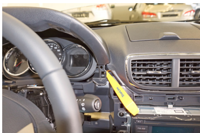
Фото 1.14. Снять накладку справа от панели приборов
