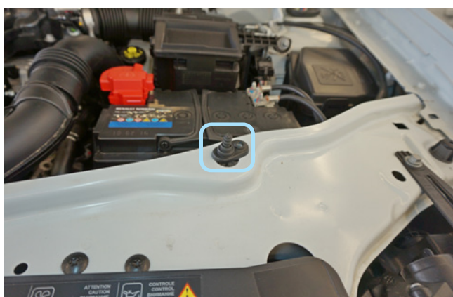
Фото 2.7. Возможное место установки концевика капота
