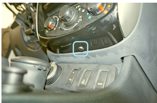
Фото 1.7. Клипса крепления декоративной накладки центральной консоли
