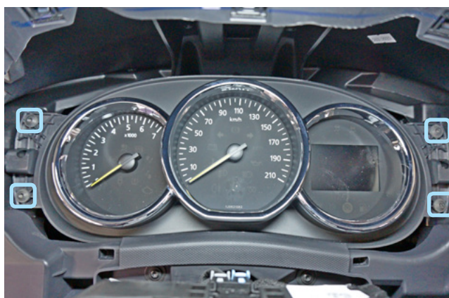
Фото 1.16. Саморезы крепления панели приборов
