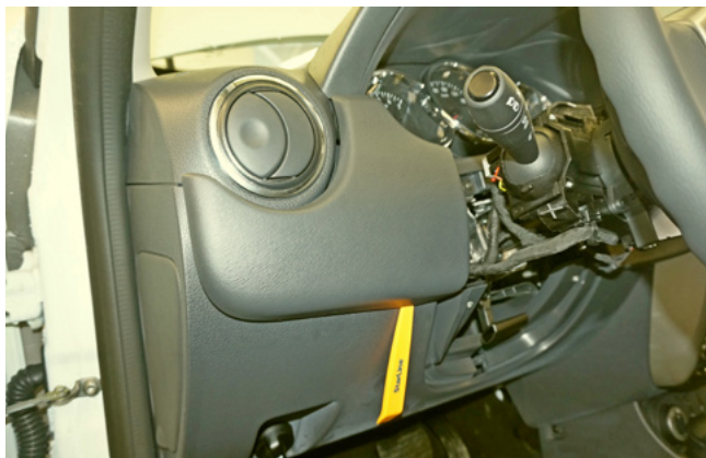
Фото 1.5. Снять пластиковую накладку слева от рулевой колонки
