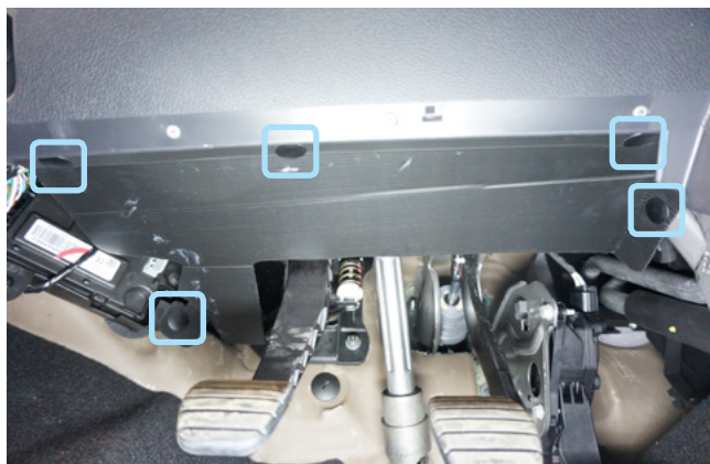
Фото 1.18. Клипсы крепления декоративной накладки
