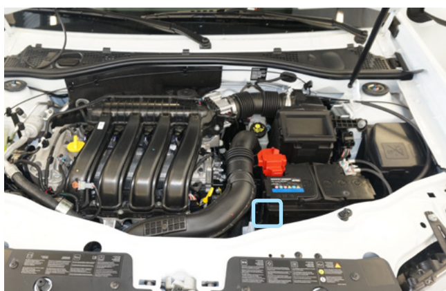
Фото 2.5. Место установки датчика температуры двигателя
