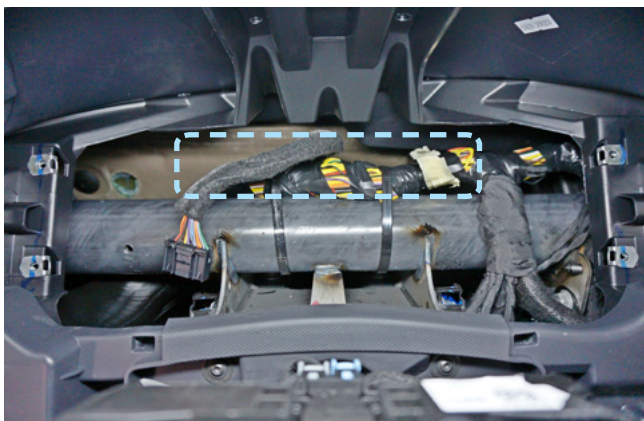
Фото 2.10. Пример расположения центрального блока охранно-телематического комплекса
