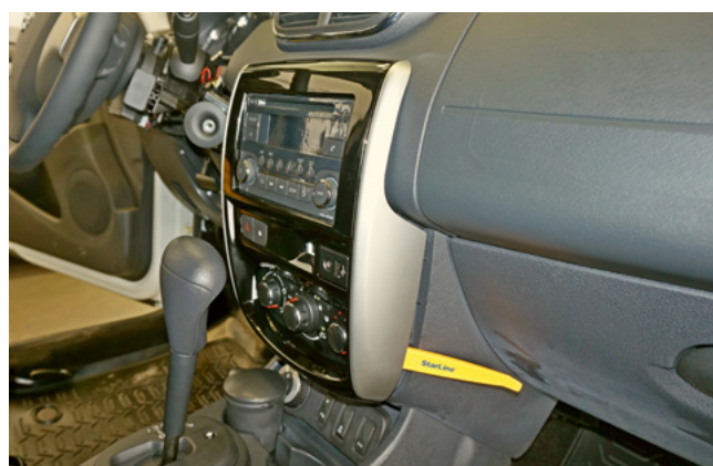
Фото 1.8. Снять накладку центральной консоли
