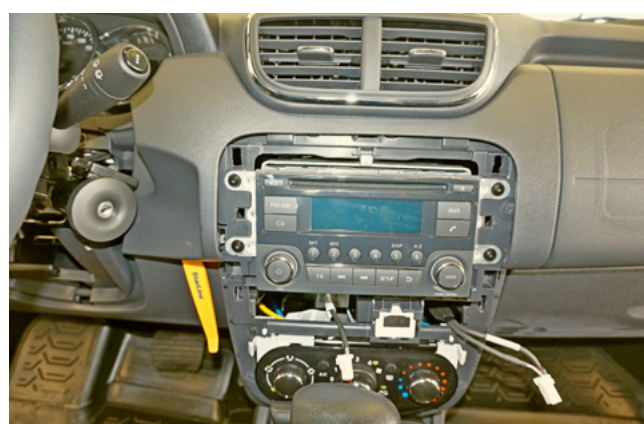
Фото 1.10. Снять накладку справа от рулевой колонки
