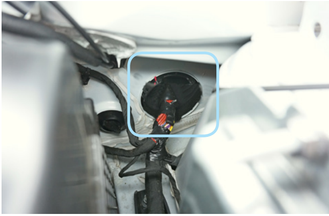
Фото 2.9. Штатный уплотнитель. Вид со стороны капота
