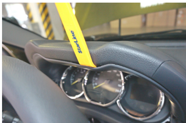
Фото 1.12. Снять накладку панели приборов
