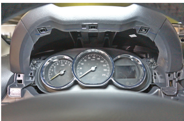
Фото 1.13. Накладка панели приборов снята
