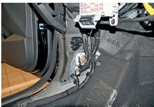
Фото 3.5. Накладка левой кик-панели снята
