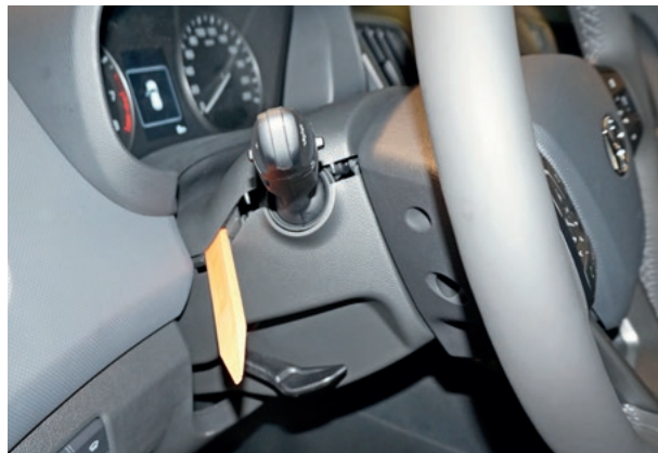
Фото 1.2. Снять верхнюю накладку кожуха рулевого вала
