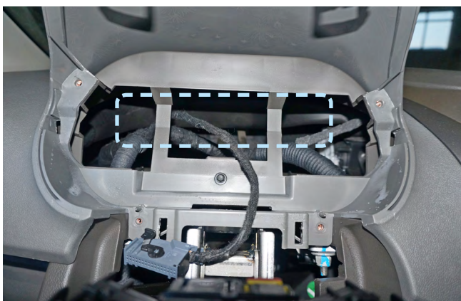
Фото 2.8. Пример расположения центрального блока охранно-телематического комплекса
