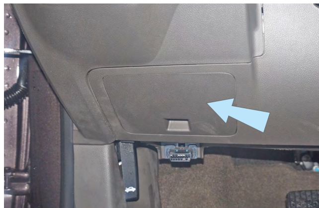
Фото 1.2. Крышка блока предохранителей
