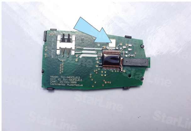
Фото 12.1. Контактная площадка (+) на плате ключа
