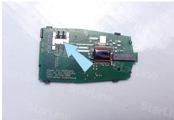
Фото 12.2. Контактная площадка (-) на плате ключа
