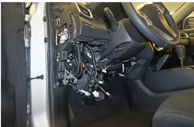
Фото 1.5. Пластиковая накладка под рулевой колонкой снята
