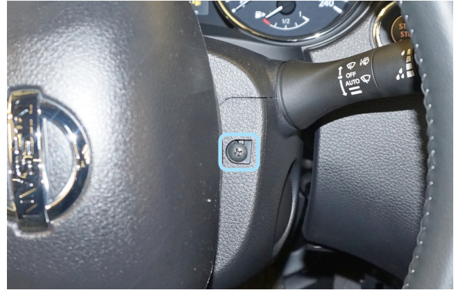
Фото 1.7. Саморез крепления кожуха рулевого вала справа
