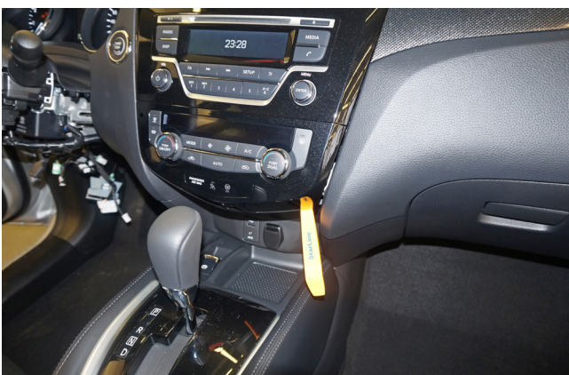
Фото 1.10. Снять блок управления климат-контролем
