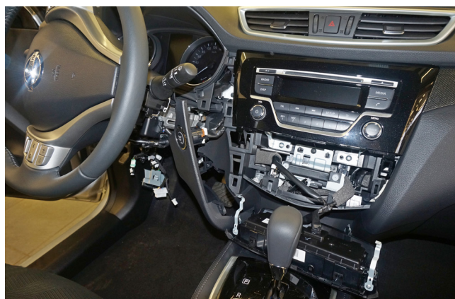
Фото 1.13. Пластиковая накладка снята
