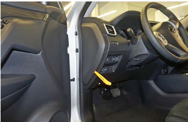
Фото 1.3. Снять боковую накладку передней панели
