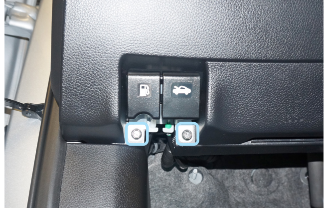
Фото 1.2. Болты крепления ручки отпирания капота
