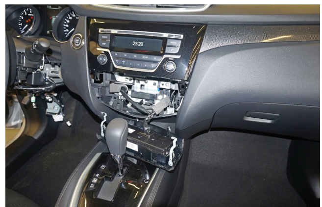
Фото 1.11. Блок управления климат-контролем снят
