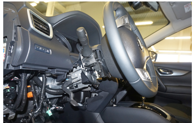
Фото 1.9. Нижняя часть кожуха рулевого вала снята
