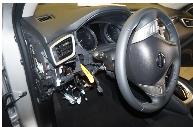
Фото 1.15. Накладка снята. Снять декоративную накладку панели приборов
