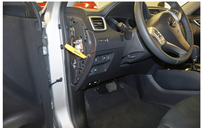
Фото 1.4. Боковая накладка снята. Снять пластиковую накладку под рулевой колонкой
