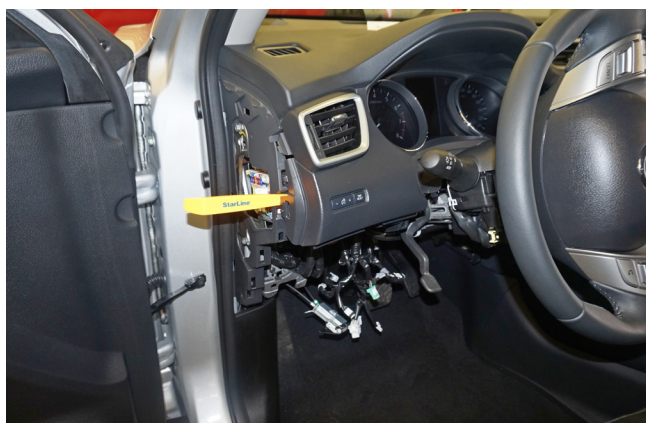
Фото 1.14. Снять пластиковую накладку слева от панели приборов
