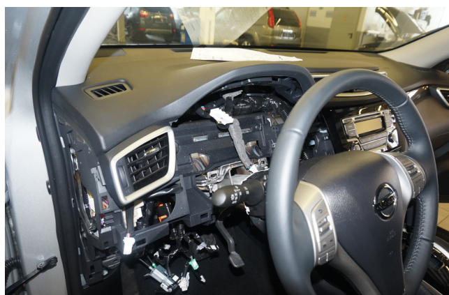
Фото 1.17. Панель приборов снята
