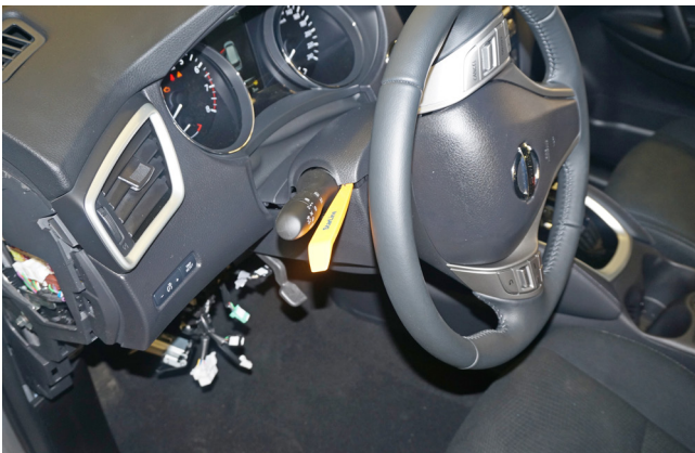
Фото 1.8. Снять нижнюю часть кожуха рулевого вала
