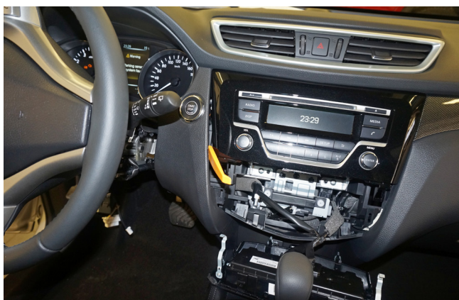
Фото 1.12. Снять пластиковую накладку справа от панели приборов
