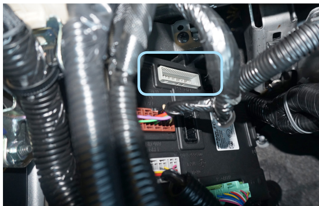
Фото 3.4. Местоположение серого разъёма блока BCM
