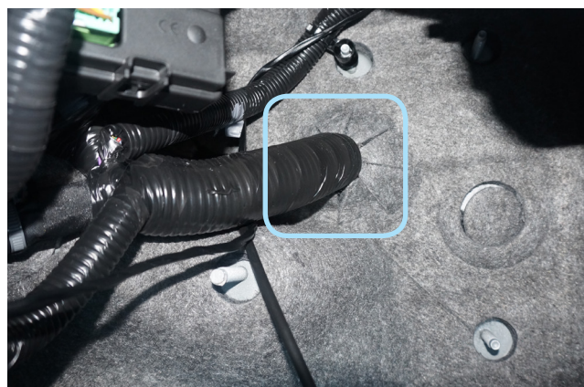
Фото 2.10. Штатный уплотнитель. Вид со стороны салона
