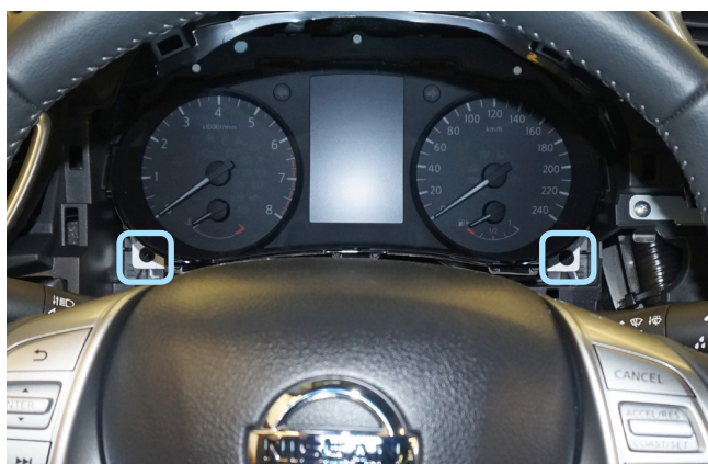
Фото 1.16. Саморезы крепления панели приборов
