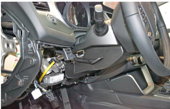
Фото 1.9. Кожух рулевого вала. Общий вид
