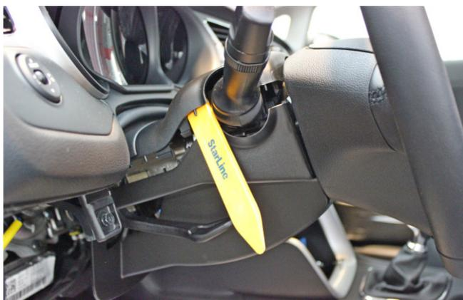
Фото 1.13. Снять верхнюю часть кожуха рулевого вала
