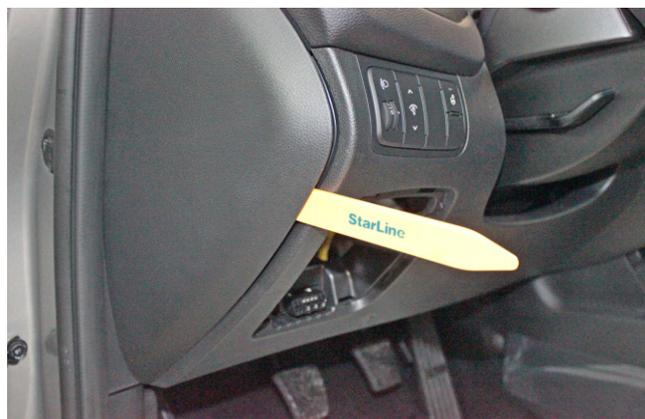
Фото 1.2. Снять левую накладку передней панели
