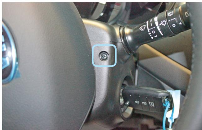
Фото 1.11. Саморез крепления кожуха рулевого вала справа
