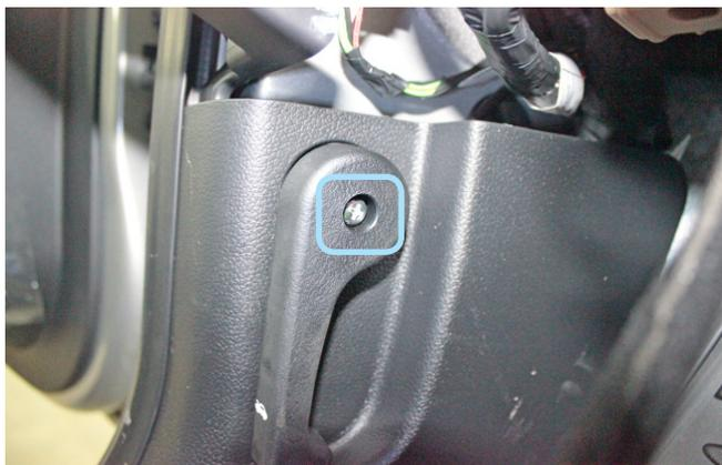
Фото 1.7. Винт крепления ручки отпирания капота
