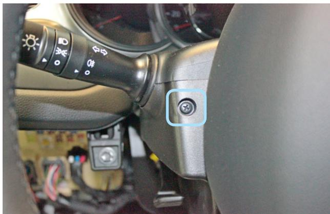
Фото 1.10. Саморез крепления кожуха рулевого вала слева
