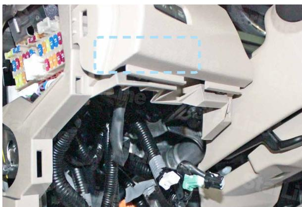
Фото 5. Пример расположения центрального блока охранно-телематического комплекса
