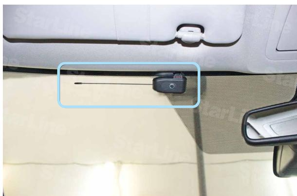
Фото 3.1. Возможное место установки антенного модуля
