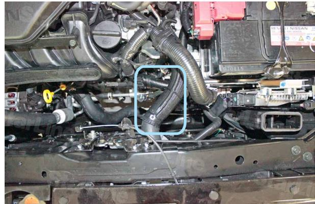
Фото 4.6. Датчик температуры двигателя
