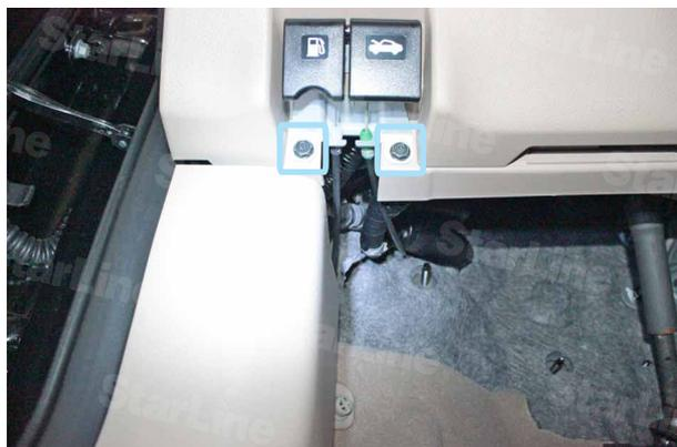
Фото 1.2. Болты крепления ручки отпирания капота
