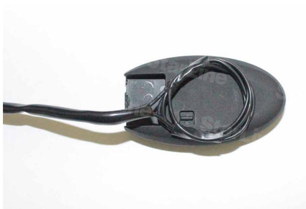
Фото 9.1. Расположение антенны модуля BP-03 на ключе
