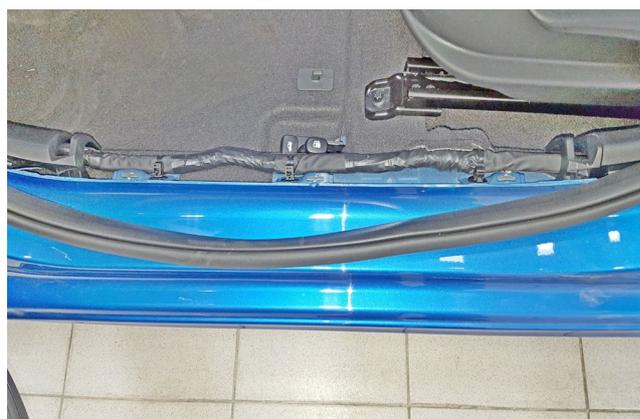
Фото 1.4. Накладка порога двери водителя снята
