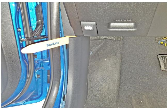
Фото 1.5. Снять накладку левой кик-панели
