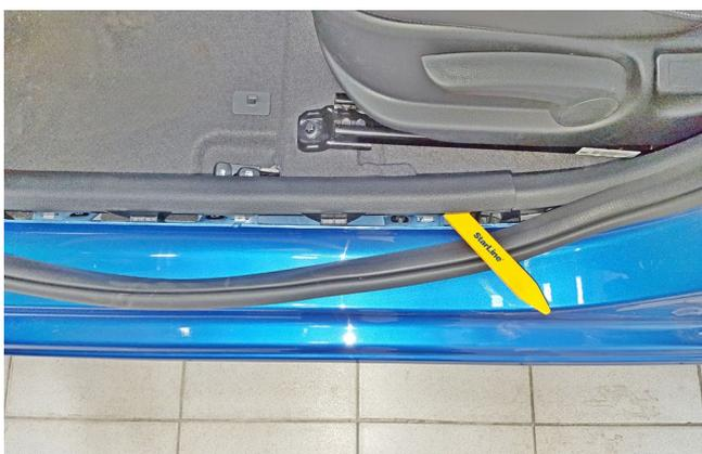
Фото 1.3. Снять накладку порога двери водителя
