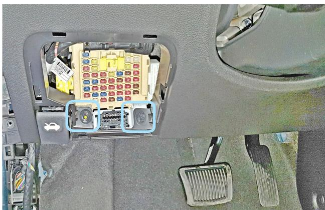
Фото 1.9. Болты крепления пластиковой накладки под рулевой колонкой
