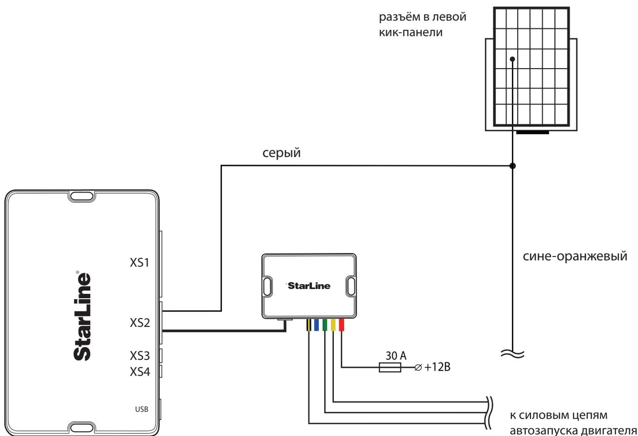
Схема 1. Подключение цепей автозапуска двигателя и обхода штатного иммобилайзера
