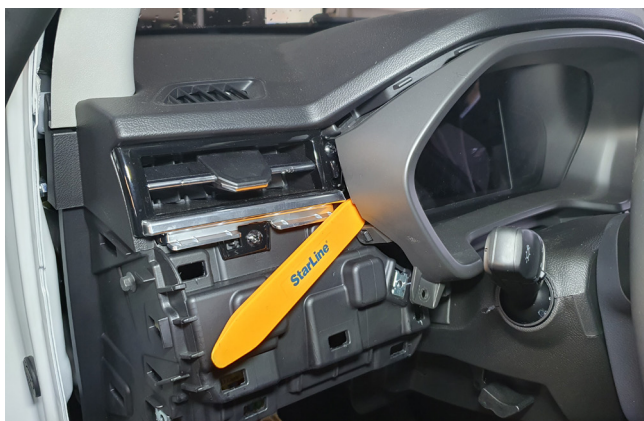
Фото 1.19. Снять накладку панели приборов
