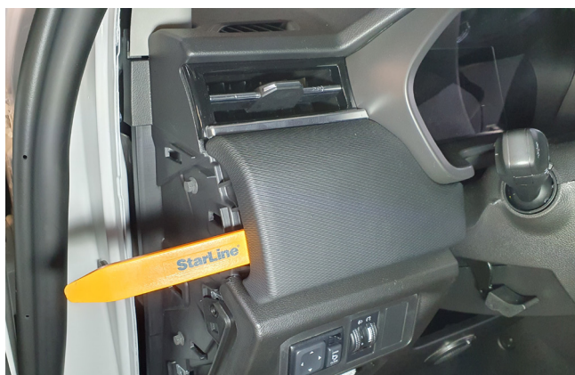
Фото 1.5. Снять накладку слева от рулевой колонки
