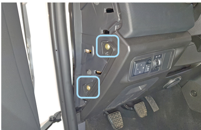
Фото 1.3. Саморезы крепления накладки под рулевой колонкой
