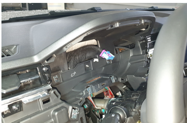
Фото 1.23. Панель приборов снята
