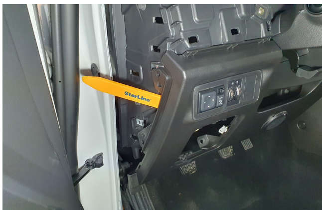
Фото 1.13. Снять пластиковую накладку под рулевой колонкой
