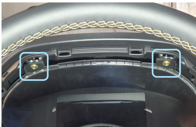
Фото 1.21. Саморезы крепления панели приборов сверху
