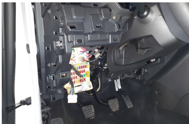
Фото 1.14. Пластиковая накладка под рулевой колонкой снята
