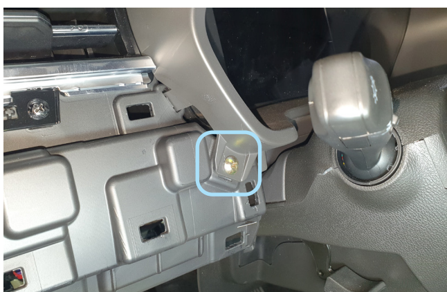
Фото 1.17. Саморез крепления накладки панели приборов слева
