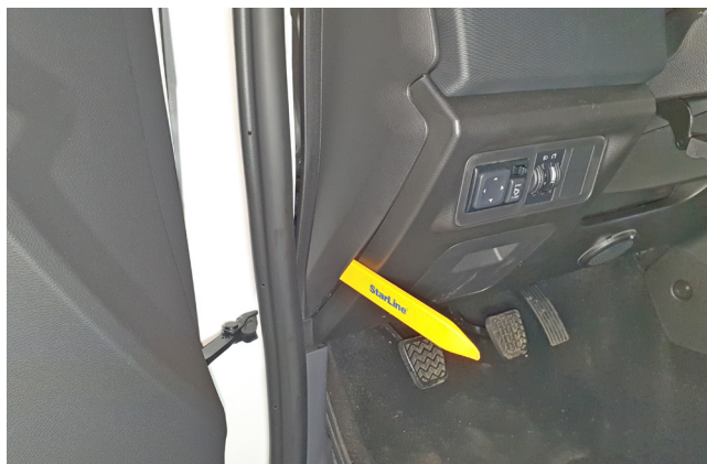
Фото 1.2. Снять левую боковую накладку передней панели
