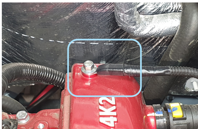
Фото 2.5. Крепление датчика температуры двигателя
