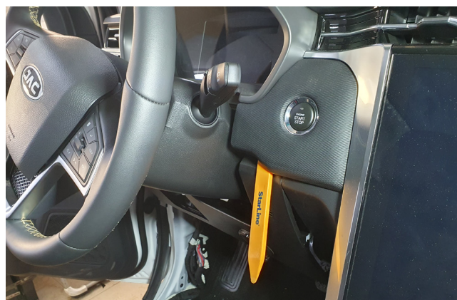
Фото 1.6. Снять накладку справа от рулевой колонки
