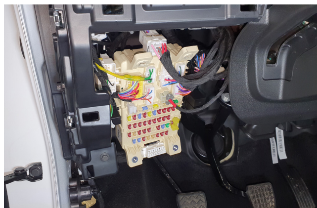
Фото 1.16. Монтажный блок предохранителей снят
