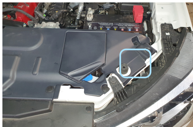
Фото 2.6. Возможное место установки концевика капота
