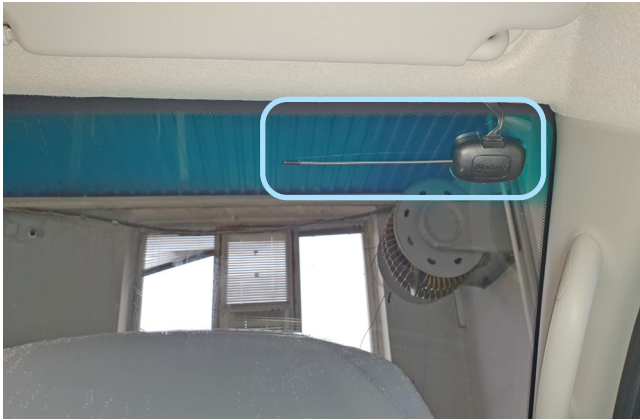
Фото 2.1. Возможное место установки антенного модуля
