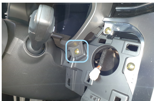
Фото 1.18. Саморез крепления накладки панели приборов справа
