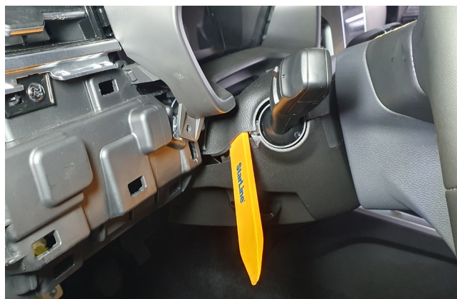
Фото 1.20. Снять верхнюю часть кожуха рулевого вала
