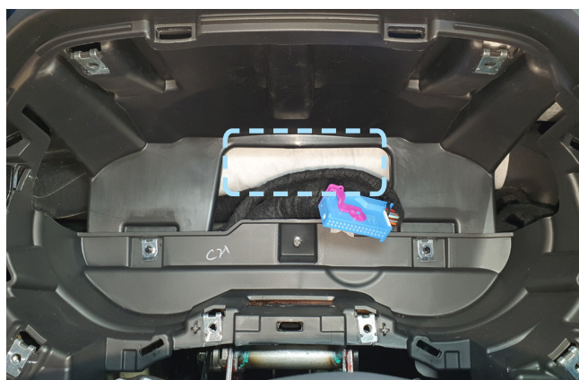
Фото 2.8. Пример расположения центрального блока охранно-телематического комплекса
