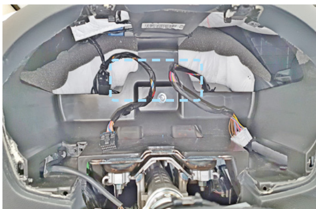
Фото 2.8. Пример расположения центрального блока охранно-телематического комплекса
