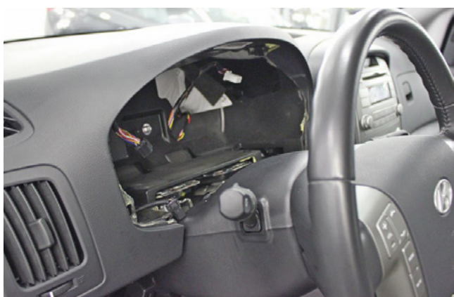
Фото 1.11. Панель приборов снята
