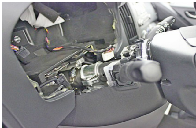
Фото 1.15. Верхняя часть кожуха снята
