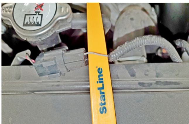
Фото 2.6. Контроль концевика капота (серый)
