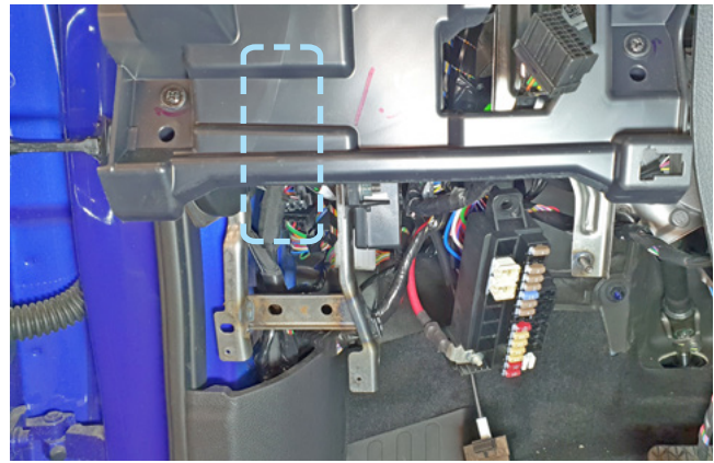
Фото 2.7. Пример расположения центрального блока охранно-телематического комплекса
