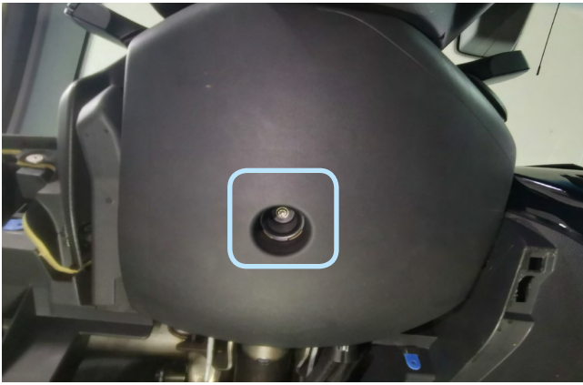
Фото 1.13. Саморез крепления нижней накладки
