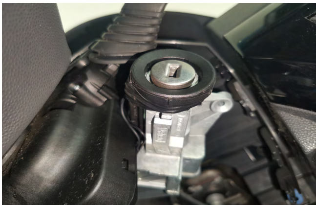
Фото 3.11. Расположение антенны модуля VP-03/04 на замке зажигания
