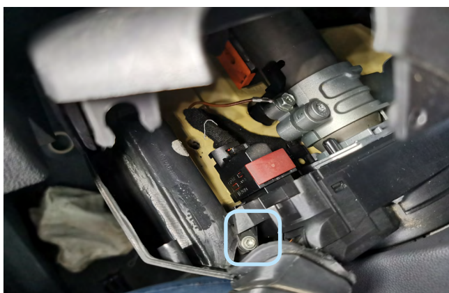
Фото 1.11. Саморез крепления нижней накладки
