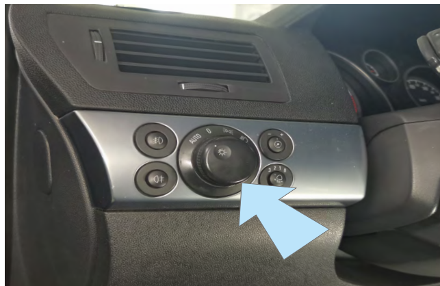
Фото 1.2. Блок переключателя света
