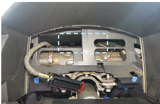
Фото 2.8. Пример расположения центрального блока охранно-телематического комплекса
