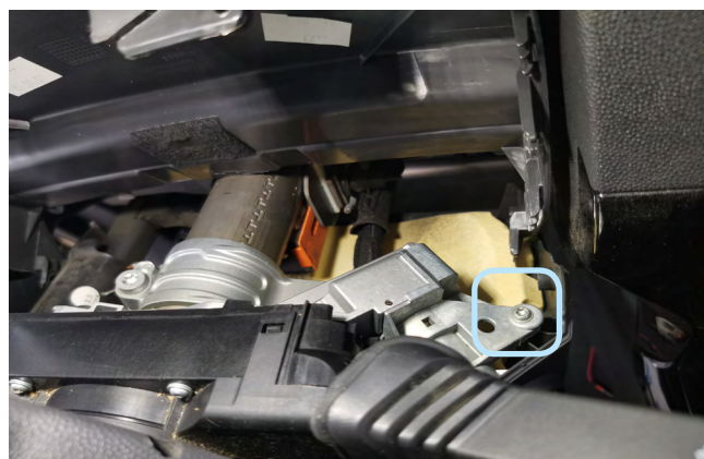
Фото 1.12. Саморез крепления нижней накладки
