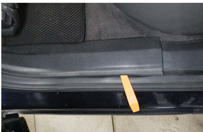
Фото 1.16. Снять накладку порога с левой стороны
