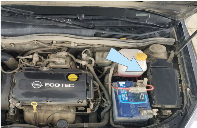
Фото 2.7. Возможное место установки подкапотного блока R6
