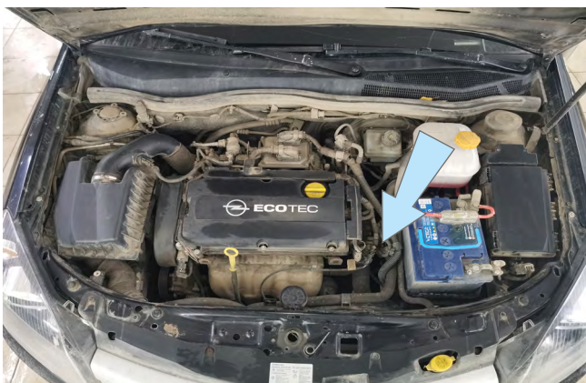
Фото 2.4. Место установки датчика температуры двигателя
