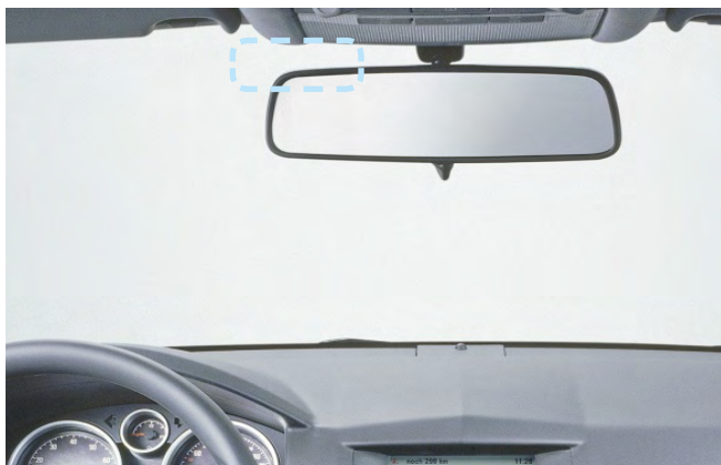
Фото 2.1. Возможное место установки антенного модуля
