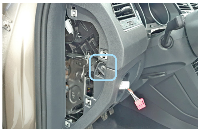
Фото 1.12. Левая боковая накладка передней панели снята. Саморез
