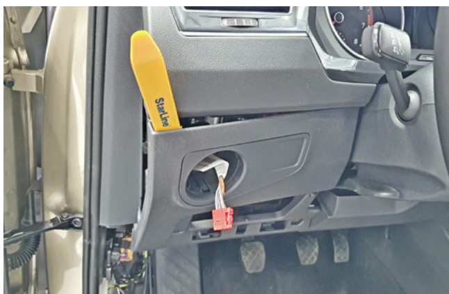
Фото 1.13. Снять накладку слева от рулевой колонки
