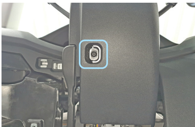
Фото 1.23. Винт крепления нижней части кожуха рулевого вала снизу
