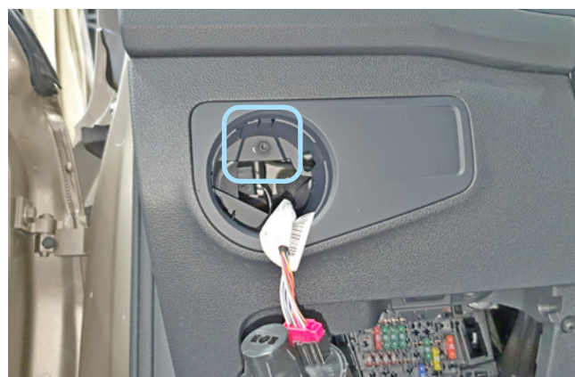
Фото 1.10. Переключатель света снят. Саморез
