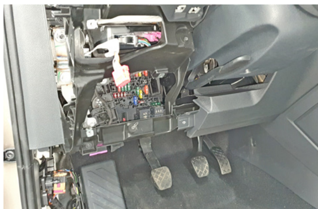
Фото 1.14. Накладка слева от рулевой колонки снята
