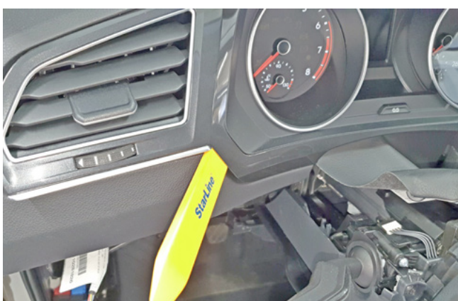
Фото 1.17. Снять декоративную накладку панели приборов
