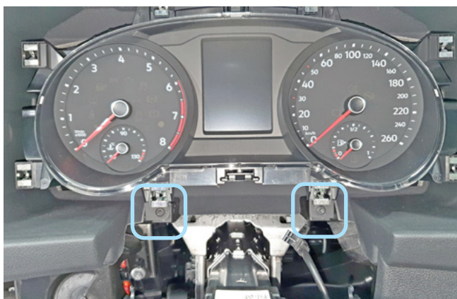
Фото 1.19. Накладка снята. Саморезы крепления панели приборов
