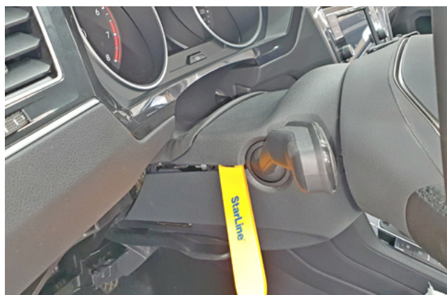
Фото 1.16. Снять верхнюю часть кожуха рулевого вала
