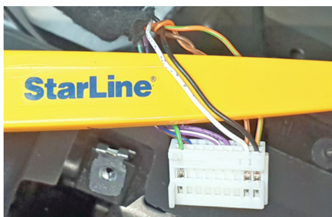
Фото 3.15. Провода антенны штатного иммобилайзера (чёрный и белый)
