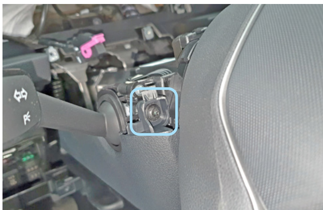
Фото 1.21. Винт крепления нижней части кожуха рулевого вала слева
