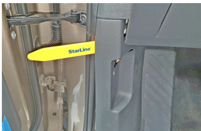
Фото 1.5. Снять пластиковую накладку левой кик-панели
