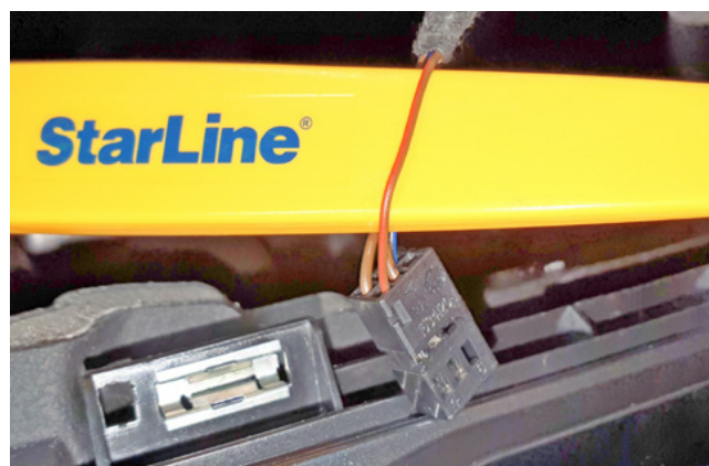
Фото 3.7. Альтернативное управление световыми сигналами (коричнево-красный)
