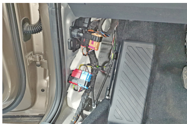
Фото 1.6. Пластиковая накладка левой кик-панели снята
