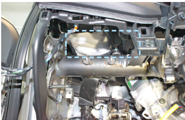
Фото 2.8. Пример расположения центрального блока охранно-телематического комплекса
