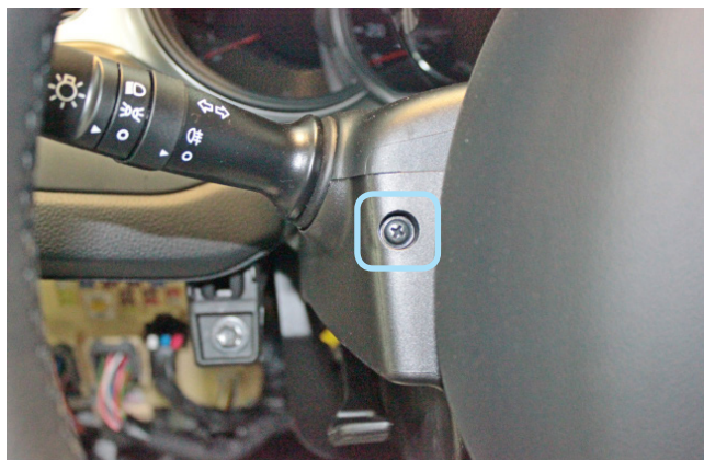
Фото 1.10. Саморез крепления кожуха рулевого вала слева
