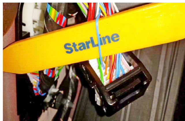
Фото 3.7. Шина данных штатного иммобилайзера (синий)
