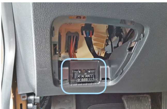
Фото 3.4. Местоположение диагностического разъёма
