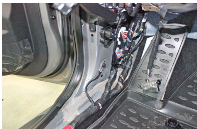
Фото 1.8. Накладка кик-панели снята
