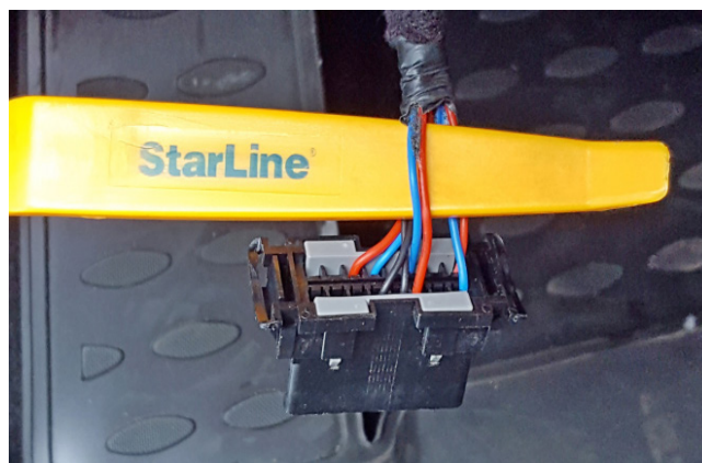
Фото 3.5. Шина CAN-B (красный и синий)
