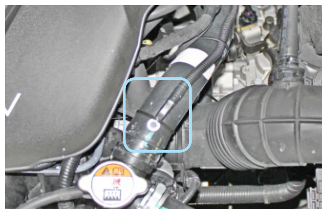
Фото 2.6. Крепление датчика температуры двигателя
