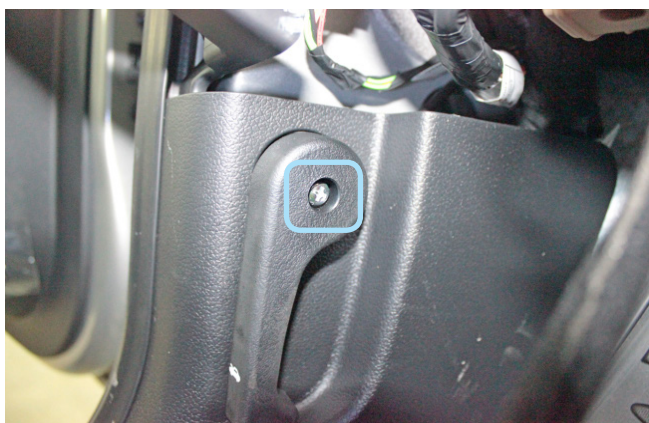
Фото 1.7. Винт крепления ручки отпирания капота
