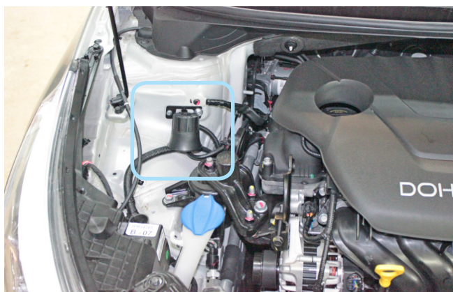
Фото 2.3. Возможное место установки сирены
