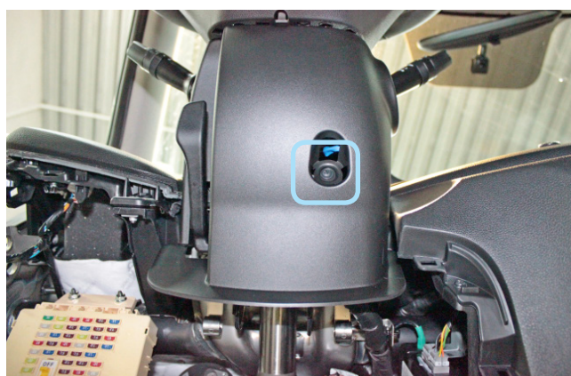
Фото 1.12. Саморез крепления кожуха рулевого вала снизу
