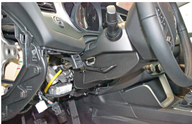
Фото 1.9. Кожух рулевого вала. Общий вид
