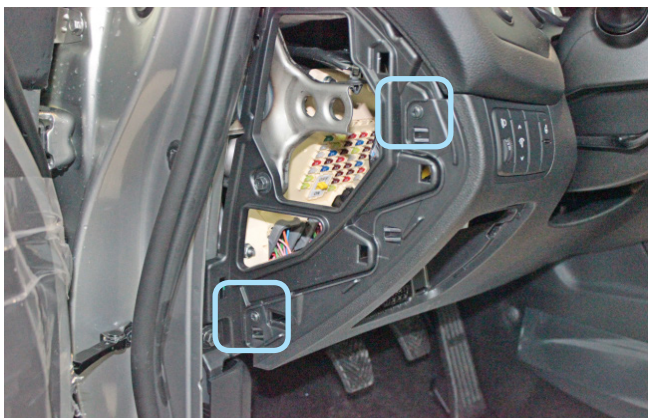
Фото 1.3. Накладка снята. Саморезы
