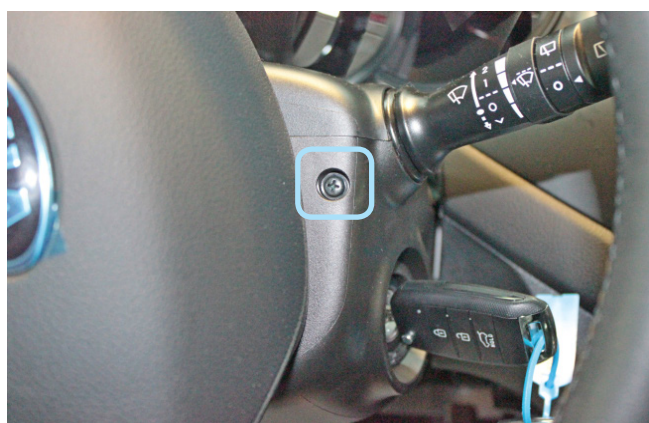
Фото 1.11. Саморез крепления кожуха рулевого вала справа
