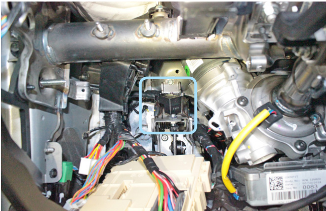
Фото 3.10. Местоположение разъёма педали сцепления
