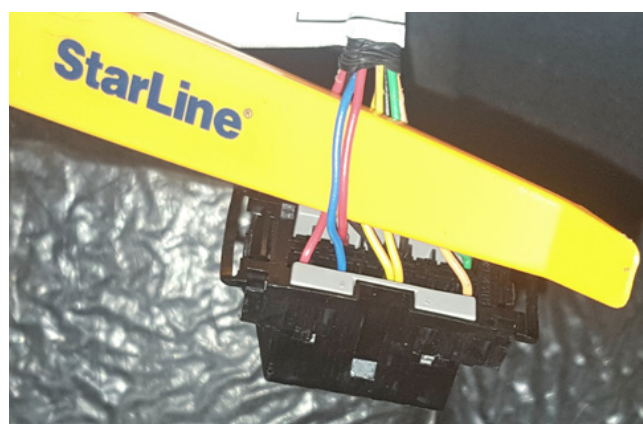
Фото 3.5. CAN-шина (красный и синий)
