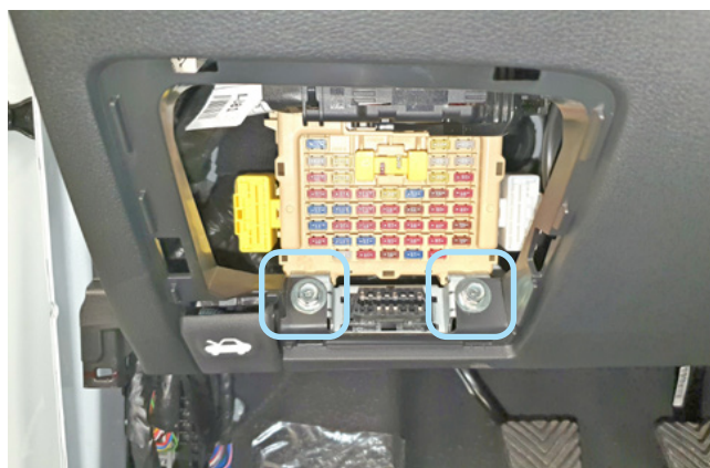
Фото 1.8. Болты крепления пластиковой накладке под рулевой колонкой
