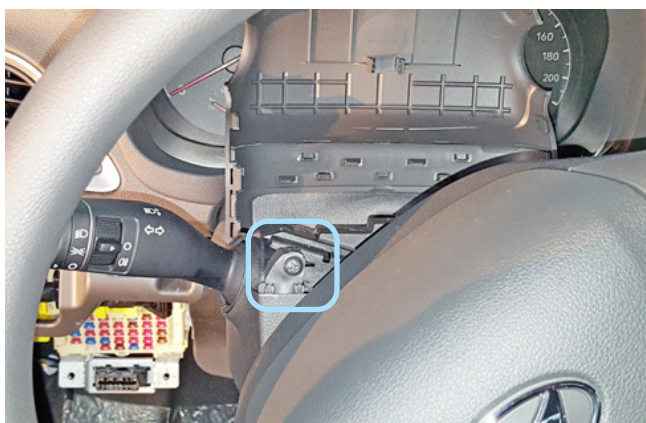
Фото 1.13. Саморез крепления нижней части кожану рулевого вала слева
