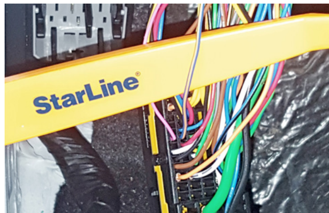
Фото 3.7. Шина данных штатного иммобилайзера (сине-оранжевый)
