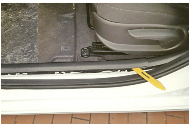
Фото 1.3. Снять накладку порога двери водителя
