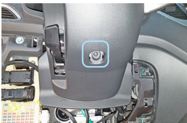
Фото 1.15. Саморез крепления нижней части кожану рулевого вала снизу
