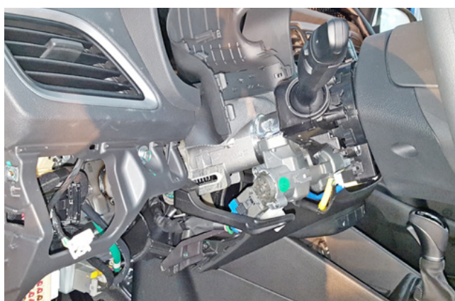
Фото 1.16. Кожух рулевого вала снят
