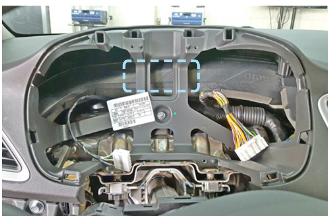
Фото 2.9. Пример расположения центрального блока охранно-телематического комплекса
