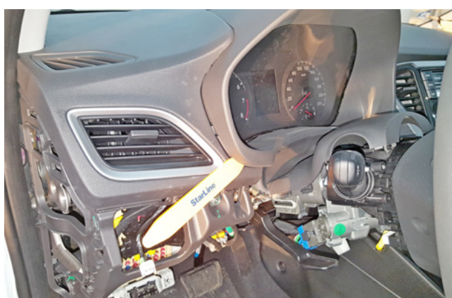
Фото 1.18. Снять накладку панели приборов
