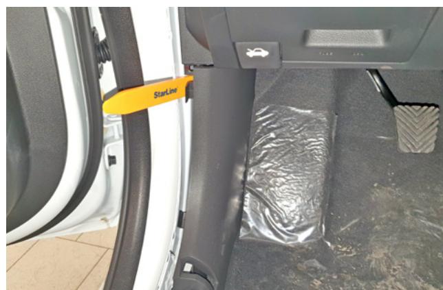
Фото 1.4. Снять накладку левой кик-панели
