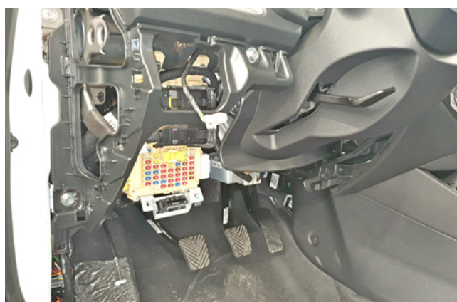
Фото 1.10. Пластиковая накладке под рулевой колонкой снята
