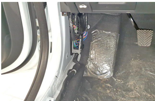
Фото 1.5. Накладка левой кик-панели снята
