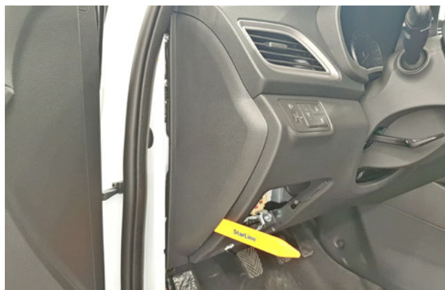
Фото 1.6. Снять левую боковую накладку передней панели
