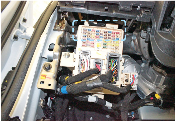
Фото 4. Пример расположения центрального блока охранно-телематического комплекса
