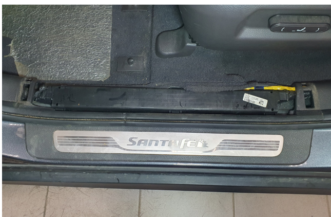
Фото 1.5. Накладка порога двери водителя снята
