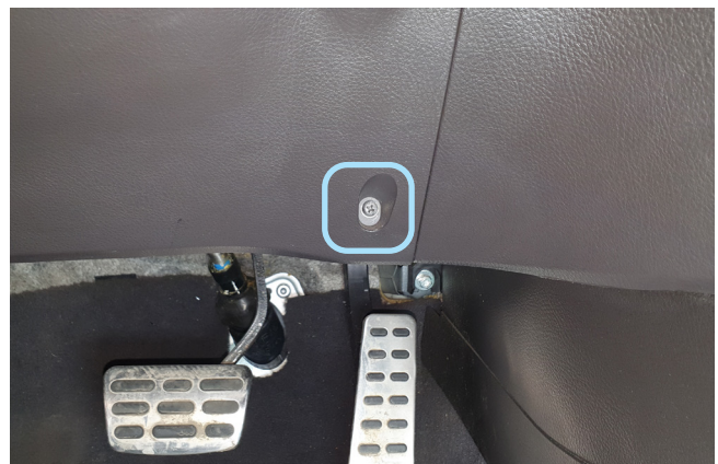
Фото 1.10. Саморез крепления накладки под рулевой колонкой
