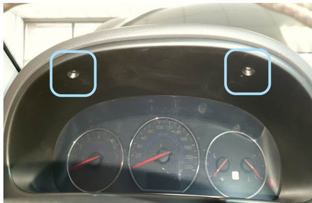
Фото 1.14. Саморезы крепления накладки панели приборов
