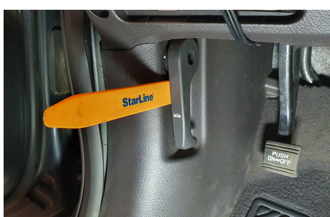
Фото 1.6. Снять ручку отпирания капота
