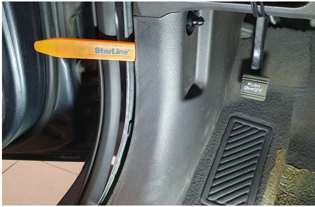
Фото 1.7. Снять накладку левой кик-панели
