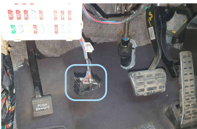
Фото 3.2. Местоположение диагностического разъёма
