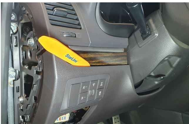
Фото 1.11. Снять пластиковую накладку под рулевой колонкой
