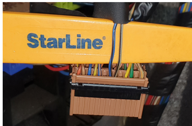
Фото 3.11. Управление центральным замком (синечёрный и серо-чёрный)
