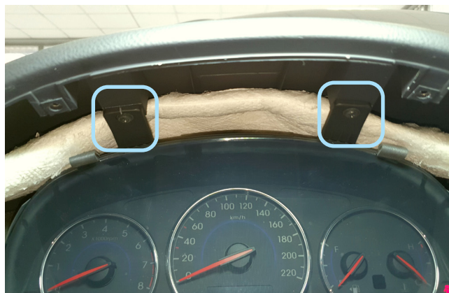
Фото 1.16. Саморезы крепления панели приборов сверху
