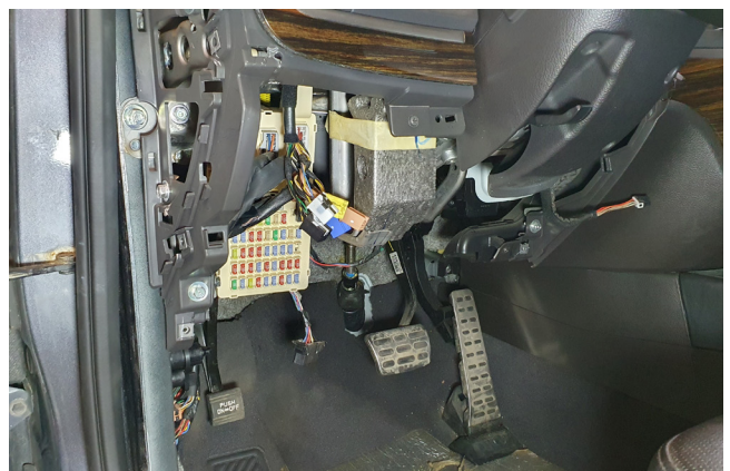
Фото 1.12. Пластиковая накладка под рулевой колонкой снята
