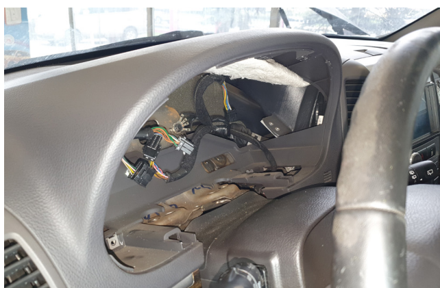
Фото 1.18. Панель приборов снята
