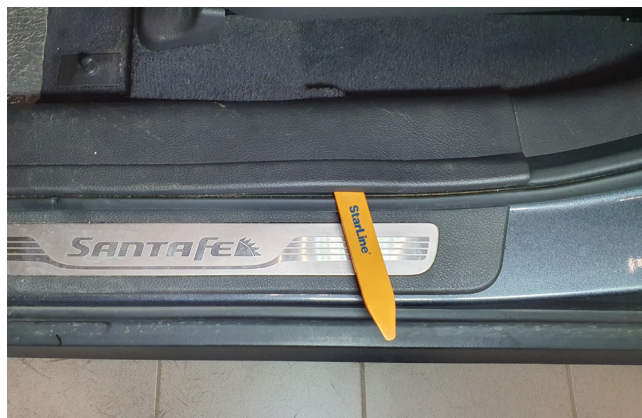
Фото 1.4. Снять накладку порога двери водителя
