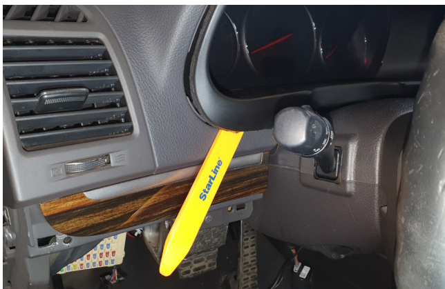
Фото 1.15. Снять накладку панели приборов
