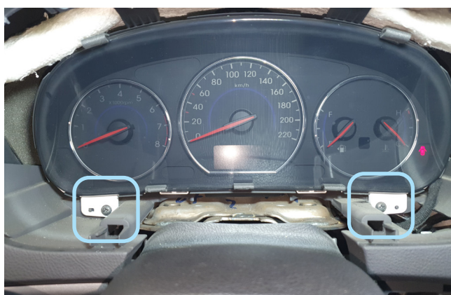
Фото 1.17. Саморезы крепления панели приборов снизу
