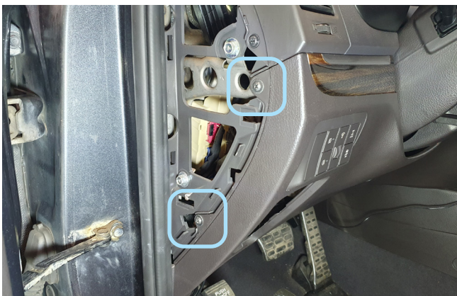
Фото 1.3. Накладка снята. Саморезы
