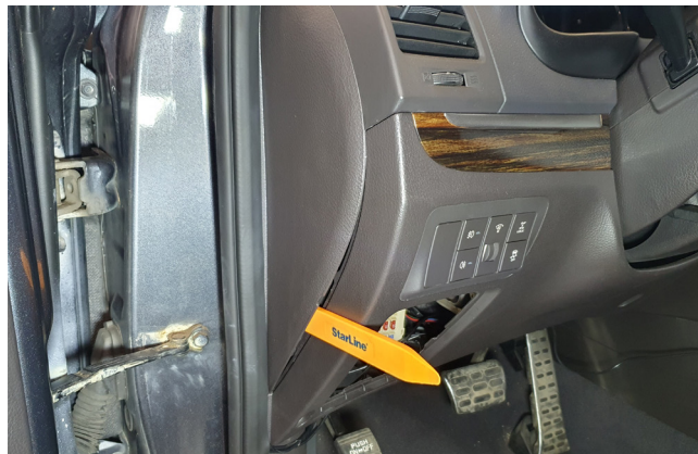
Фото 1.2. Снять левую боковую накладку передней панели
