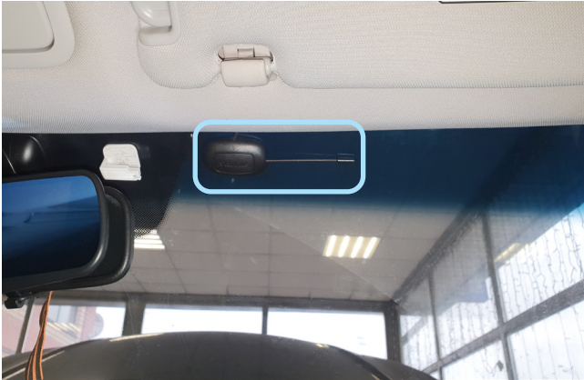
Фото 2.1. Возможное место установки антенного модуля
