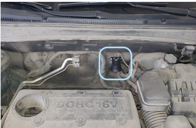
Фото 2.2. Возможное место установки сирены
