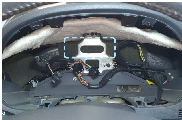
Фото 2.7. Пример расположения центрального блока охранно-телематического комплекса
