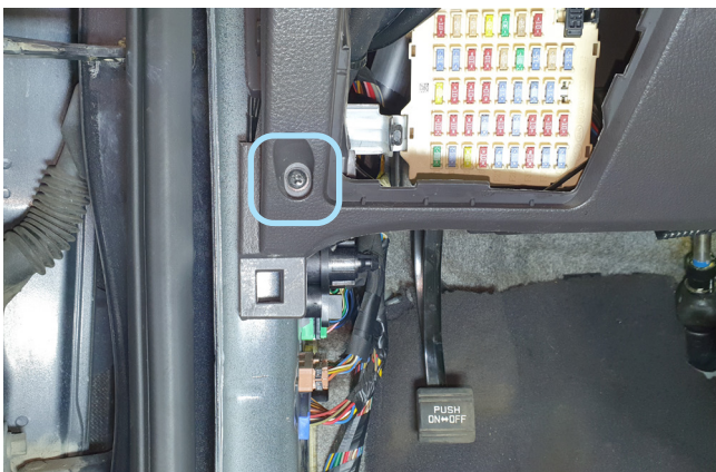
Фото 1.9. Саморез крепления накладки под рулевой колонкой
