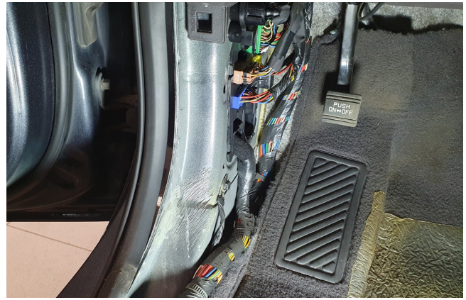
Фото 1.8. Накладка левой кик-панели снята
