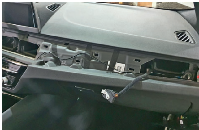
Фото 1.20. Накладка передней панели снята
