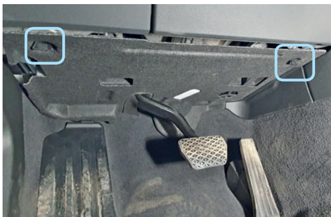
Фото 1.13. Фиксаторы крепления накладки педального узла
