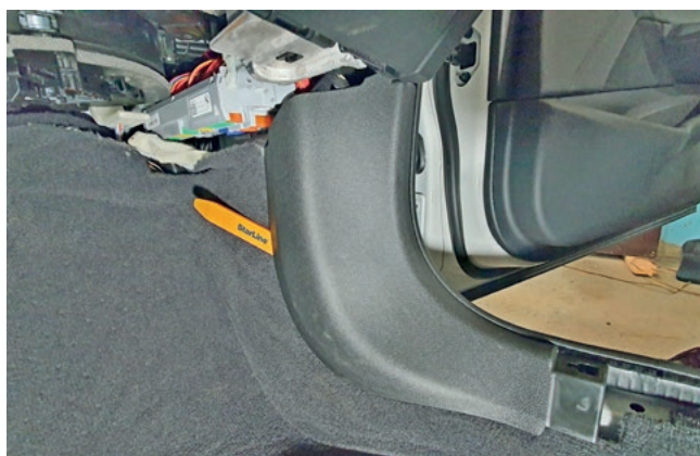
Фото 1.5. Снять накладку левой кик-панели
