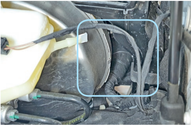
Фото 2.5. Штатный уплотнитель. Вид со стороны капота
