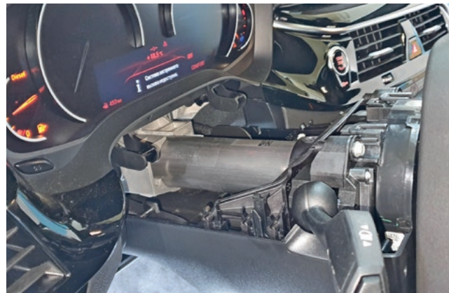
Фото 1.8. Верхняя часть кожуха рулевого вала снята.
