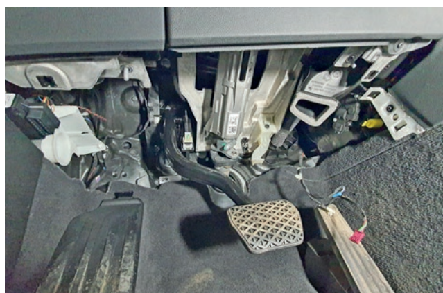
Фото 1.14. Накладка педального узла снята
