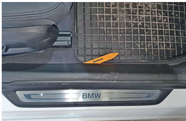
Фото 1.1. Снять накладку порога передней правой двери
