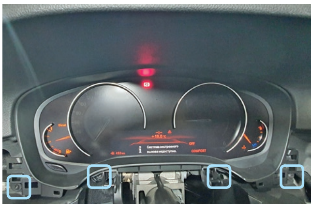
Фото 1.24. Саморезы крепления панели приборов
