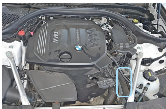
Фото 2.3. Место установки датчика температуры двигателя
