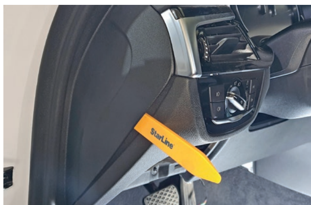
Фото 1.11. Снять левую накладку передней панели
