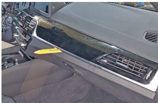
Фото 1.19. Снять накладку передней панели
