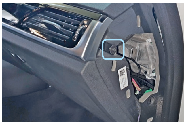
Фото 1.18. Правая накладка передней панели снята. Саморез крепления
