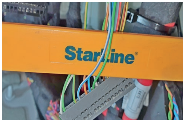
Фото 3.6. Управление кнопкой Старт-Стоп (бело-синий и зелёный)
