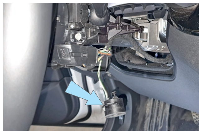
Фото 1.10. Кожух рулевого вала снят. Местоположение антенны штатного иммобилайзера
