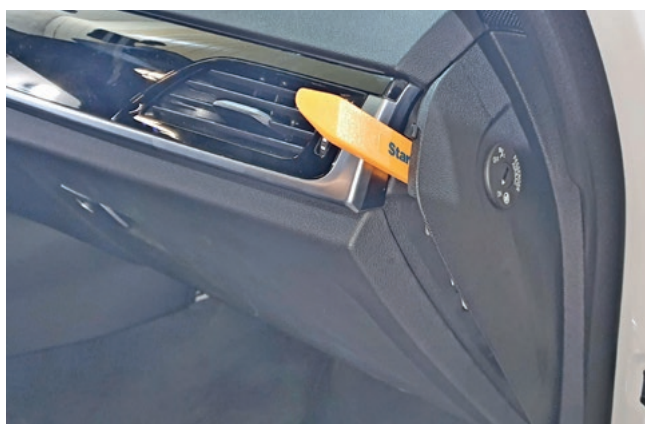
Фото 1.17. Снять правую накладку передней панели
