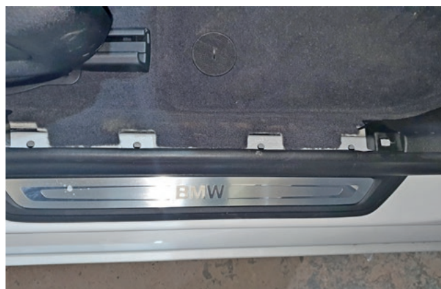
Фото 1.2. Накладка порога передней правой двери снята
