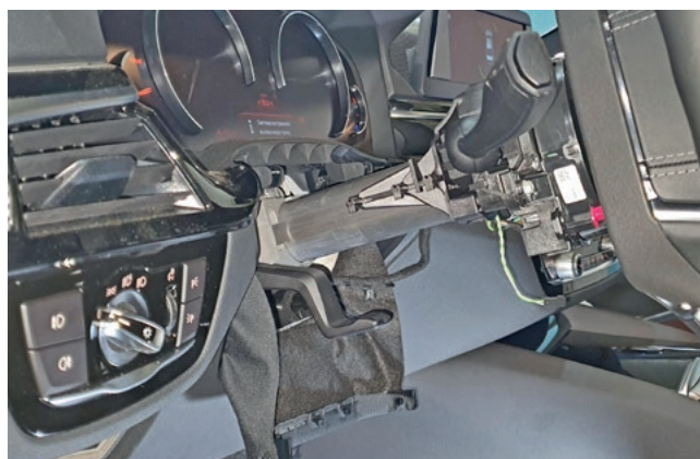
Фото 1.9. Нижняя часть кожуха рулевого вала снята
