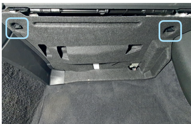
Фото 1.3. Фиксаторы крепления накладки под перчаточным ящиком
