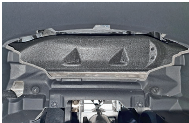
Фото 1.25. Панель приборов снята
