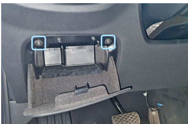
Фото 1.15. Саморезы крепления ящика для мелочей
