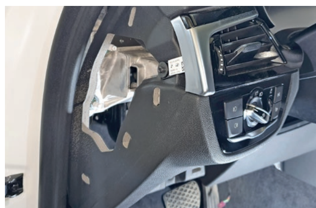
Фото 1.12. Левая накладка передней панели снята
