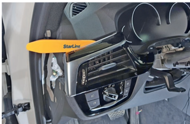
Фото 1.22. Снять накладку слева от панели приборов
