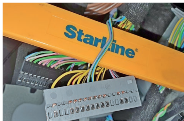
Фото 3.4. Шина CAN-B (серо-зелёный и сине-жёлтый)
