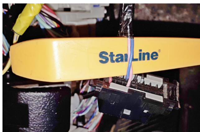
Фото 3.5. Шина CAN-B (синий и розовый)
