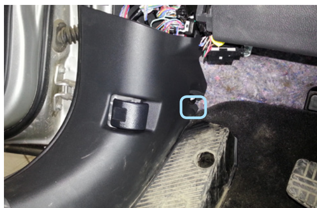
Фото 1.10. Крепление накладки левой кик-панели
