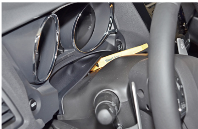
Фото 1.11. Снять пылезащитный кожух рулевой колонки
