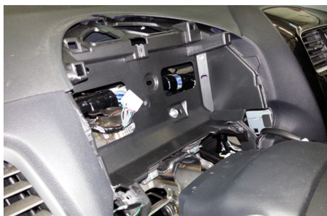
Фото 1.14. Панель приборов снята
