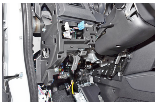
Фото 1.8. Пластиковая накладка под рулевой колонкой снята
