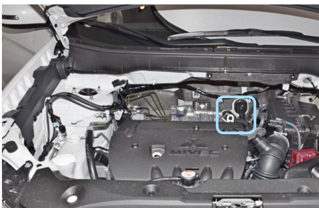
Фото 2.5. Место установки датчика температуры двигателя
