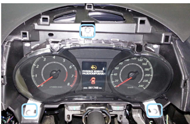
Фото 1.13. Саморезы крепления панели приборов
