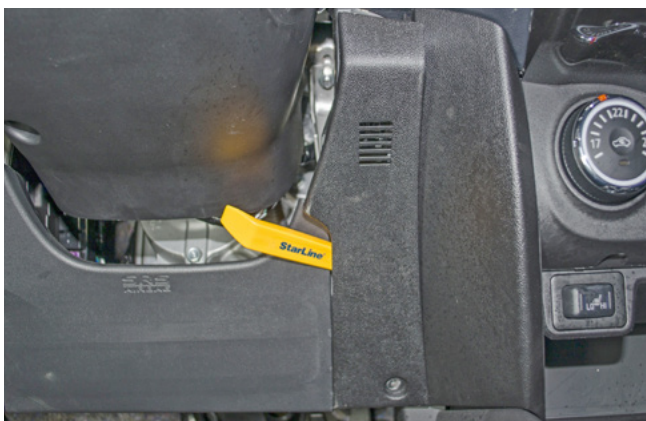
Фото 1.5. Снять правую накладку
