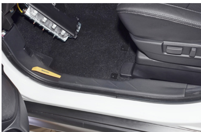
Фото 1.9. Снять накладку порога двери водителя
