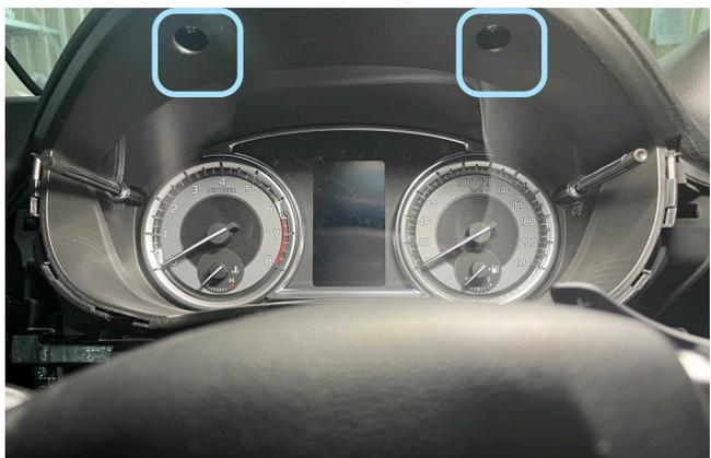
Фото 1.9. Саморезы крепления декоративной накладки панели приборов
