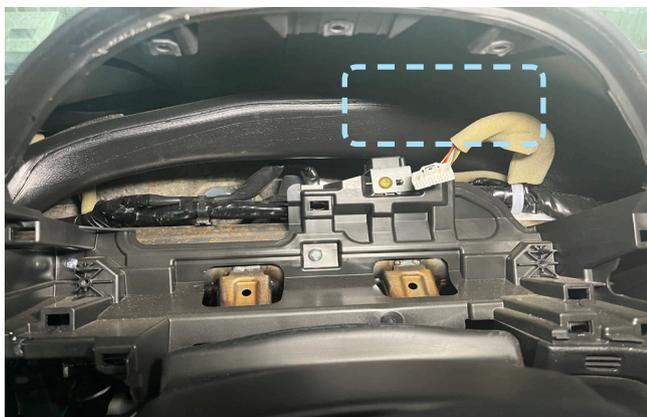
Фото 2.9. Пример расположения центрального блока охранно-телематического комплекса
