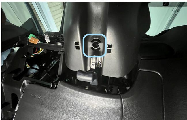
Фото 1.13. Саморез крепления кожуха рулевого вала
