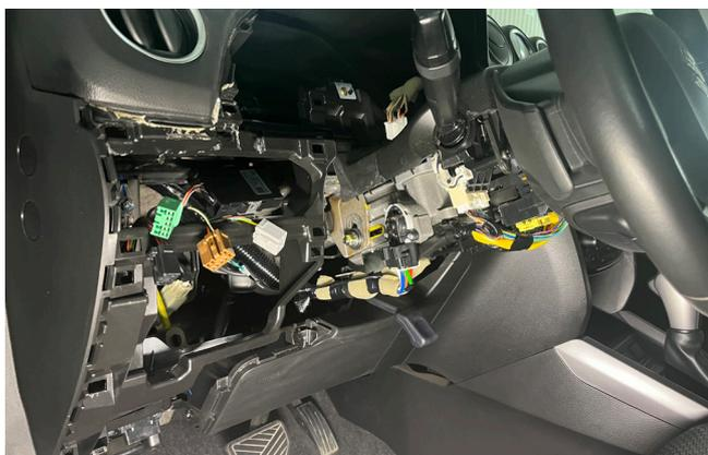
Фото 1.15. Кожух рулевого вала снята
