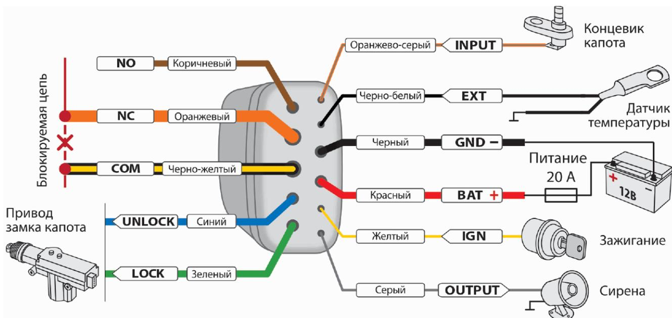
Центральный блок охранно-телематического комплекса StarLine закрепить на пластиковые стяжки за Панели приборов. **Внимание!!! Не размещайте центральный блок на расстоянии менее 10 см от металлических частей кузова автомобиля во избежание плохого качества приёма сигнала GSM и Bluetooth!**
