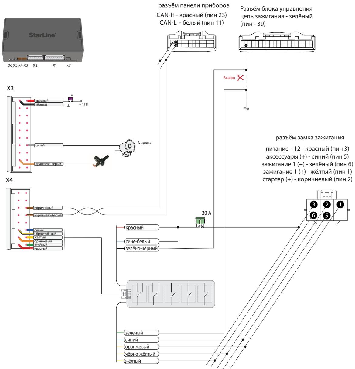
Схема 1. Общая схема подключения
