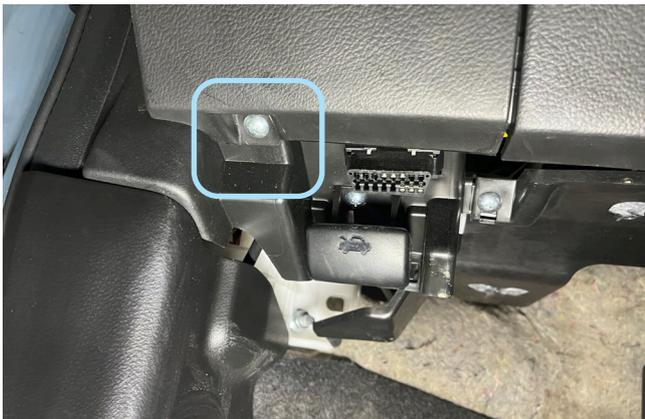
Фото 1.3. Саморез крепления пластиковой накладки
