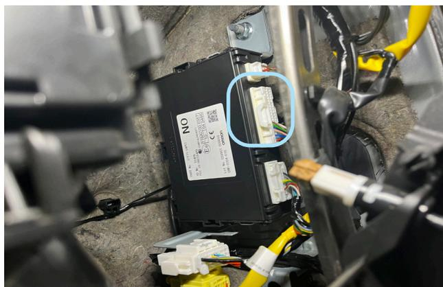
Фото 3.5. Местоположение разъёма блока управления
