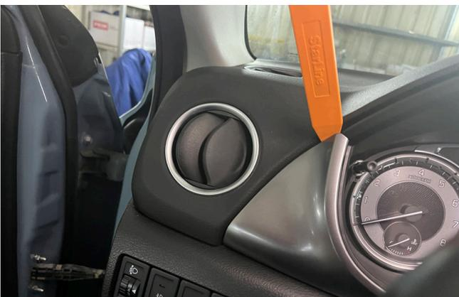
Фото 1.5. Снять декоративную накладку слева от панели приборов
