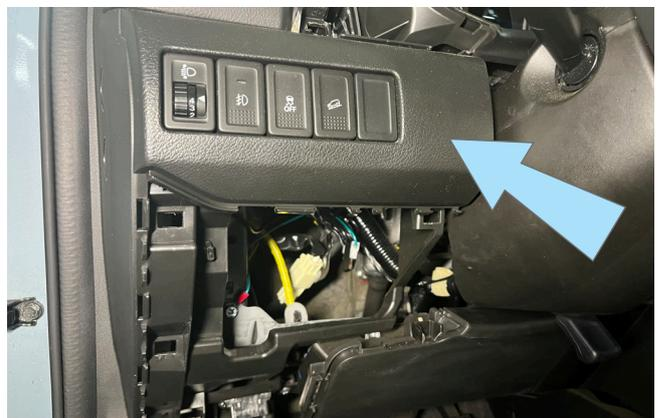
Фото 1.6. Снять блок кнопок
