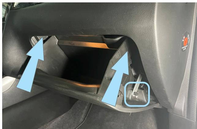
Фото 1.12. Крепления перчаточного ящика
