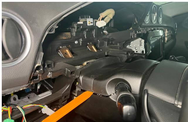
Фото 1.14. Снять нижнюю часть кожуха рулевого вала
