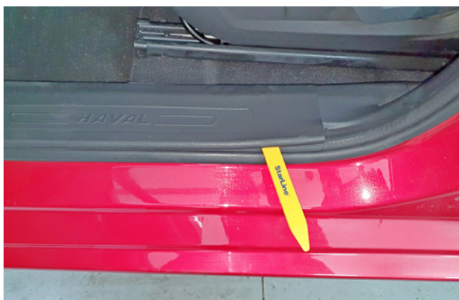
Фото 1.3. Снять накладку порога двери водителя
