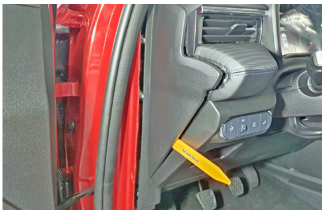
Фото 1.7. Снять боковую накладку передней панели
