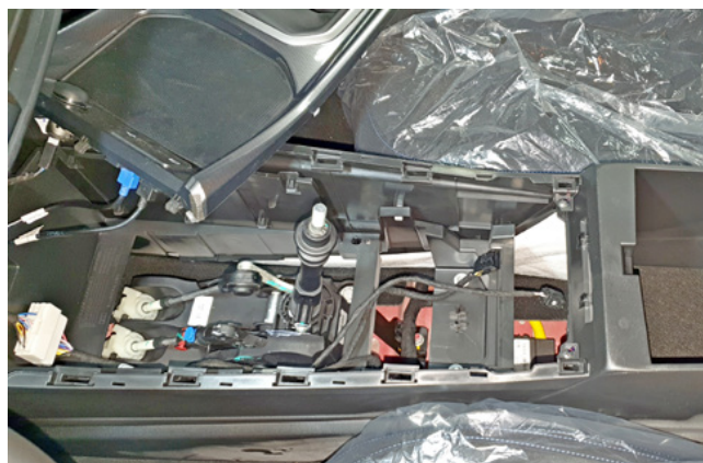
Фото 1.19. Верхняя накладка центрального тоннеля снята
