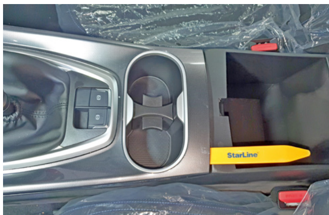
Фото 1.18. Снять верхнюю накладку центрального тоннеля
