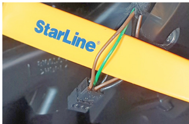
Фото 3.8. Управление кнопкой Старт-Стоп (зелёный и коричневый)
