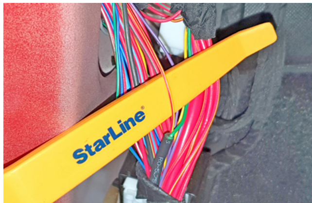
Фото 3.6. Управление центральным замком (жёлто-красный)
