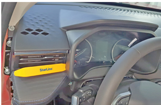
Фото 1.13. Снять декоративную накладку панели приборов
