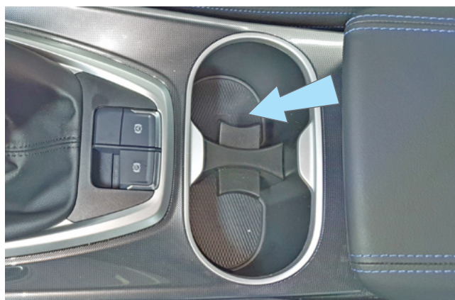
Фото 1.17. Местоположение антенны штатного иммобилайзера
