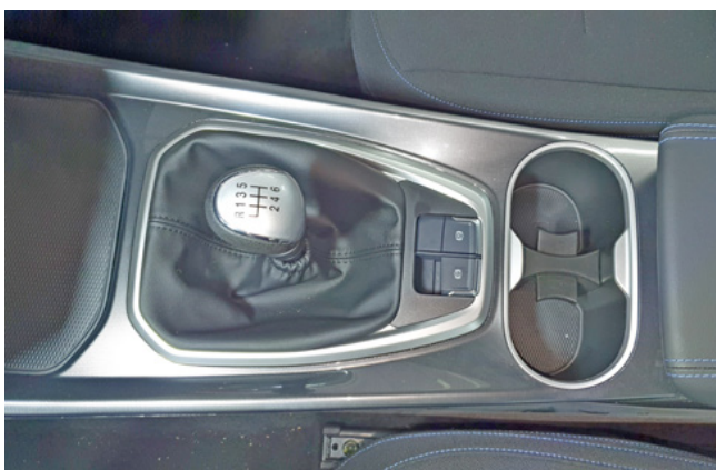
Фото 1.16. Верхняя накладка центрального тоннеля. Общий вид
