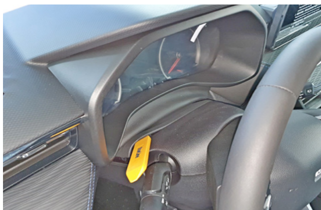
Фото 1.12. Снять пылезащитный кожух рулевой колонки
