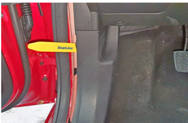
Фото 1.5. Снять накладку левой кик-панели
