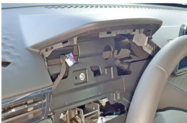
Фото 1.15. Панель приборов снята
