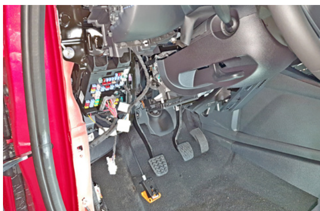
Фото 1.10. Пластиковая накладка под рулевой колонкой снята
