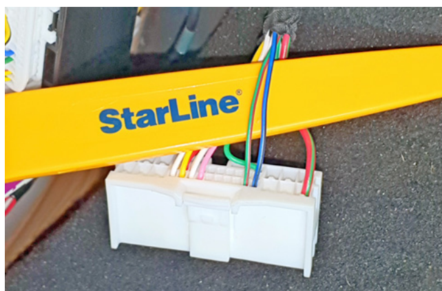
Фото 3.3. Шина CAN-A (зелёно-красный и сине-чёрный)
