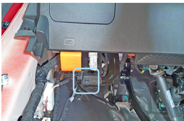
Фото 1.9. Саморез в нижней части накладки
