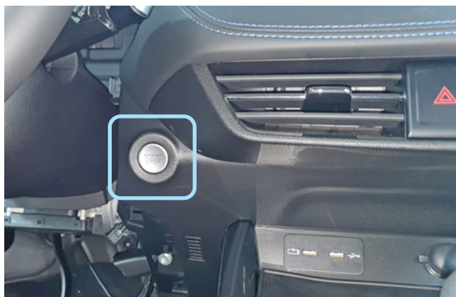
Фото 3.7. Местоположение кнопки Старт-Стоп
