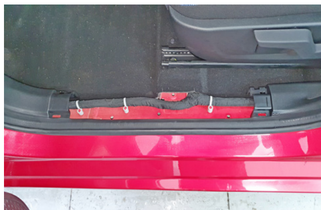
Фото 1.4. Накладка порога двери водителя снята
