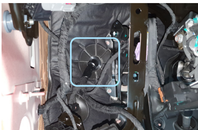
Фото 2.6. Штатный уплотнитель. Вид со стороны салона
