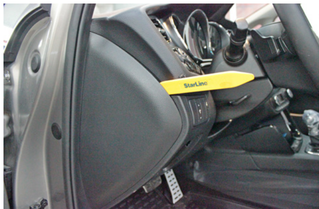
Фото 1.2. Снять левую накладку передней панели
