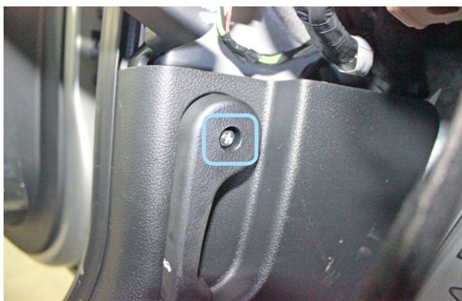
Фото 1.7. Винт крепления ручки отпирания капота
