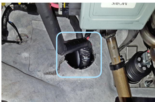
Фото 2.5. Штатный уплотнитель. Вид со стороны салона
