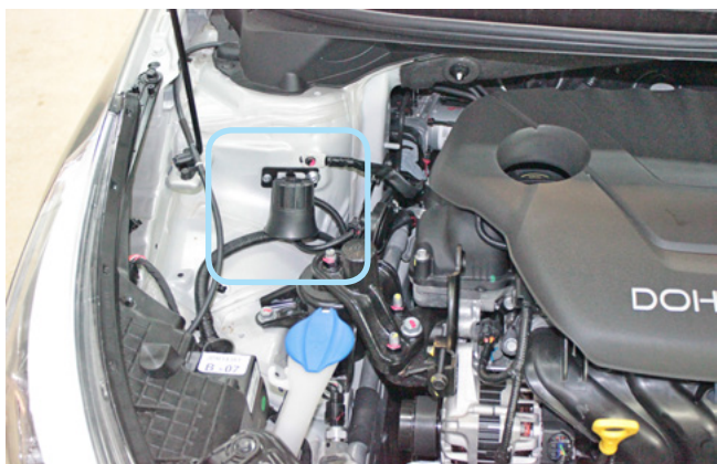
Фото 2.1. Возможное место установки сирены
