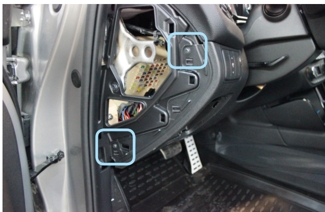
Фото 1.3. Накладка снята. Саморезы
