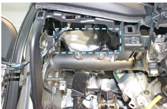
Фото 2.7. Пример расположения центрального блока охранно-телематического комплекса
