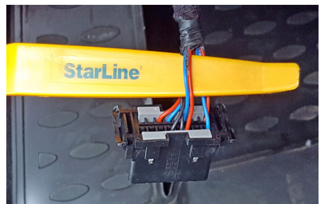
Фото 3.5. Шина CAN-B (красный и синий)
