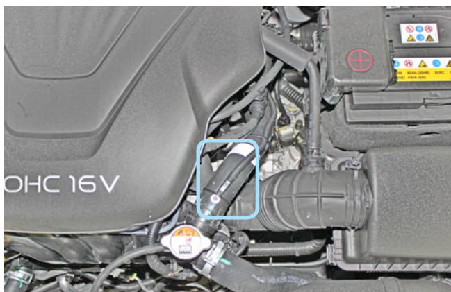
Фото 2.3. Место установки датчика температуры двигателя
