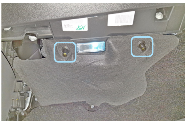
Фото 1.5. Клипы крепления декоративной накладки под блоком ВСМ
