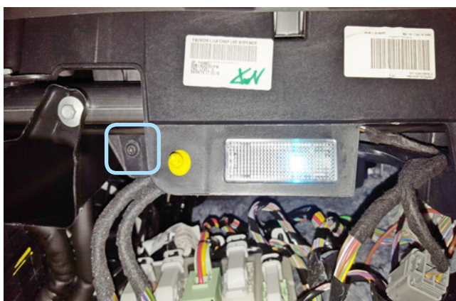
Фото 1.6. Саморез крепления перчаточного ящика слева
