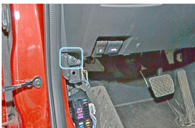
Фото 1.26. Болт крепления накладки под рулевой колонкой
