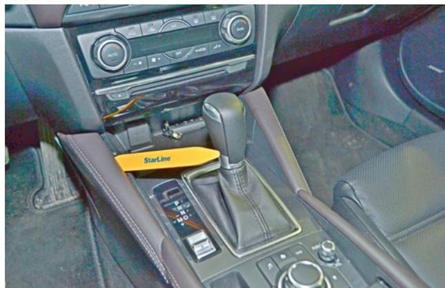
Фото 1.6. Снять накладку слева от рычага коробки передач
