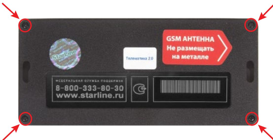
2. Извлечь плату центрального блока. Вынуть установленную и установить другую SIM-карту до упора в направлении, указанном стрелками на рисунке.
