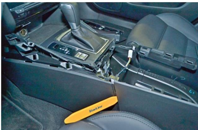
Фото 1.19. Снять заднюю часть центрального тоннеля
