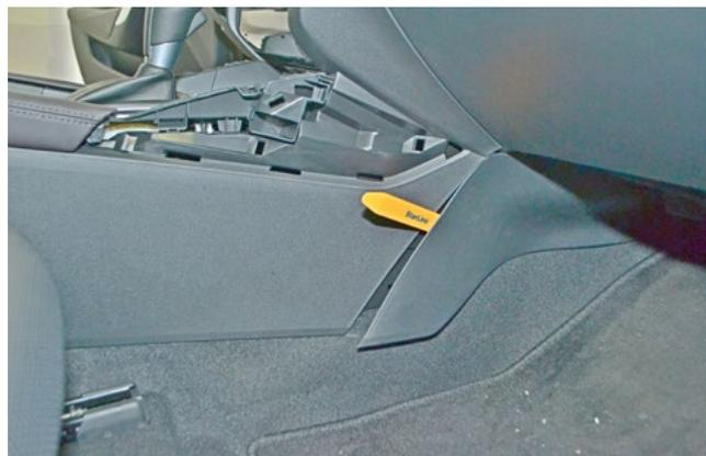
Фото 1.12. Снять нижнюю правую накладку центрального тоннеля
