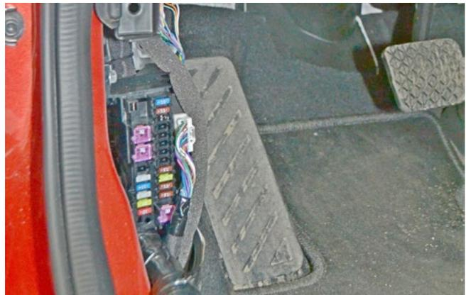
Фото 1.4. Пластиковая накладка левой кик-панели снята
