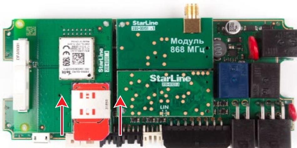
3. Установить плату в корпус и завернуть четыре винта.
