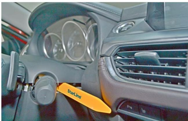
Фото 1.22. Снять верхнюю часть кожуха рулевого вала
