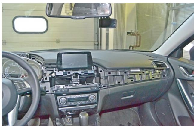
Фото 1.25. Декоративная накладка передней панели снята
