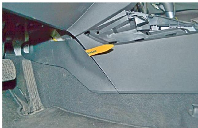
Фото 1.10. Снять нижнюю левую накладку центрального тоннеля
