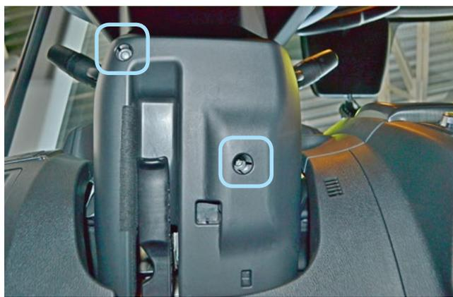
Фото 1.29. Саморезы крепления нижней части кожуха рулевого вала
