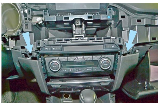
Фото 1.27. Сдвинуть переднюю часть центрального тоннеля
