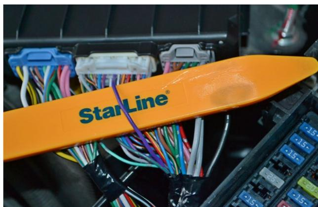
Фото 2.8. Подключение цепи зажигания (фиолетовый)
