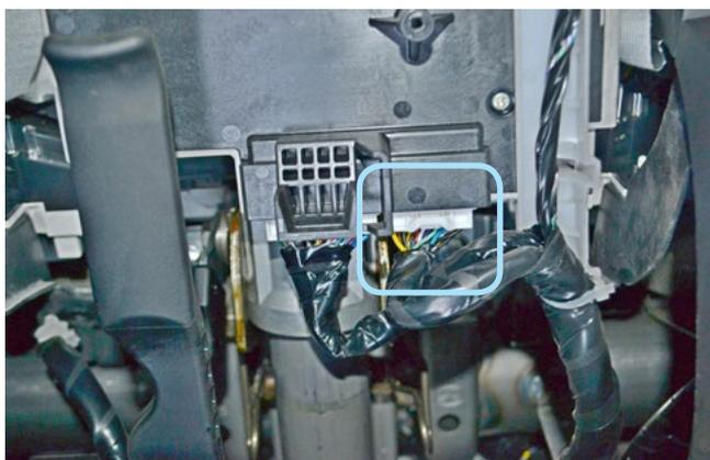
Фото 3.7. Местоположение разъёма
