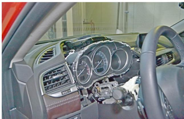
Фото 1.23. Верхняя часть кожуха рулевого вала и накладка панели приборов сняты
