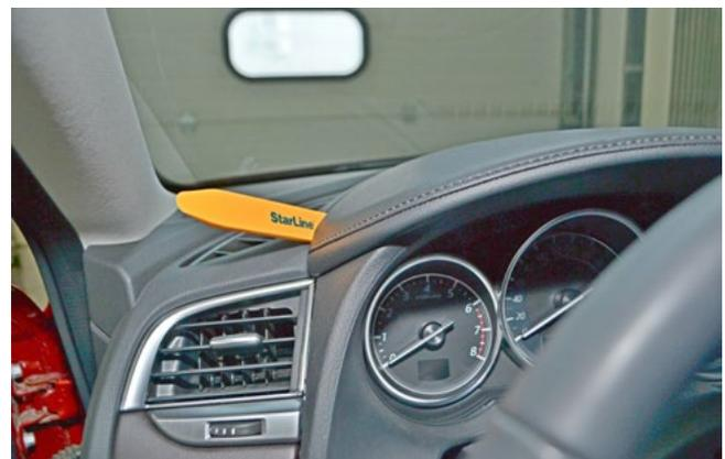
Фото 1.21. Снять декоративную накладку панели приборов
