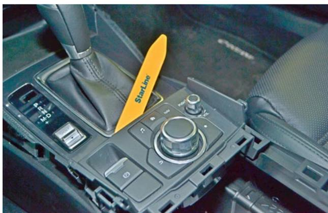
Фото 1.16. Снять блок кнопок
