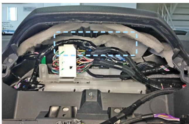
Фото 2.8. Пример расположения центрального блока охранно-телематического комплекса
