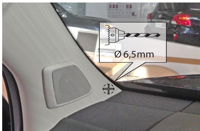
Фото 2.2. Место установки светодиода
