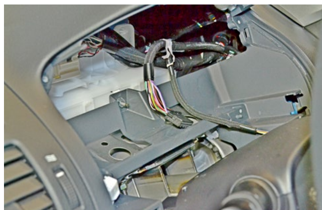
Фото 1.21. Панель приборов снята
