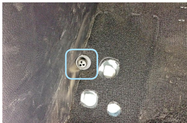
Фото 1.4. Площадка для ноги водителя снята. Клипса крепления накладак левой кик-панели
